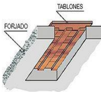
FIGURA 5: MODELO DE ENTABLADO PARA SEGURIDAD
