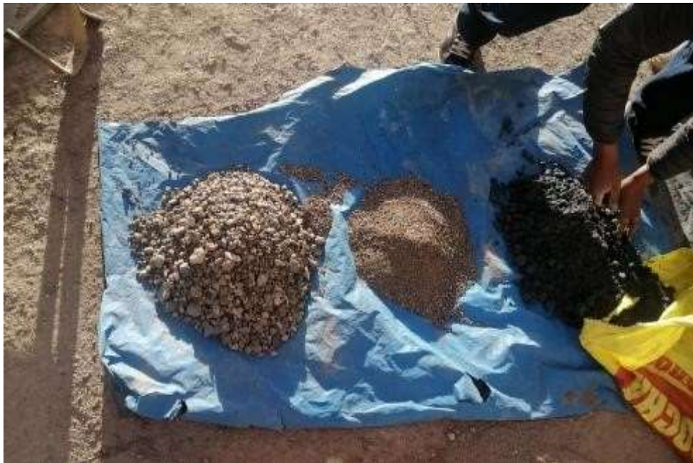
Figura 8. Materiales para fabricación de bloquetas
