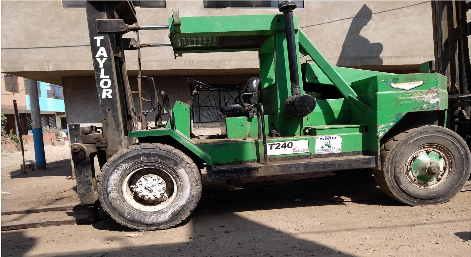
**Figura 6.** Montacargas de 12 toneladas
