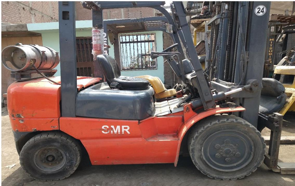
**Figura 5** Montacargas de 6 toneladas
