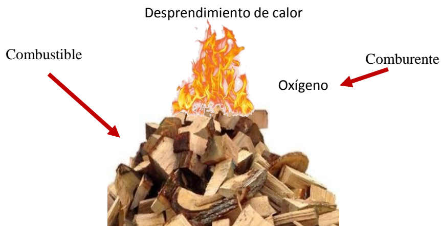
Figura 04: Proceso de combustión
