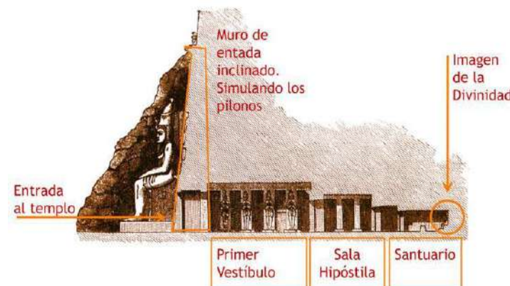
Imagen N°10. Corte Longitudinal del templo Abu Simbel
