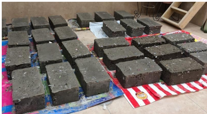
FIGURA N° 8: Fraguado de los ladrillos con residuos plásticos por 24 horas.
