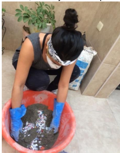
FIGURA N° 6: Mezcla de cemento, arena y residuos plásticos
