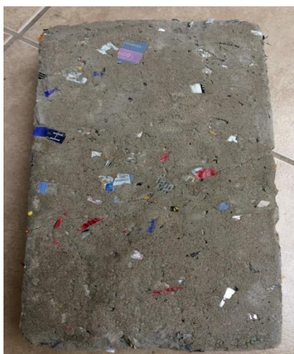
FIGURA N° 7: Ladrillos con residuos plásticos y material agregado
