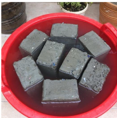
FIGURA N° 9: Curado de los ladrillos con residuos plásticos a 15°C.
