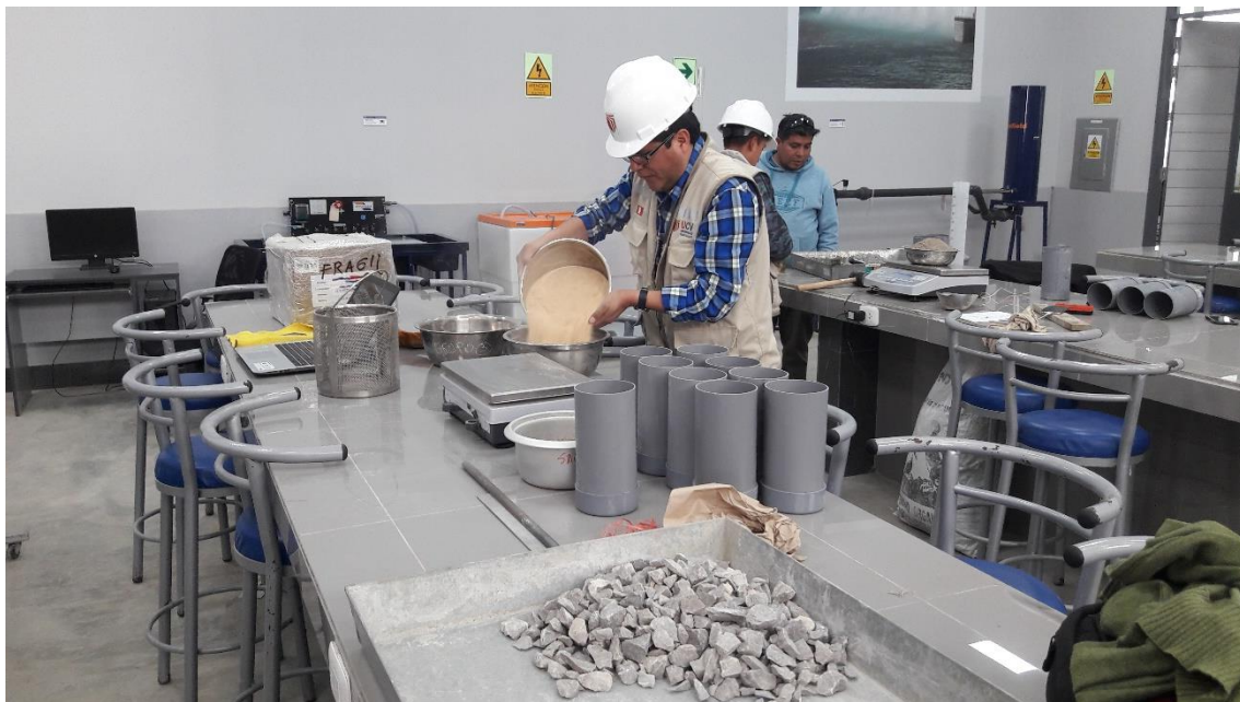
Apreciación de peso de agregado fino para análisis granulométrico.
