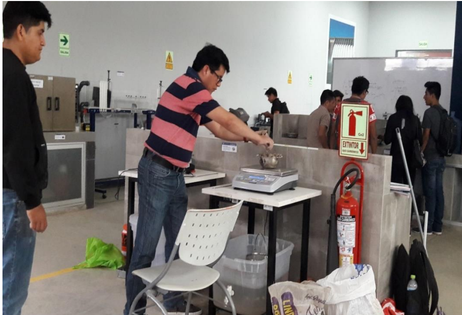
En la toma se aprecia el proceso de peso de material para análisis granulométrico.
