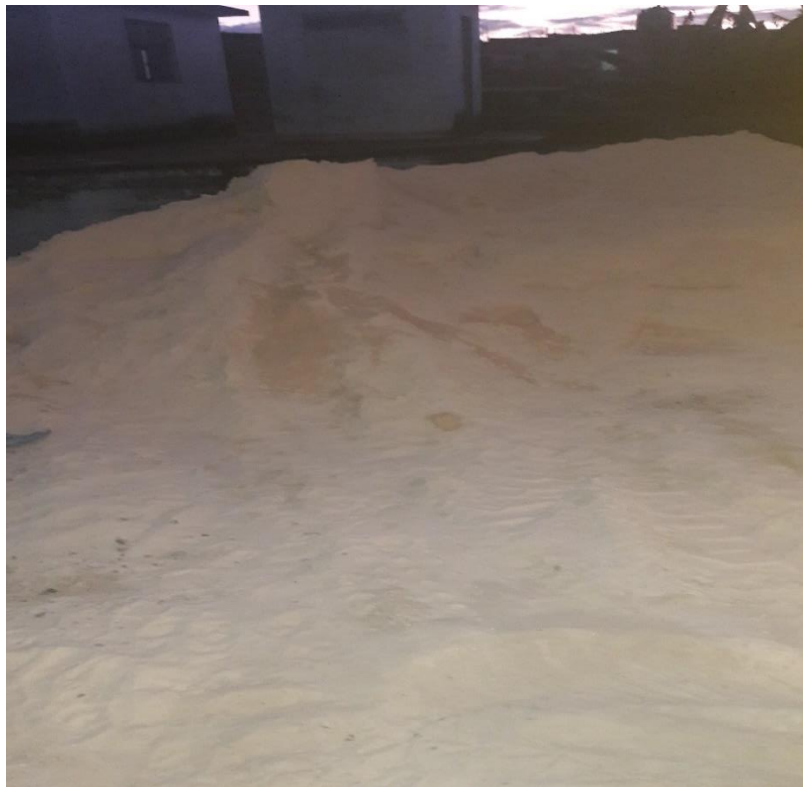
Vista del agregado fino en Conchán para traslado a laboratorio.
