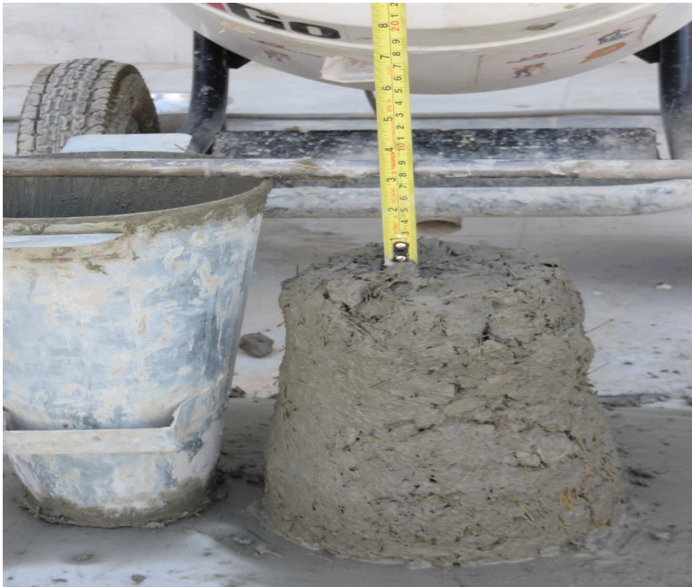
Vista de medida de Slump de la mezcla adicionado Paja de Ichu.
