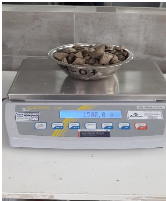
Apreciación del peso del agregado grueso para análisis granulométrico.
