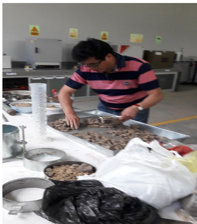
Vista de cuarteo de material en la fuente para ser pesado.
