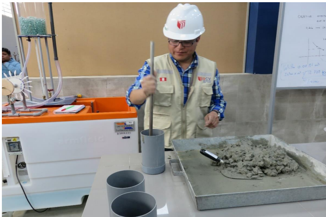
Vista de llenado de probeta y chuseo respectivo.
