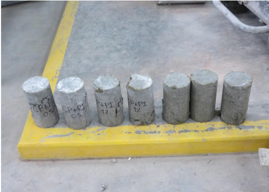
Vista de probetas rotas con Paja de Ichu en porcentajes de 0.5%, 1% y 1.5%
