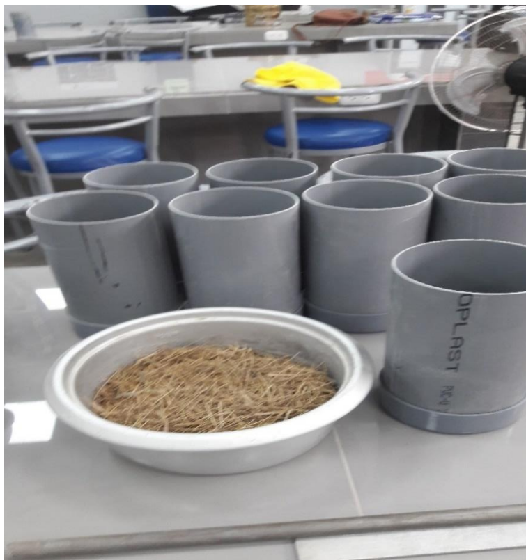
Vista de la Paja de Ichu para ser adicionada a la mezcla de concreto.
