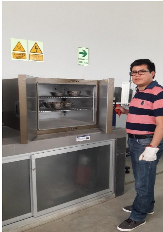
Vista de secado de agregados en horno.
