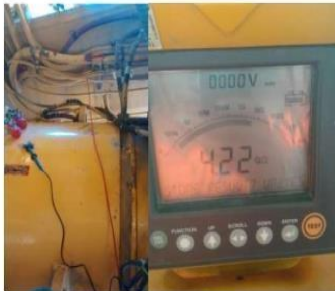
Después de la corrección el megado llega 4.2G ohmios.
