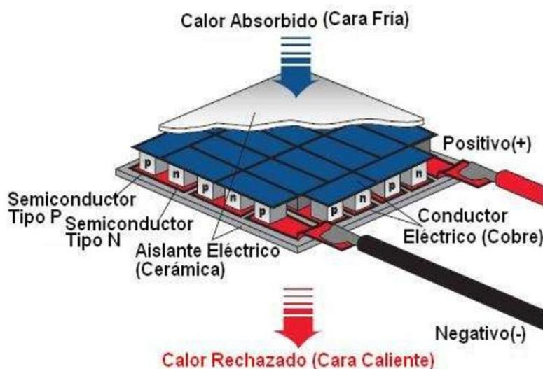
Figura 01. Diagrama de una celda Peltier y su estructura interna.
