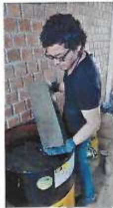
Figura 12. Colocación de viga en el cilindro curador. Fuente: Elaboración propia.
