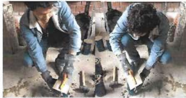
Figura 11. Envasado del concreto. Fuente: Elaboración propia.
