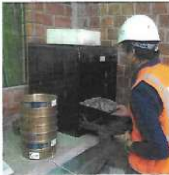
Figura 4. Proceso de secado en horno del material. Fuente: Elaboración propia
