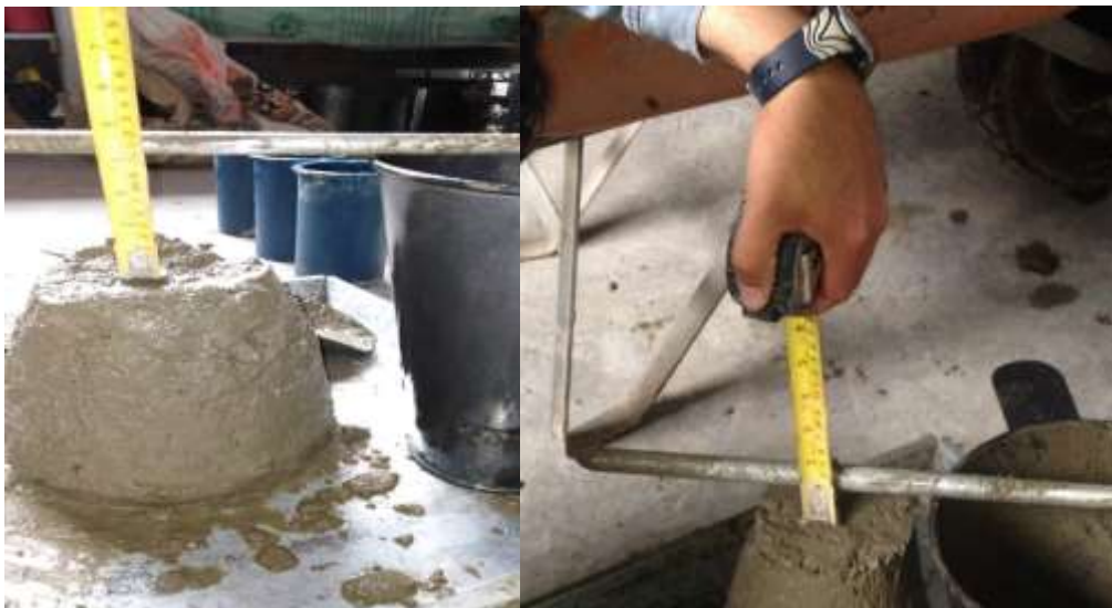
Figura 15 .Comparación de Slump de un concreto sin fibras de acero (izquierda) y otro con 2% de dosificación de fibras de acero (derecha).
