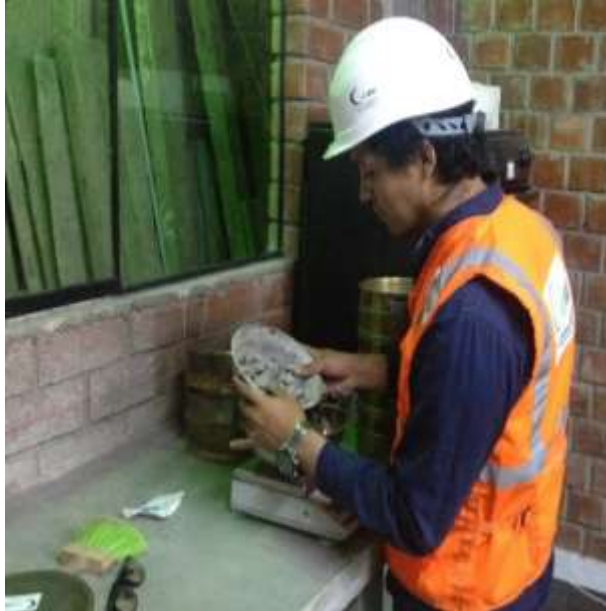
Figura 21. Pesado del material retenido en cada tamiz Fuente: Elaboración propia
