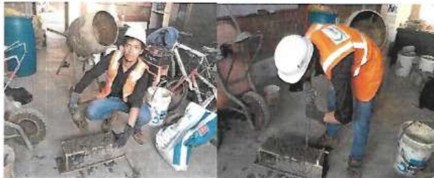
Figura 16. Consolidación del concreto mediante el método de zaponado. Fuente: Elaboración propia.
