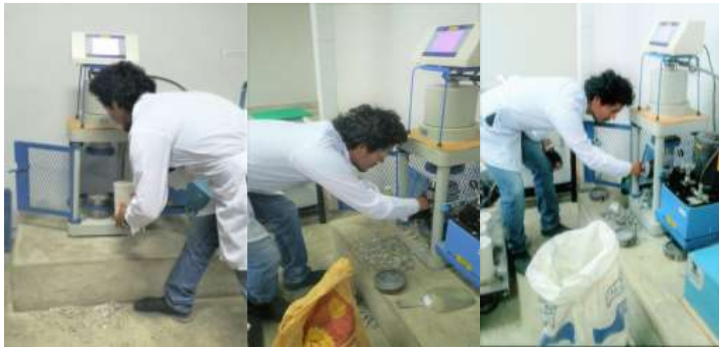
Figura 30. Proceso de ensayo de rotura de probeta
