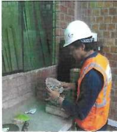
Figura 6. Pesado del material retenido en cada tamiz. Fuente: Elaboración propia.
