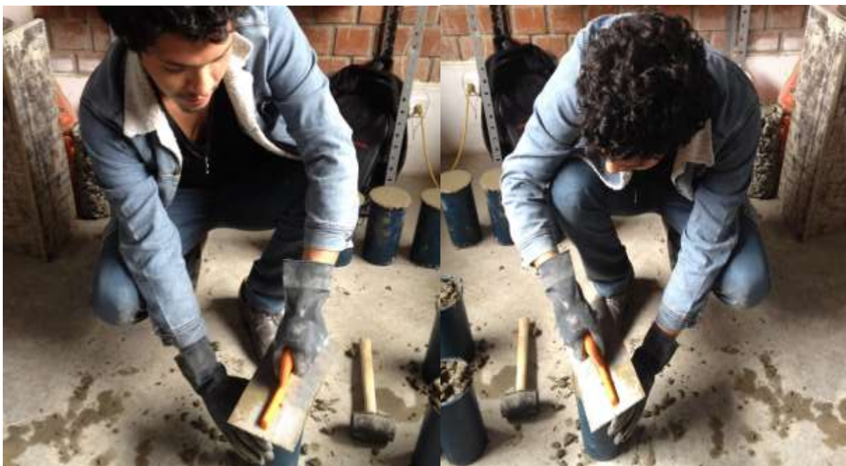
Figura 28. Enrasado del concreto
