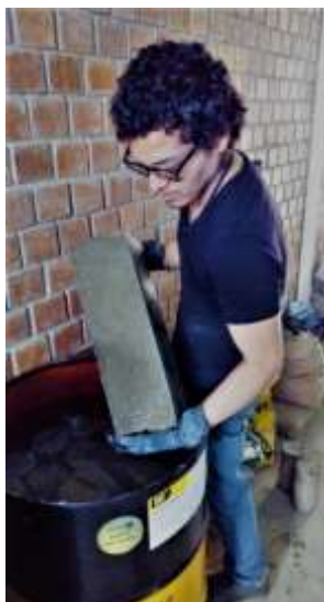
Figura 45. Colocación de viga en el cilindro curador
