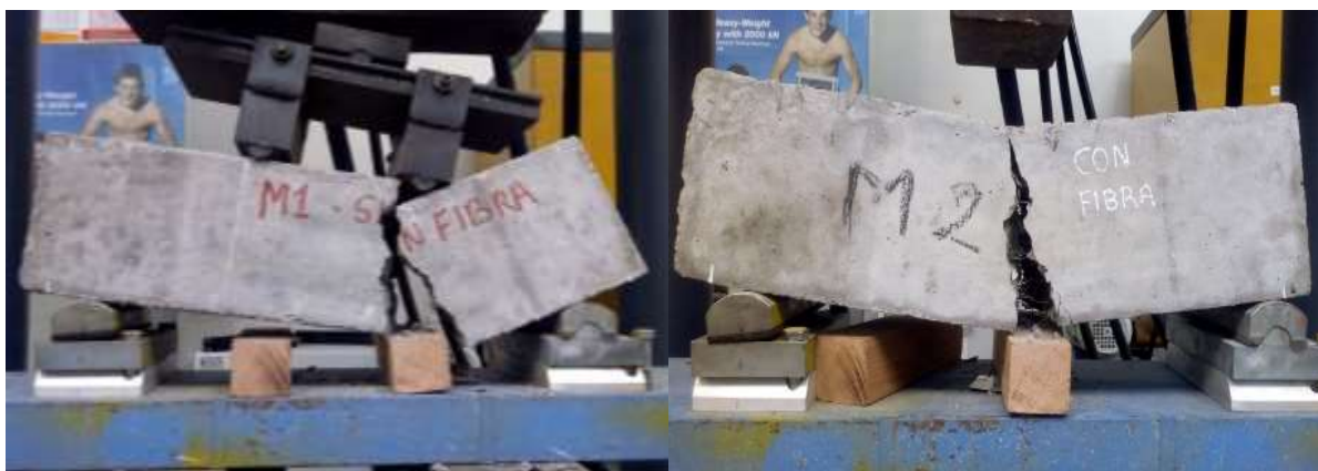
Figura 46. Prueba de resistencia a la flexión muestra sin fibras de acero (izquierda) muestra con fibras de acero 2% de dosificación de respecto al volumen del concreto (derecho)
