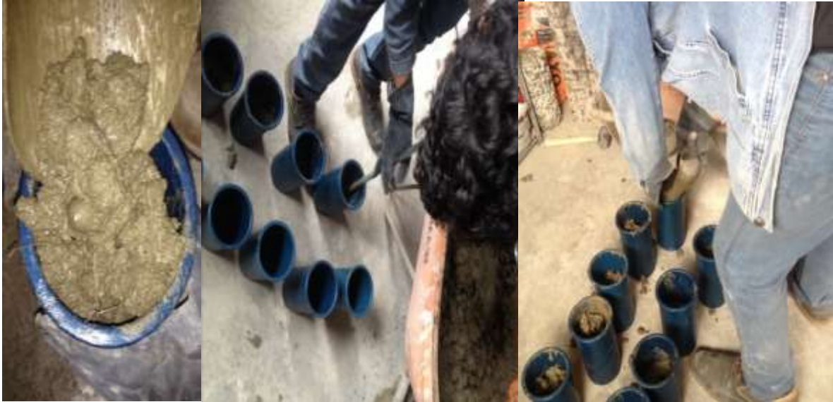
Figura 27. Consolidación del concreto mediante el método de apisonado
