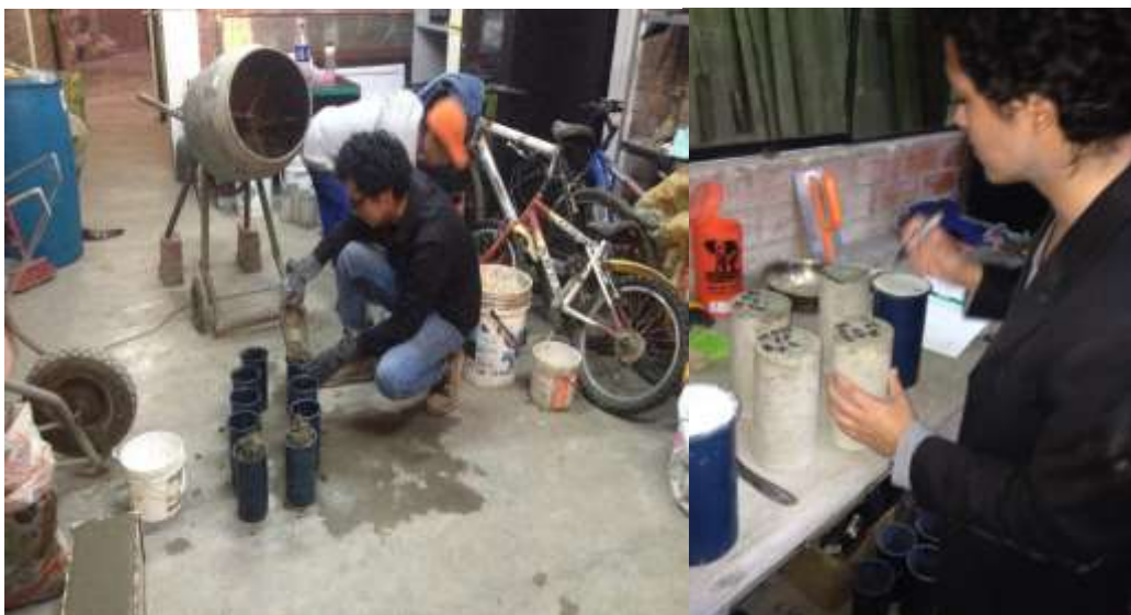
Figura 26. Moldes plásticos utilizados y probetas de concreto compactado Fuente: Elaboración propia.
