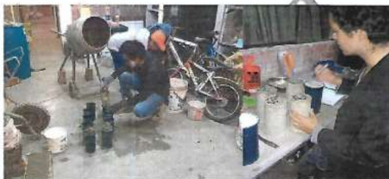
Figura 9. Moldes plásticos utilizados y probetas de concreto compactado. Fuente: Elaboración propia.
