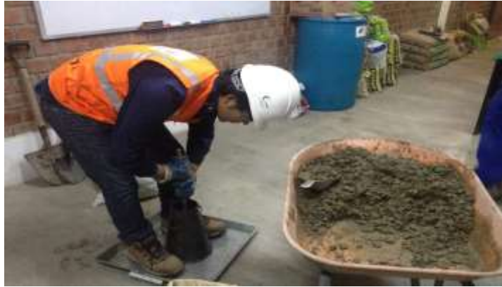
Figura 14. Obtención de trabajabilidad mediante el cono de Abrams, de una mezcla sin fibras de acero
