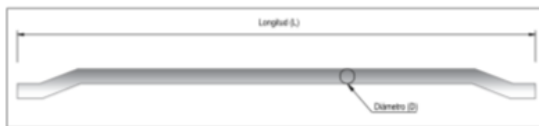
Figura 7. Sección típica de una fibra de acero.
