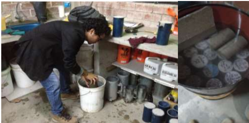
Figura 29. Proceso de curado de probetas
