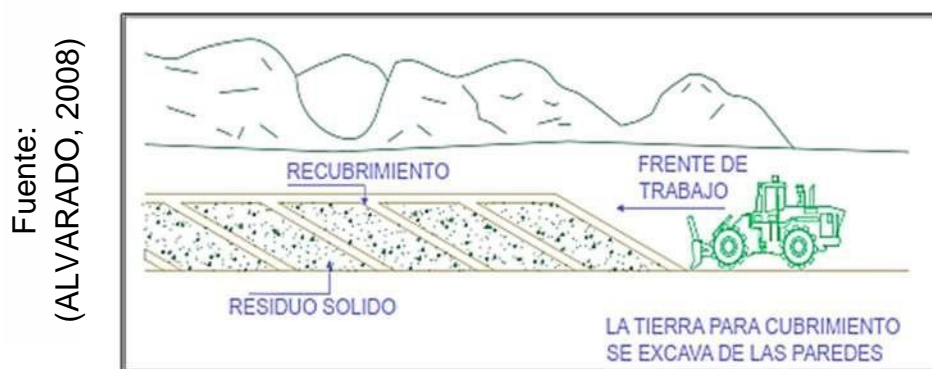
Relleno tipo zanja
