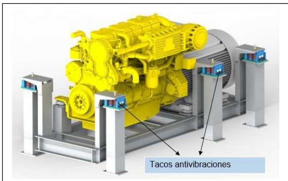
Soportes antivibratorios para el grupo electrógeno
