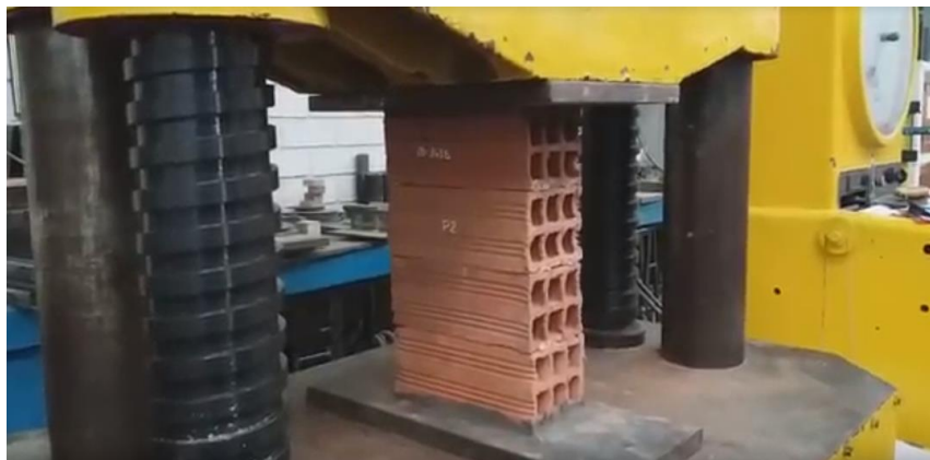
Figura 44: Pila N° 2 lista para ensayo. Fuente: Material propio.
