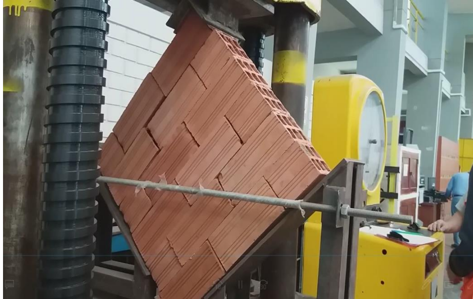
Figura 53 : Falla en murete N°2. Fuente: Material propio.
