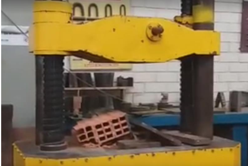
Figura 43: Colapso total de pila debido a falla lateral. Fuente. Material propio.
