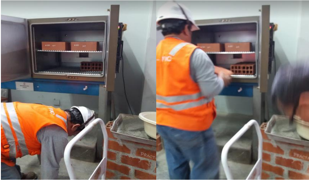
Figura 35: Colocación al horno de ladrillos pandereta para su secado. Fuente: Material propio.
