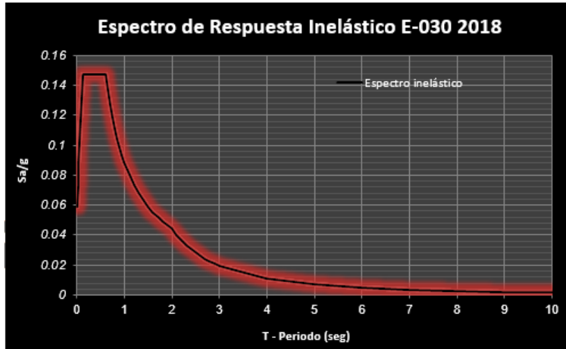
Figura 57: Espectro de respuesta Inelástico. Fuente: Elaboración propia
