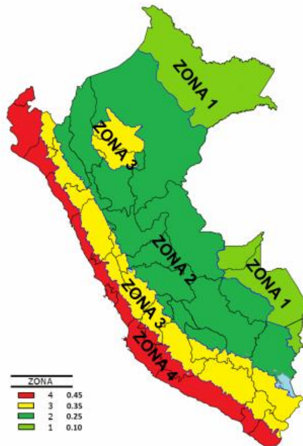
Figura 17: Zonas sísmicas en el Perú Fuente: www.vivienda.gob.pe
