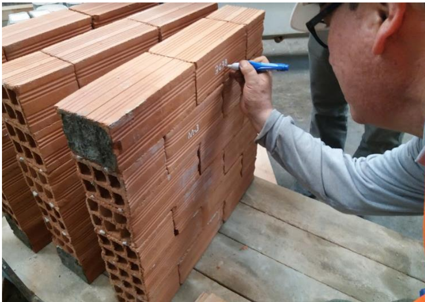
Figura 48: Enumeración de muretes a realizar ensayo de compresión diagonal. Fuente: Material propio.
