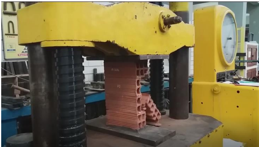
Figura 45: Falla de pila N°2. Fuente: Material propio.
