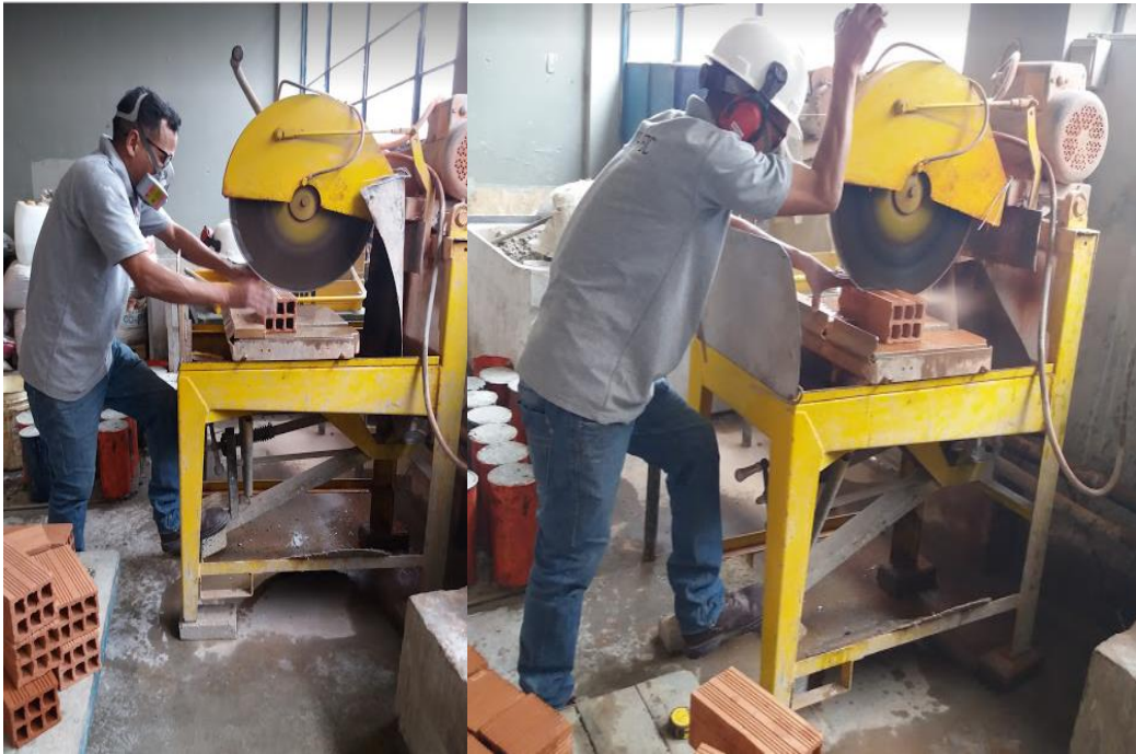
Figura 34: Corte de ladrillos. Fuente: Material propio.
