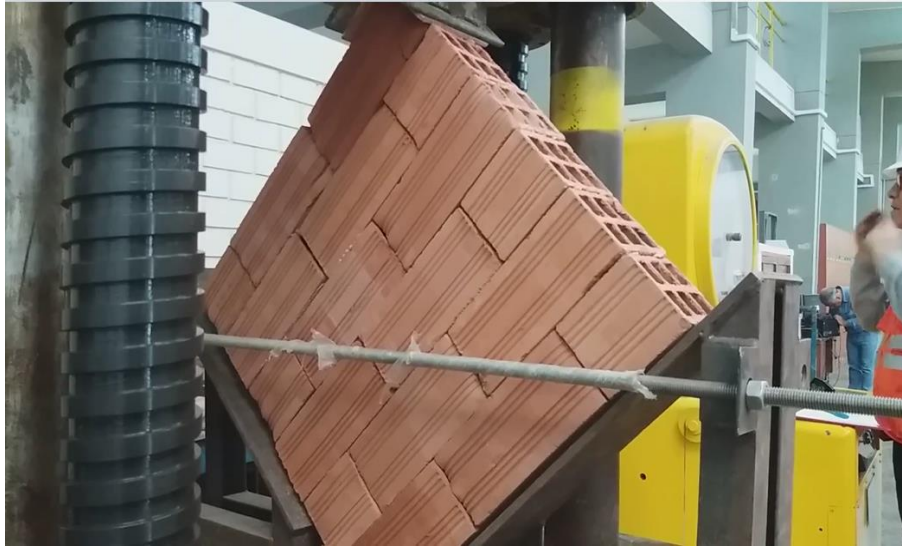
Figura 50: Abrazaderas de protección y falla en parte superior de murete. Fuente: Material propio.
