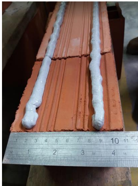
Figura 36: Aplicación de la masa Dun Dun. Fuente: Material propio.
