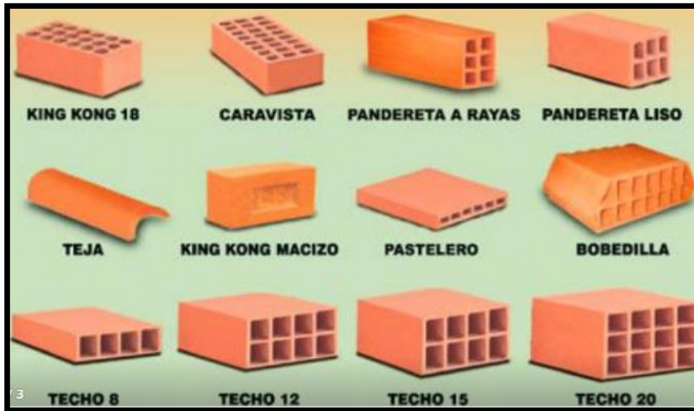
Figura 12: Tipos de ladrillo. Fuente: MAESTRO
