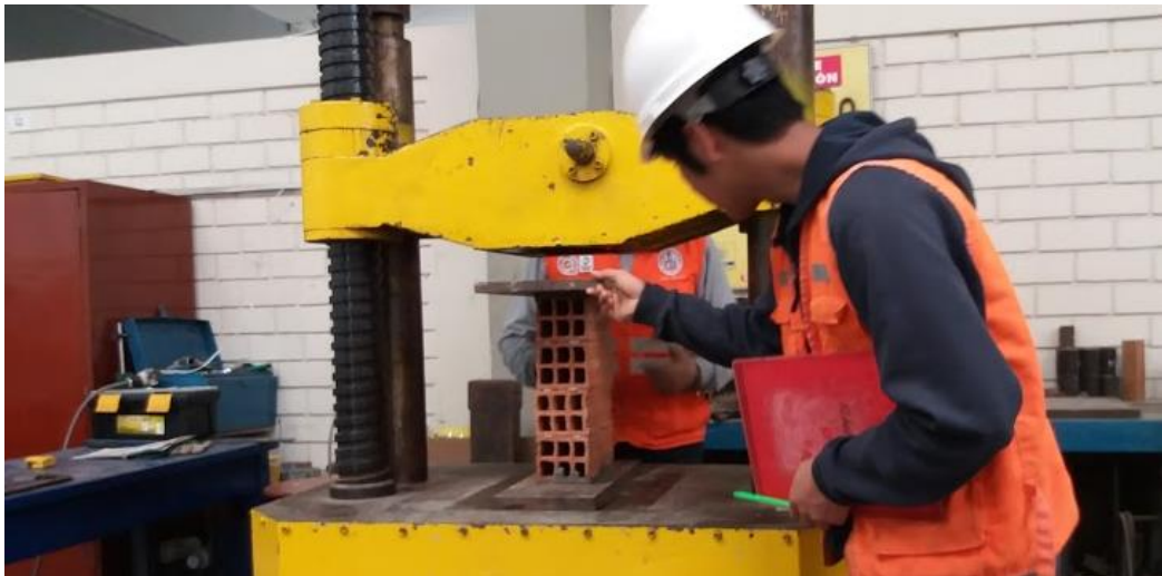
Figura 40: Colocación de pila en máquina de ensayo uniaxial. Fuente: Material propio.
