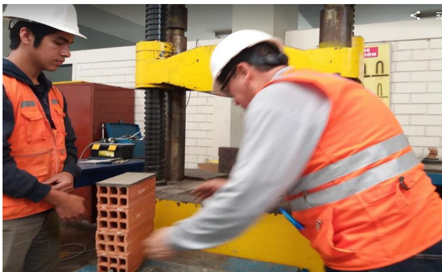
Figura 39: Pila lista para el ensayo de resistencia a la compresión. Fuente: Material propio.
