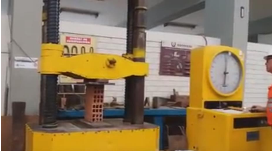
Figura 41: Ensayo de resistencia a la compresión, UNI. Fuente: Material propio.
