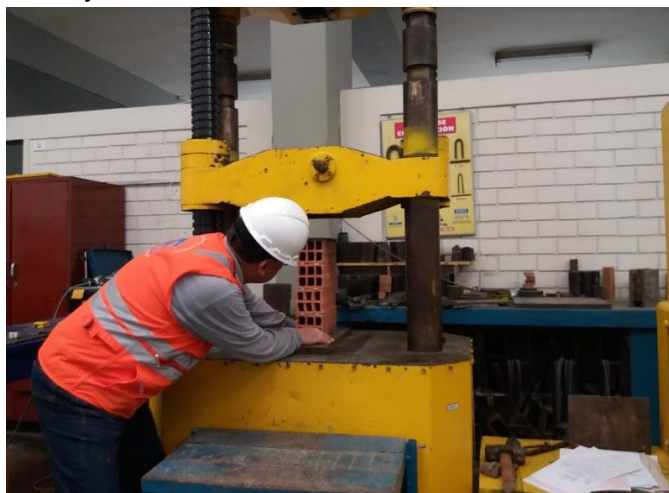
Figura 18: Colocación de pila de ladrillos para ensayo de resistencia de compresión en pilas.
