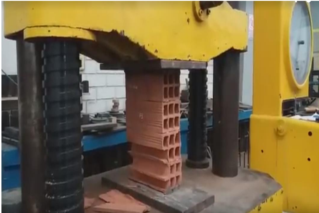
Figura 46: Falla de pila N° 3 Fuente: Material propio.
