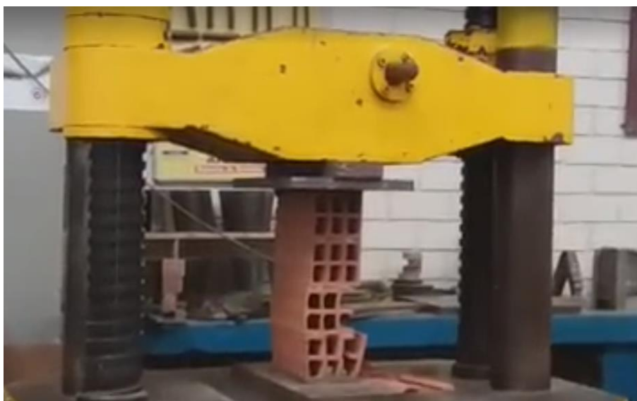
Figura 42: Apreciación de falla en pila. Fuente: Material propio.
