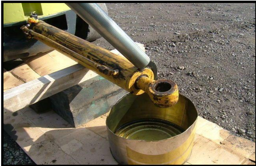
Rotura de los Cilindros de la Retroexcavadora
