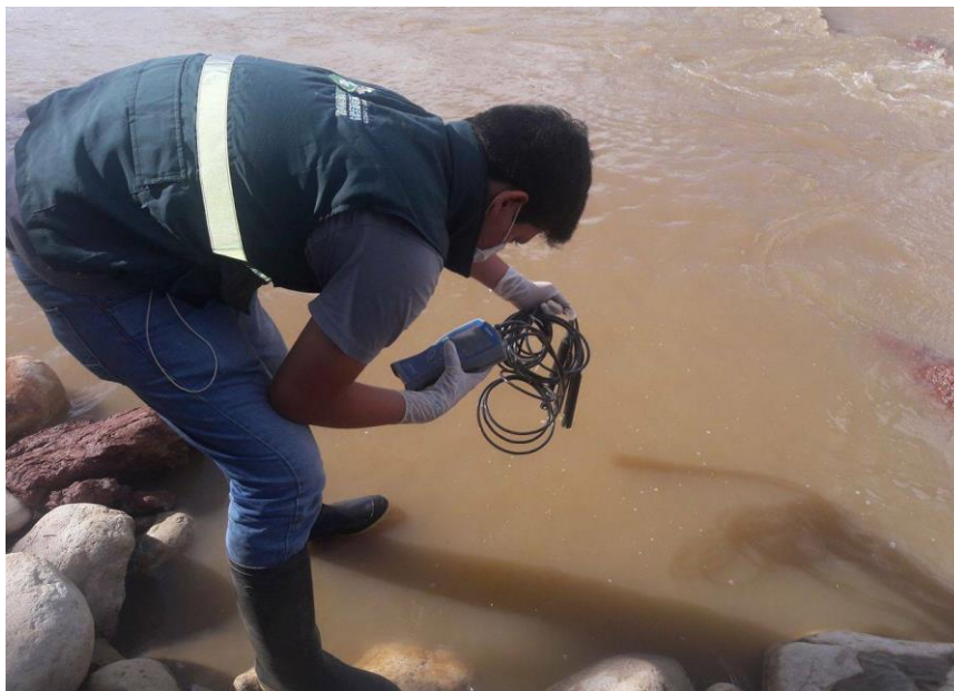
Figura 42. Realizando la medición de parámetros de campo con ayuda del equipo multiparámetro marca PONSEL modelo ODEON
