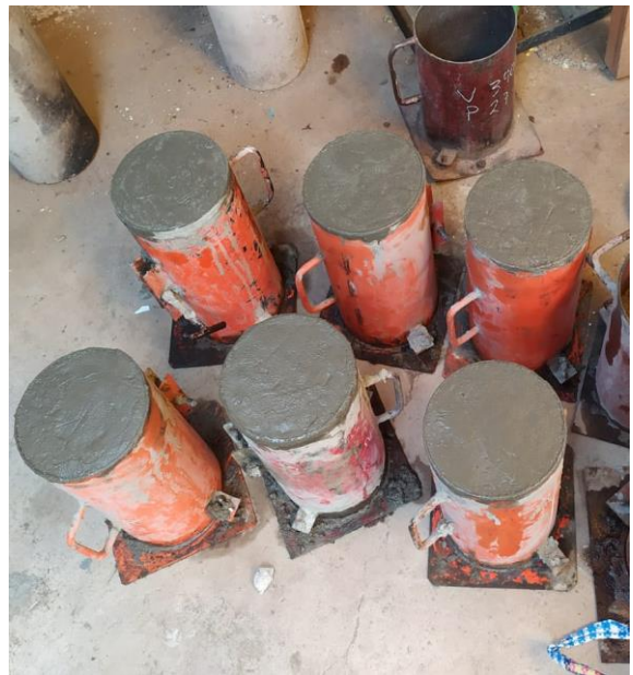
Figura N° 19: Elaboracion de las probetas cilindricas
