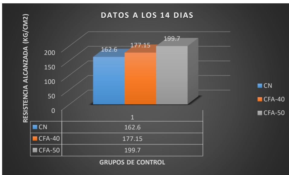
Figura N° 43: Comparación de la resistencia a la compresión entre CN, CFA-40 y CFA-50 a los 14 días.
