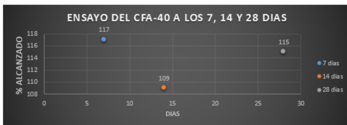
Figura N° 28: Ensayo del CFA-40 a los 7, 14 y 28 días
