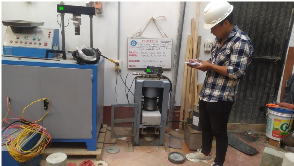
Figura N° 31: Ensayo de flexion con 0kg/m3, 40kg/m3 y 50kg/m3.
