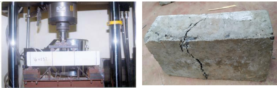
Figura N° 33: Ensayo de fatiga y la falla del espécimen
