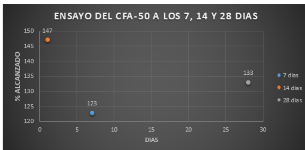
Figura N° 29: Ensayo del CFA-50 a los 7, 14 y 28 días
