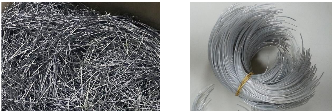
Figura N° 10: Obtencion de la fibra de acero de 60mm de longitud
