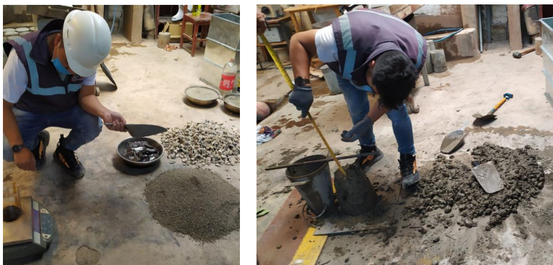
Figura N° 18: Dosificación de materiales por peso y la determinación del Slump
