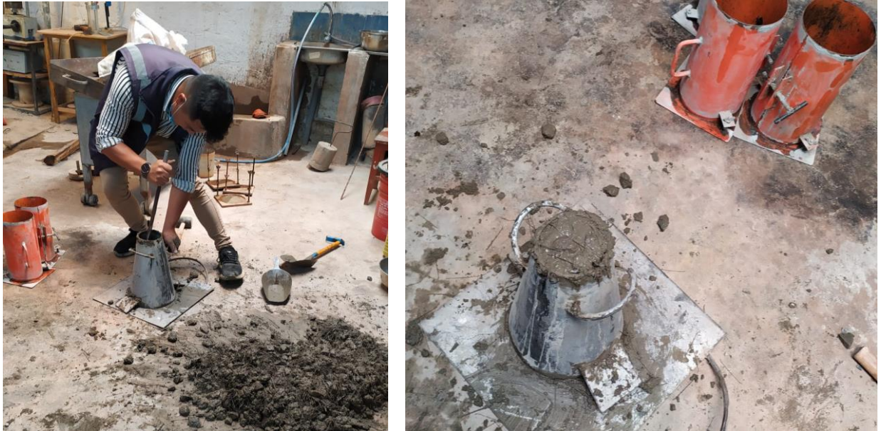
Figura N° 24: Ensayo de asentamiento de 3" a 4"
