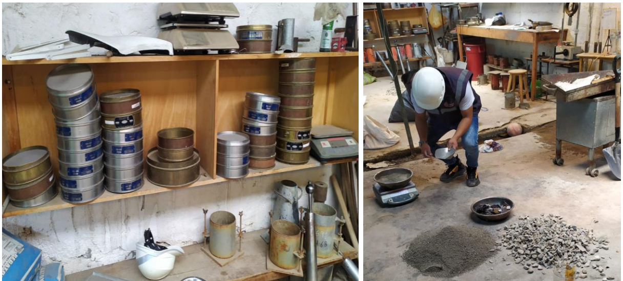
Figura N° 15: Equipos para el ensayo de granulometria y el proceso de separacion del agregado grueso y fino.
