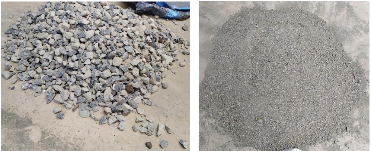
Figura N° 14: Muestras para el ensayo de peso unitario tanto suelto como compacto de la piedra chancada y arena gruesa.
