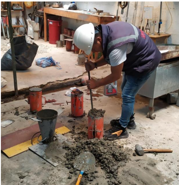
Figura N° 19: Elaboracion de las probetas cilindricas
