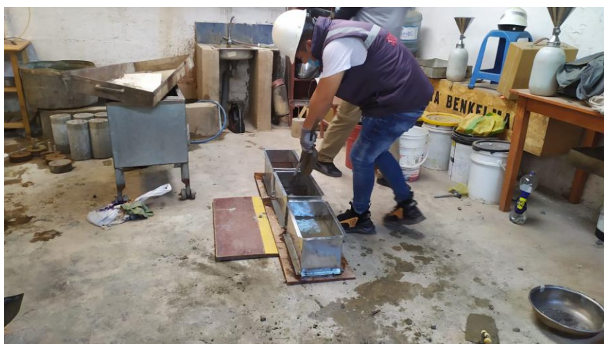
Figura N° 21: Elaboracion de las vigas para los ensayos de flexion y fatiga
