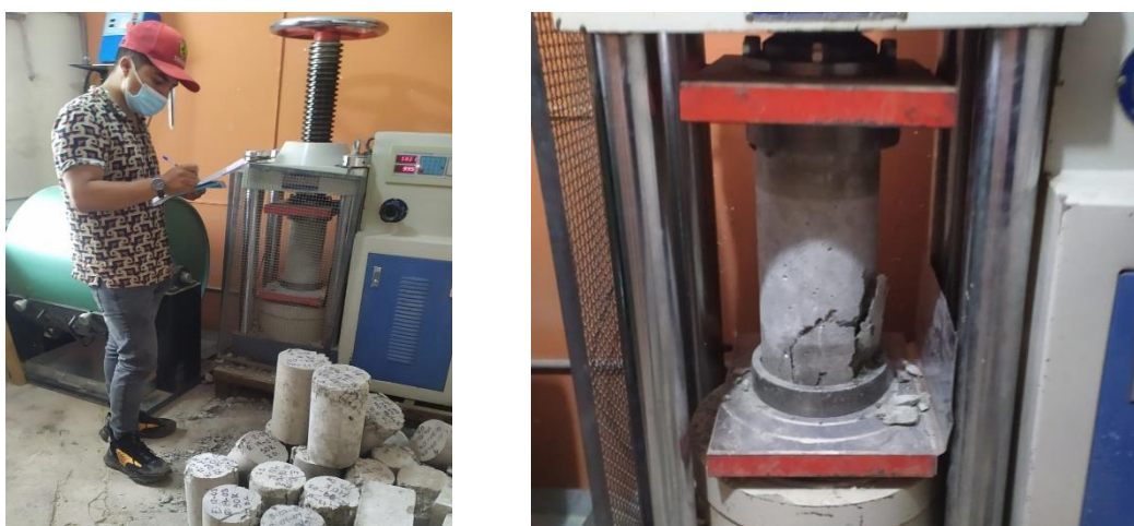
Figura N° 26: Ensayo de esfuerzos por compresion de especimenes
