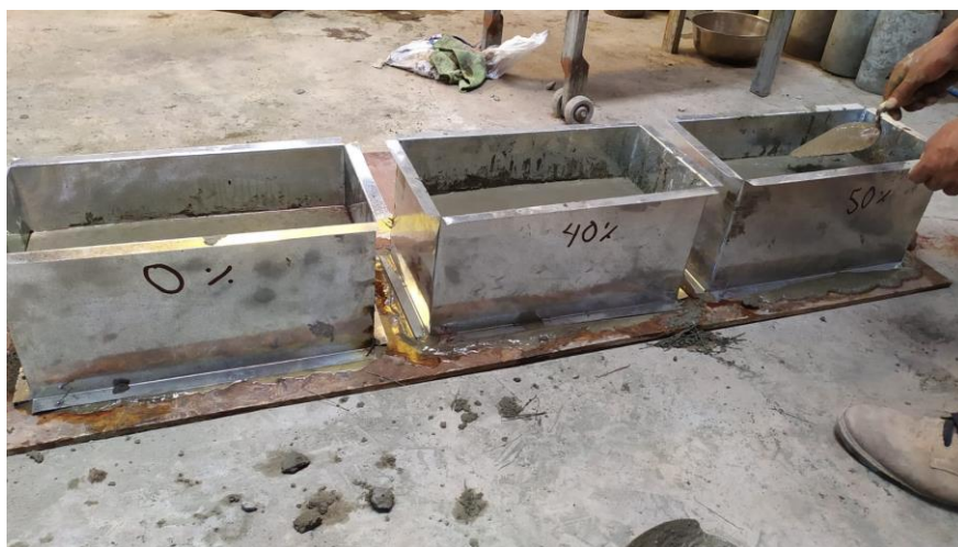
Figura N° 20: Elaboracion de las vigas para 0kg/m 3 , 40kg/m 3 y 50kg/m 3
