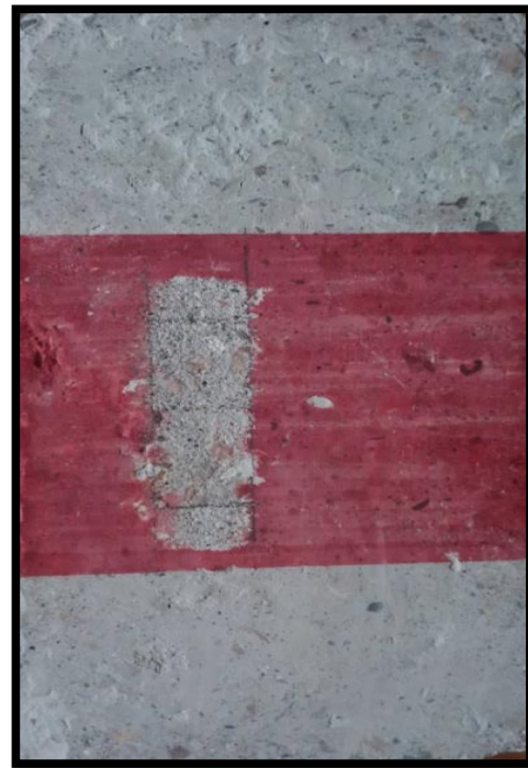
Figura N° 40: Ensayo de abrasión por desgaste por NTG 41087
