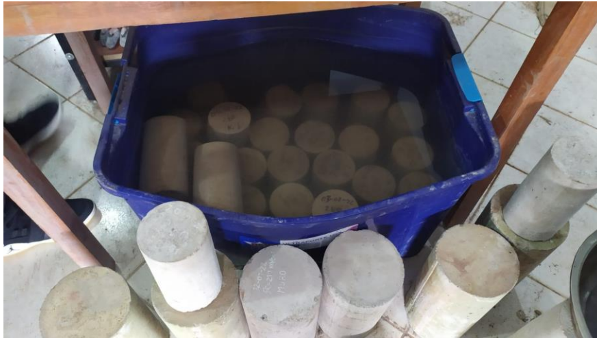
Figura N° 22: Proceso de curado de especímenes de prueba
