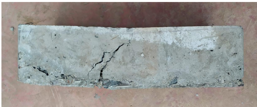
Figura N° 32: Falla de la viga a flexión
