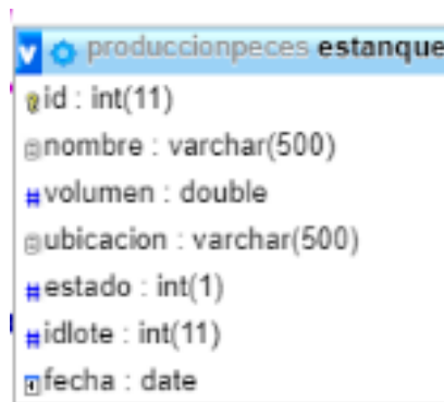
Figura 38. Modelamiento de datos estanque.
