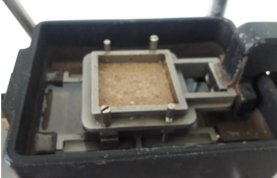
Foto 13: Ensayo de corte directo.
