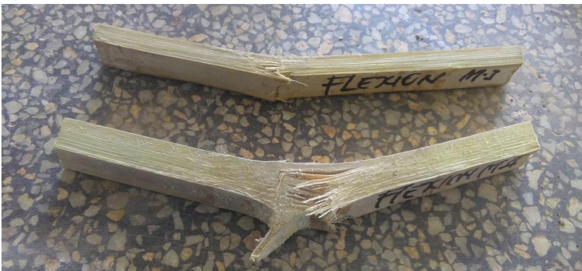
Foto 22: Propiedad mecánica, resultado del ensayo de flexión.
