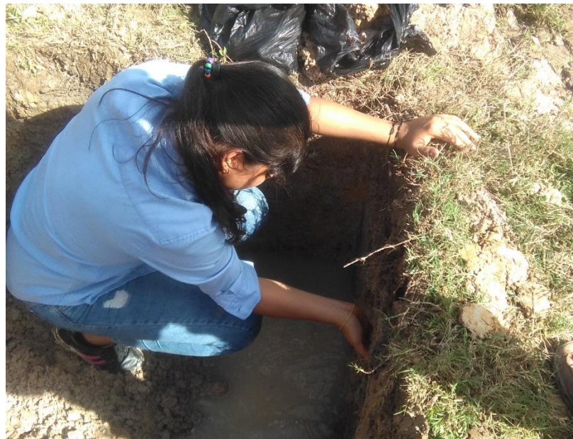
Foto 6: Toma de muestras para estudio mecánico de suelos.
