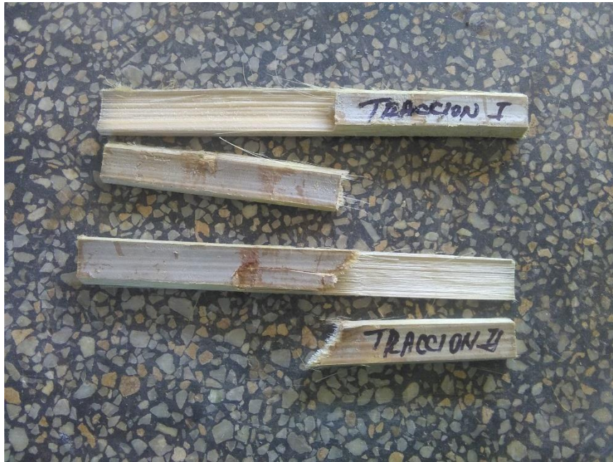
Foto 23: Propiedad mecánica, resultado del ensayo de tracción.
