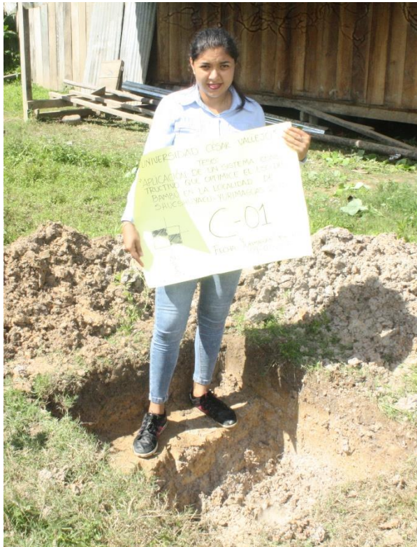
Foto 3: Ejecución de calicata C-01.
