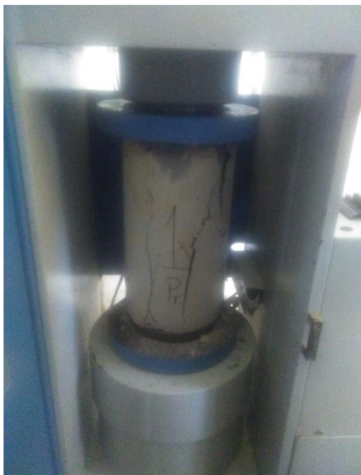
Foto 15: Rotura de testigos de mortero f'c= 210 \text{ kg/cm}^2 .
