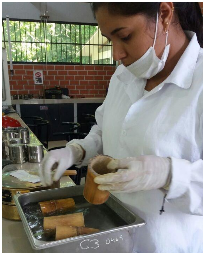
Foto 20: Propiedad física, ensayo de contenido de humedad.
