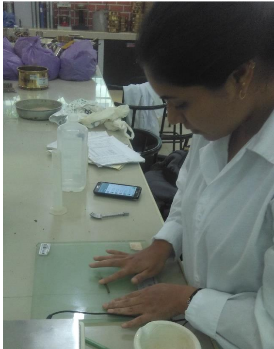
Foto 9: Realización de los límites de Atterberg (límite plástico).
