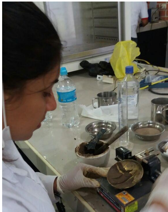
Foto 8: Ejecución de los límites de Atterberg (límite líquido).
