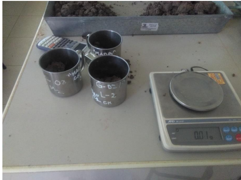
Foto 7: Realización del ensayo de contenido de humedad del suelo.
