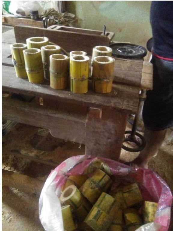
Foto 18: Muestras con nudo y sin nudo del bambú Bambusa Vulgaris, para el ensayo de compresión.
