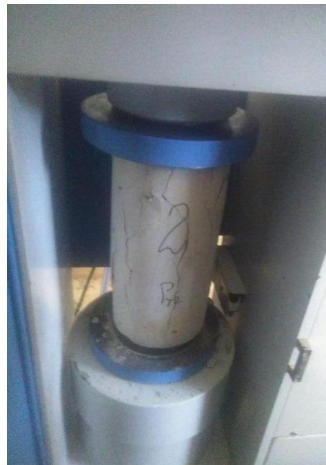
Foto 15: Rotura de testigos de mortero f'c= 210 \text{ kg/cm}^2 .
