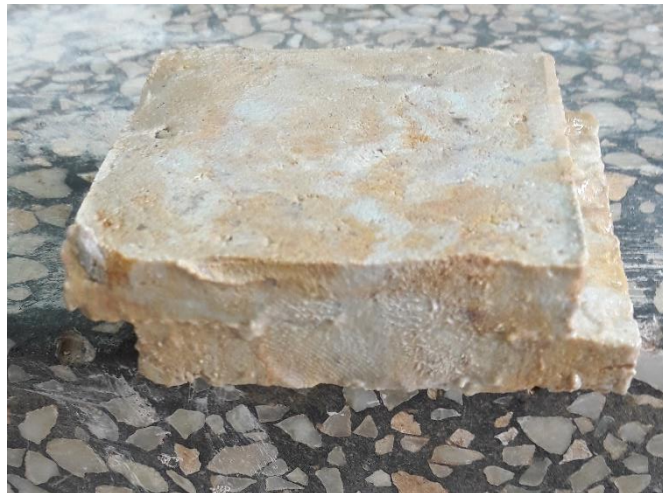
Foto 14: Muestra que paso el ensayo de corte directo.
