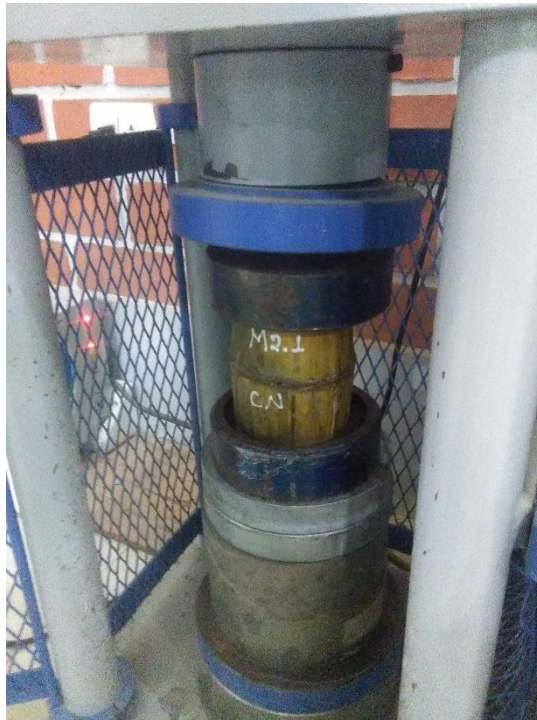
Foto 25: Propiedad mecánica, ensayo de compresión, sometido a carga.
