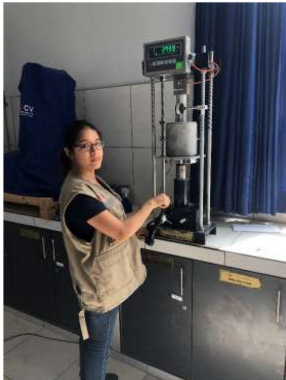
**FOTO N°12: Ensayo de CBR**
