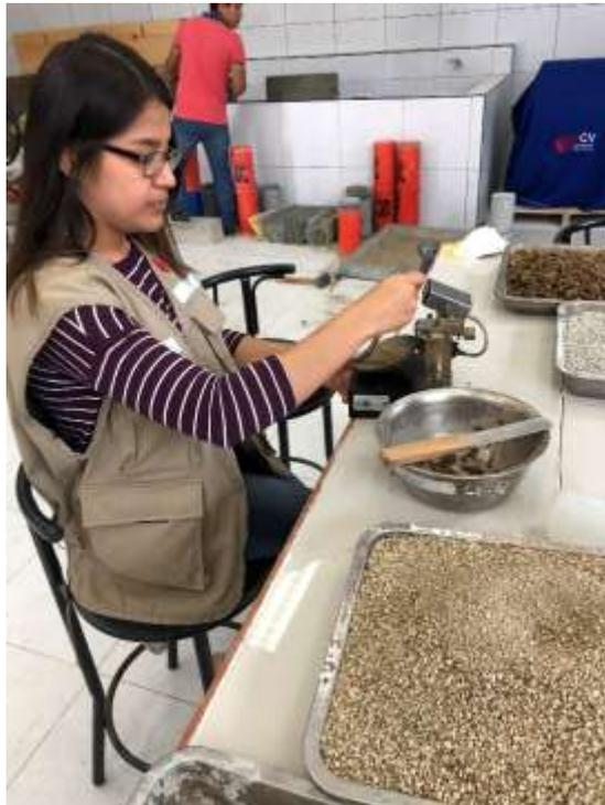
**FOTO N°9:** Ensayo de Casagrande para Límites de Atterberg
