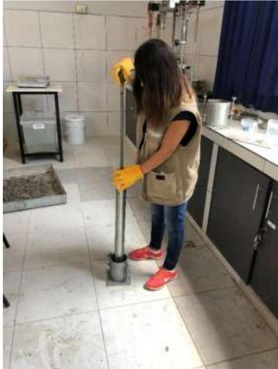
**FOTO N°11: Ensayo de Proctor Modificado**
