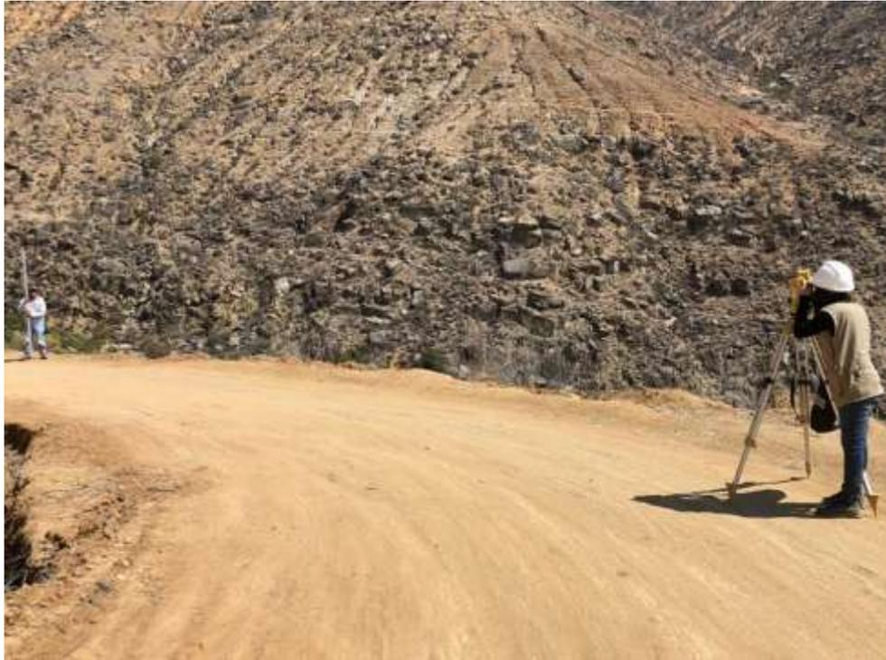
**FOTO N°12:** Equipo de estación total instalada para la toma de datos
