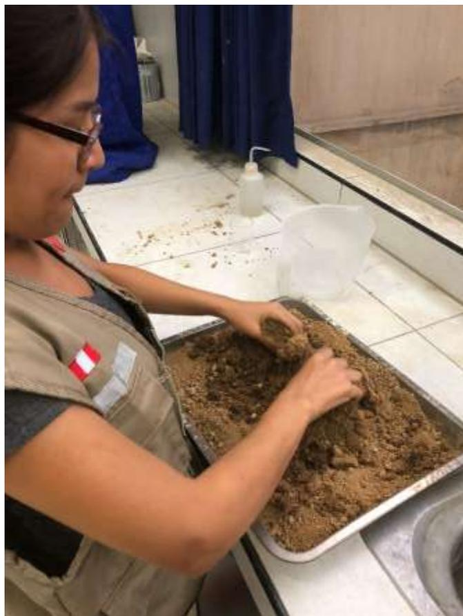
**FOTO N°10:** Ensayo de Proctor Modificado
