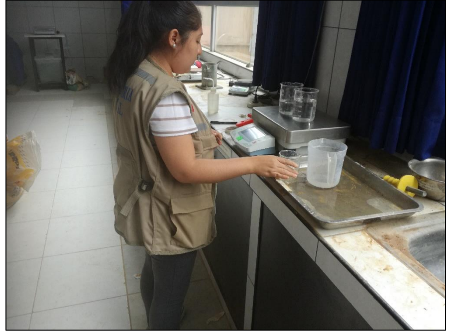
Ilustración N°33: Se peso 6kg de la muestra inalterada y se preparó el 11% de agua para nuestro ensayo del CBR.
