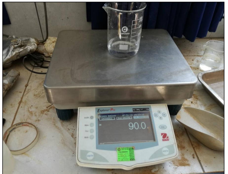
Ilustración N°28: De la muestra inalterada, se pesó los 3kg de la muestra como también los porcentajes del 3%,6%,9%, 12% y 15% de agua equivalente a la muestra.
