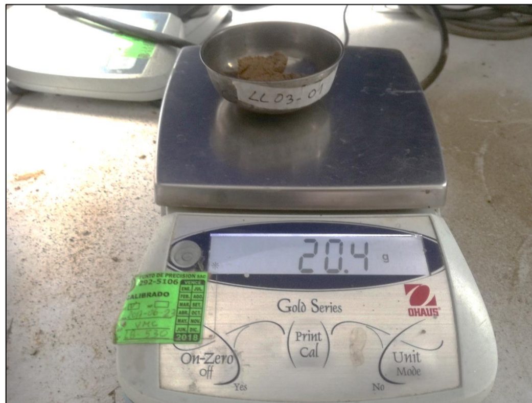
Ilustración N°26: De las dos mitades que se ha obtenido en la copa de casa grande, se tomó una mitad para el respectivo peso de la muestra húmeda y ser llevado al horno durante 24horas.
