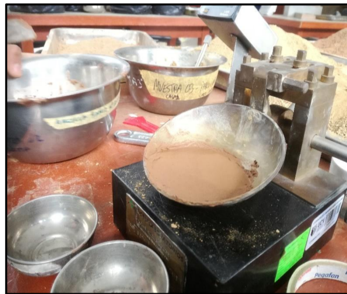
Ilustración N°23: Se prosiguió con la ayuda de la espátula a llenar la muestra viscosa en la copa de casa grande hasta quedar como media luna en la cuchara.
