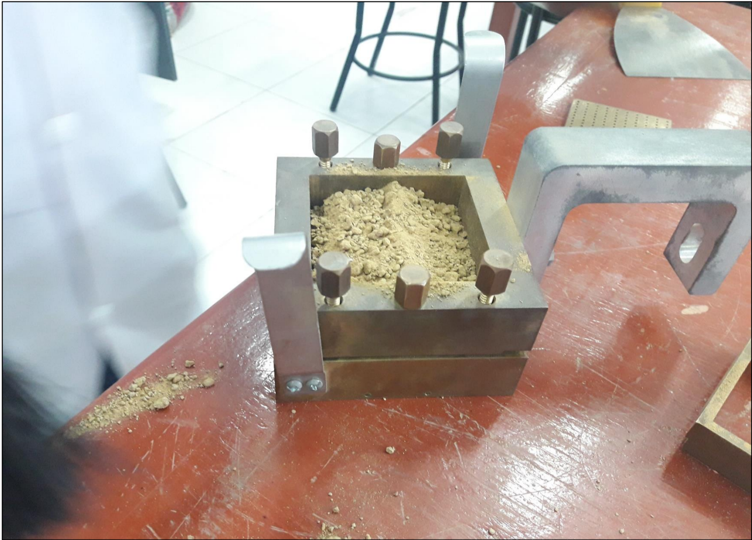
Ilustración N°45: De haber obtenido la primera capa compactada, se colocará la tapa superior observando que las nauras sean perpendiculares al movimiento del corte.
