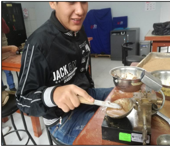
Ilustración N°23: Se prosiguió con la ayuda de la espátula a llenar la muestra viscosa en la copa de casa grande hasta quedar como media luna en la cuchara.
