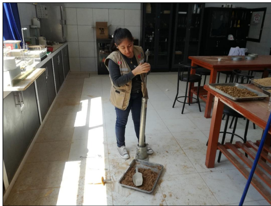
Ilustración N°31: Se compactó la muestra húmeda con la ayuda el pistón de 4.5 kg con una cantidad de 25 golpes por capa.
