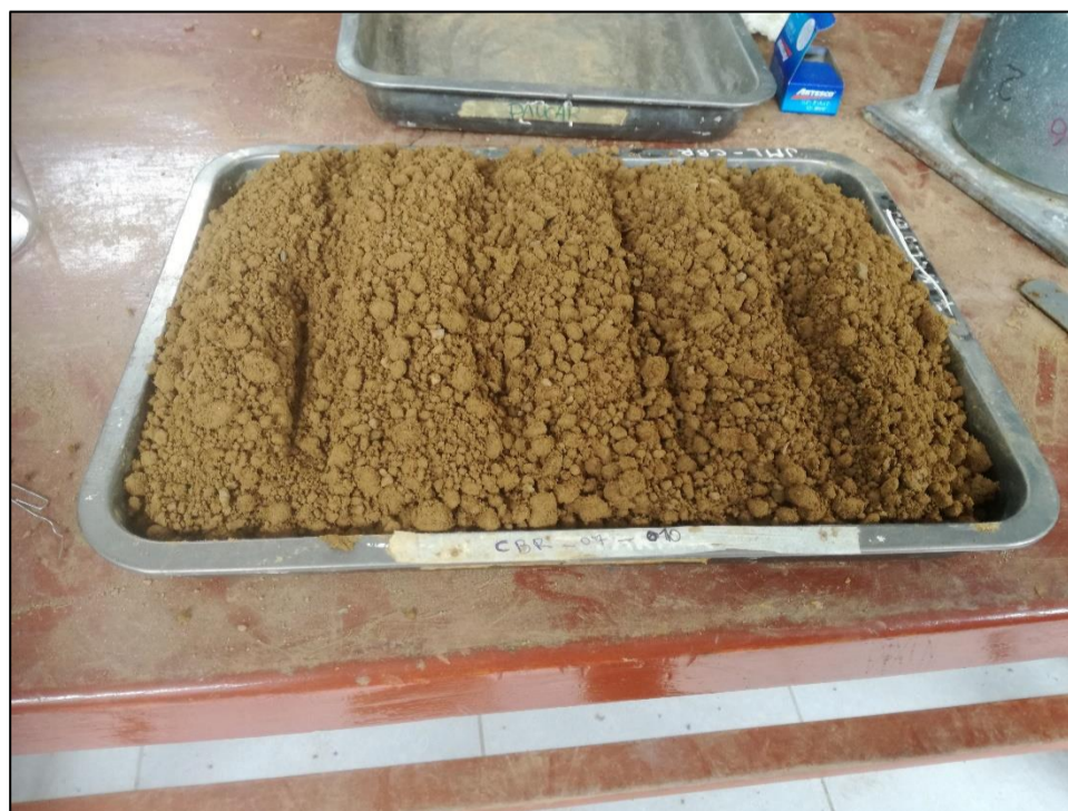
Ilustración N°34: Se adhirió el 11% de agua en la muestra d los 6 kilos, posteriormente quedando una muestra uniforme y se dividió en 5 partes iguales.
