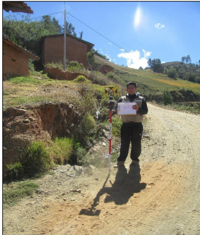
Ilustración N° 4: Levantamiento topográfico con estación total -prisma
