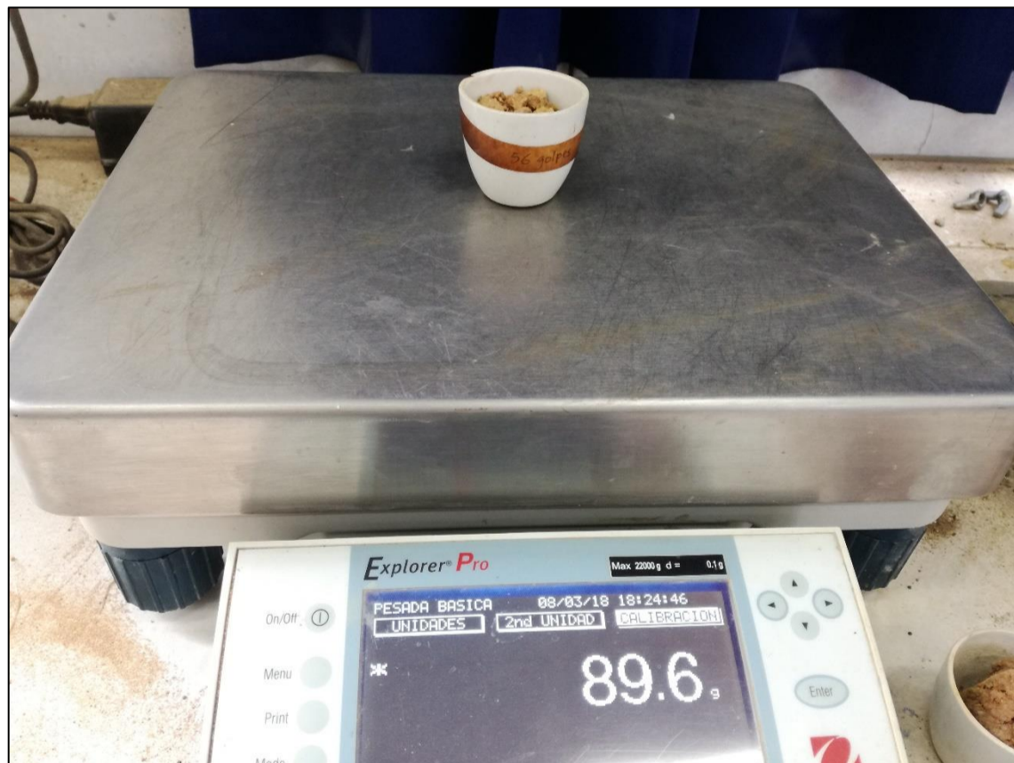
Ilustración N°40: Se retiro la muestra del CBR para extraer una pequeña proporción llenada en pequeñas taras, para determinar el peso del suelo y el contenido de humedad.
