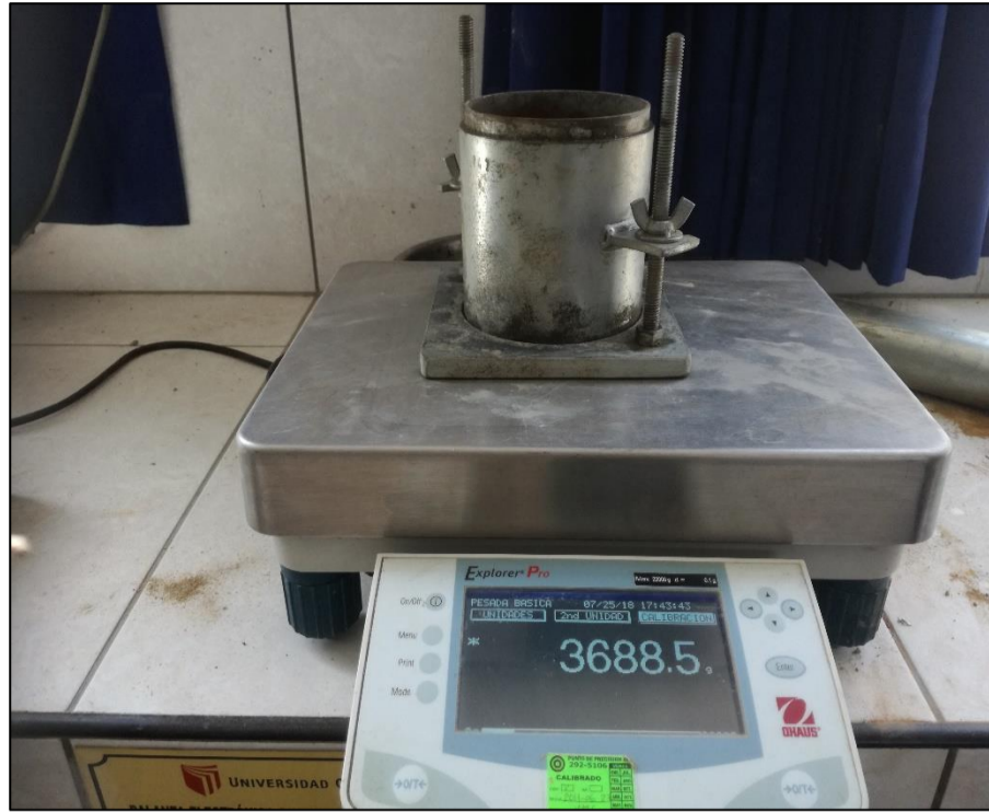
Ilustración N°30: Se peso el molde del Proctor en la balanza cuyo diámetro es de 9.7cm
