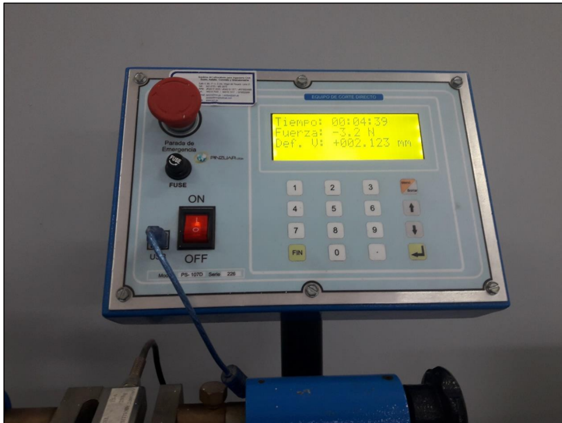
Ilustración N°48: Seleccionar el nivel de velocidad deseado de 1.5m/s y registrar el tiempo inicial, desplazamientos, la fuerza normal y cortante.
