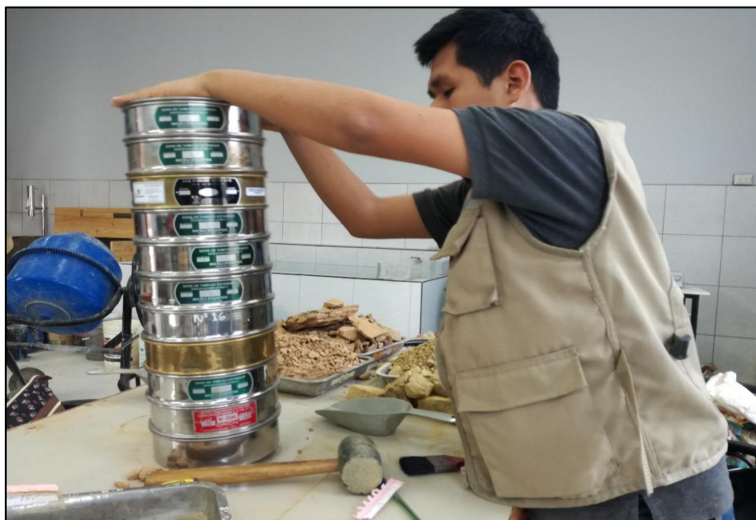
Ilustración N°18: Se tamizó la muestra en las mallas \frac{3}{4} , \frac{1}{2} , \frac{3}{8} , \frac{1}{4} , N°10, N°16, N°40, N°100 N°200 y el fondo
