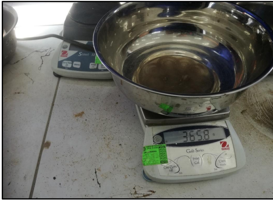
Ilustración N°19: Se prosiguió a pesar el tazón para las muestras del tamizado.
