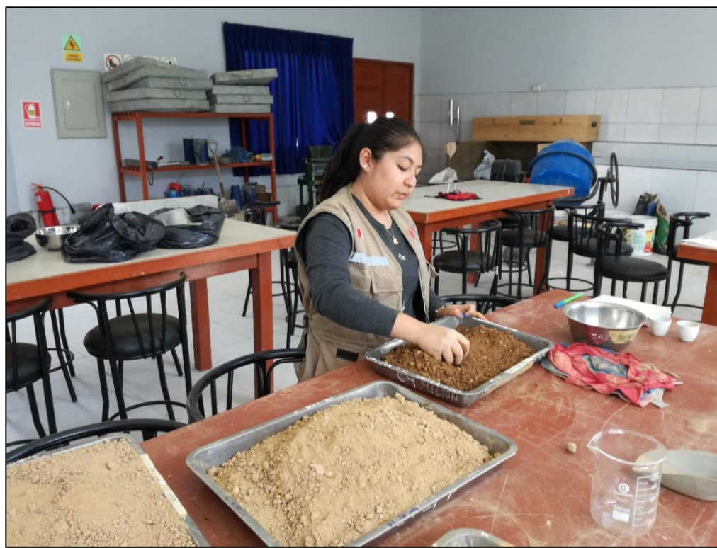
Ilustración N°33: Se peso 6kg de la muestra inalterada y se preparó el 11% de agua para nuestro ensayo del CBR.
