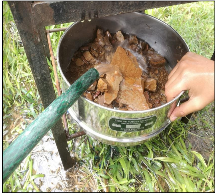
Ilustración N° 16: Se procedió a lavar la muestra en el tamiz N°200 con la finalidad de eliminar los limos y arcillas adheridas en el material granular.
