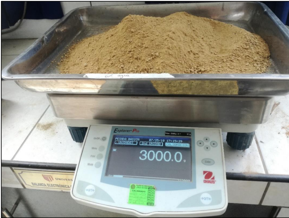
Ilustración N°28: De la muestra inalterada, se pesó los 3kg de la muestra como también los porcentajes del 3%,6%,9%, 12% y 15% de agua equivalente a la muestra.
