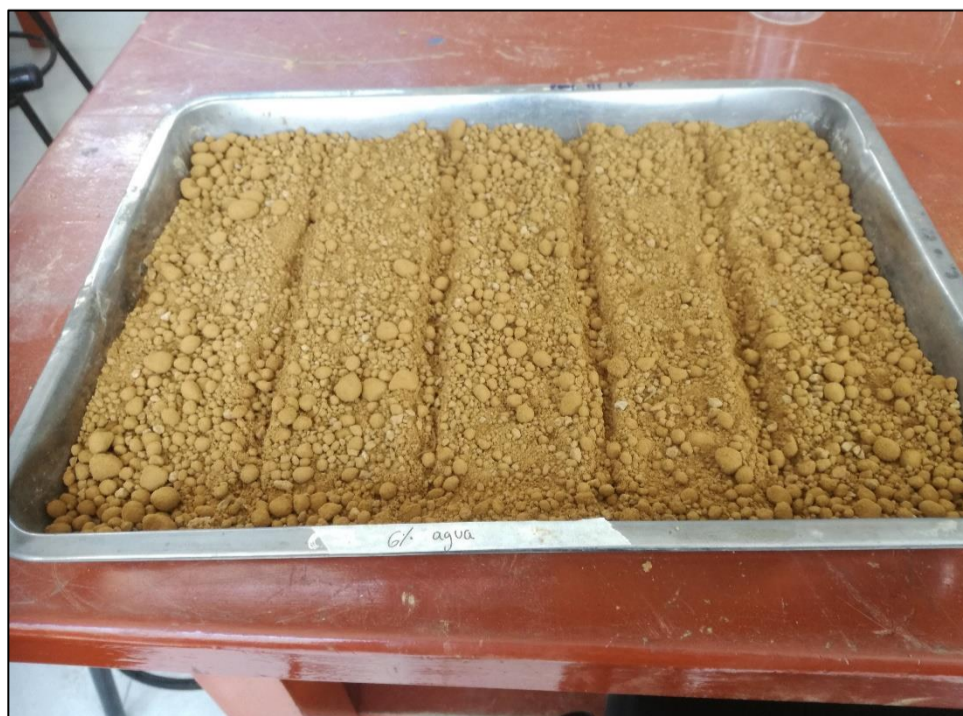
Ilustración N°29: Se adhirió las cantidades del del 3%,6%,9%, 12% y 15% de agua en la muestra hasta queda húmeda de manera uniforme y dividirlo en 5 partes iguales
