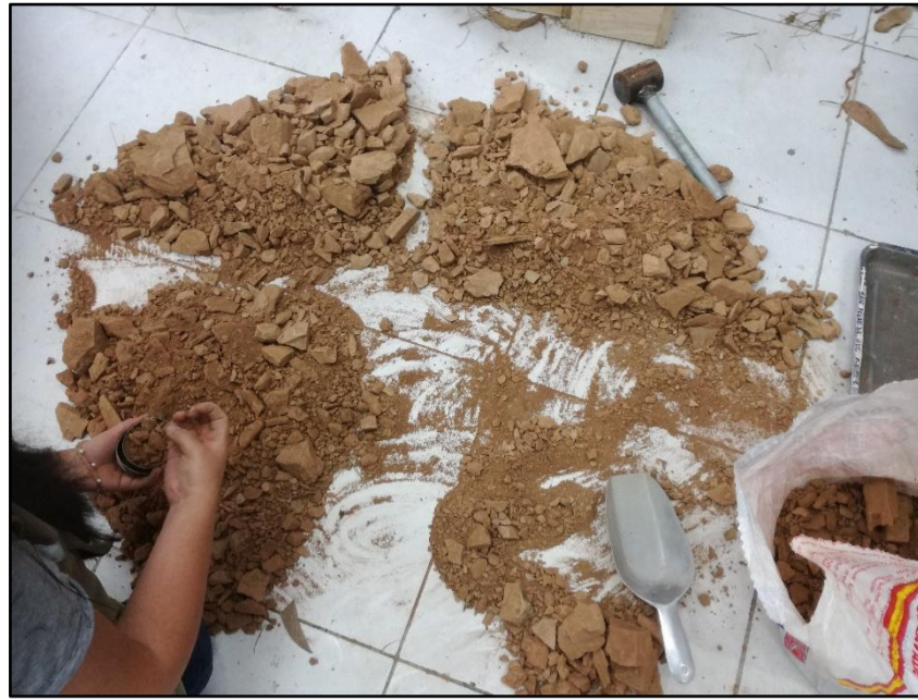
Ilustración N° 12: Se tomó una muestra uniforme y se cuarteó hasta alcanzar una muestra pequeña
