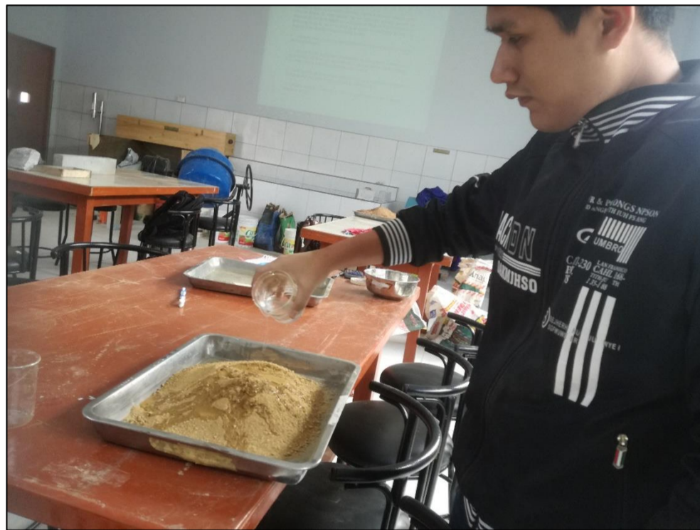
Ilustración N°28: De la muestra inalterada, se pesó los 3kg de la muestra como también los porcentajes del 3%,6%,9%, 12% y 15% de agua equivalente a la muestra.
