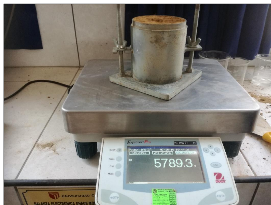
Ilustración N°32: Se quito el anillo superior del molde para pesar la muestra húmeda en la balanza.
