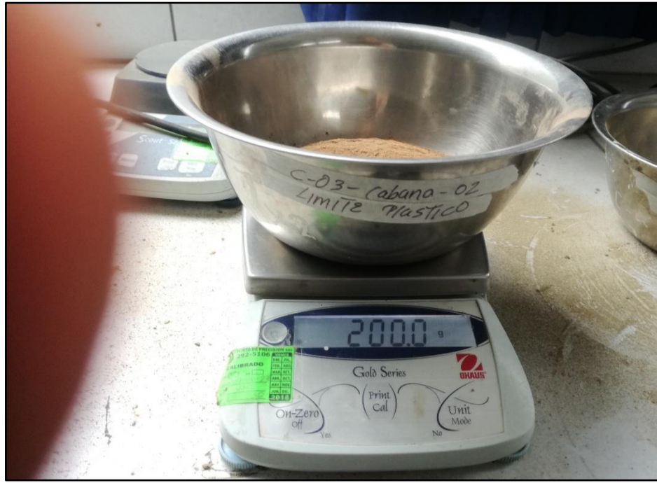
Ilustración N°22: Se prosiguió a pesa r 200 gramos para el límite plástico.
