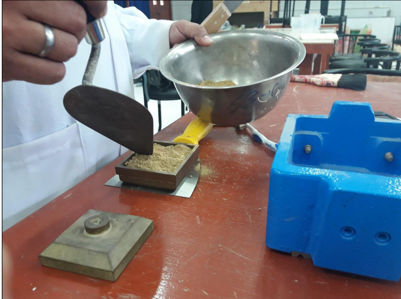
Ilustración N° 43: Se empieza a colocar la muestra encima de la espátula con la ayuda de la caja de corte.
