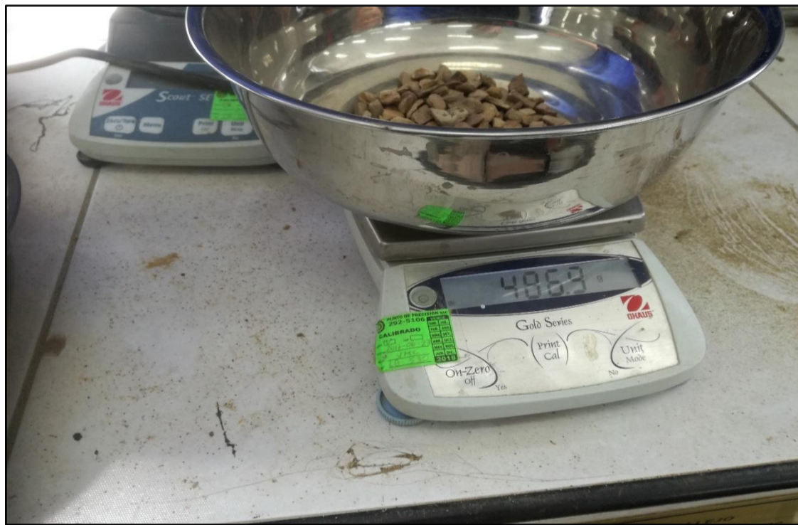
Ilustración N°20: Se prosiguió a pesar el peso retenido de cada tamiz.
