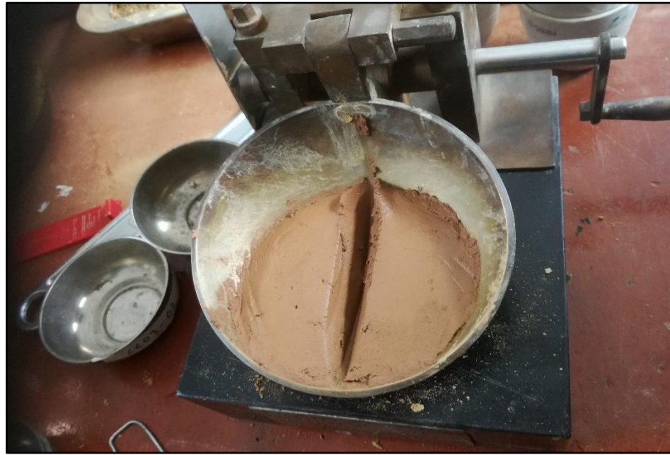
Ilustración N°25: Posteriormente con la manivela se prosiguió a dar los golpes de la copa casa grande hasta que las dos mitades se cierren.
