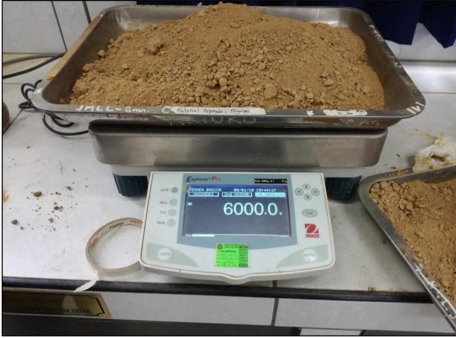
Ilustración N°33: Se peso 6kg de la muestra inalterada y se preparó el 11% de agua para nuestro ensayo del CBR.
