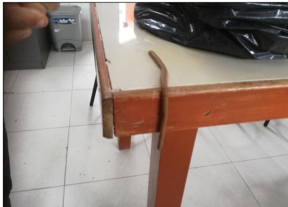
Ilustración N°27: Se enrolló la pasta viscosa en u a lamina de vidrio hasta formar un rollito de 1 cm de diámetro, para el ensayo de limite plástico
