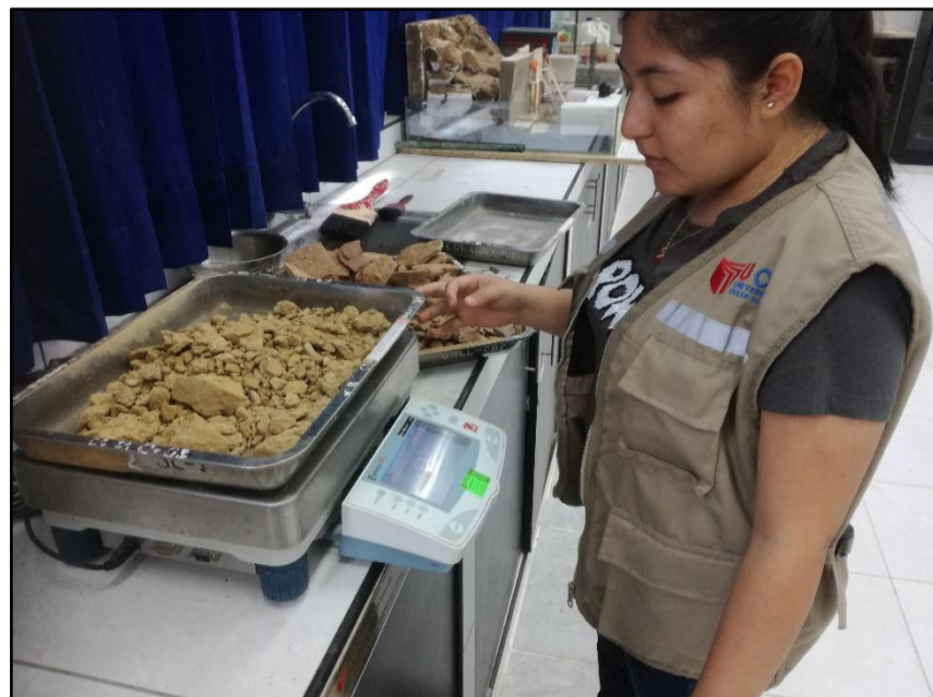
Ilustración N° 13: Se aprecia el registro del peso de la muestra uniforme.
