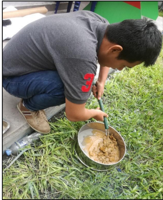
Ilustración N° 16: Se procedió a lavar la muestra en el tamiz N°200 con la finalidad de eliminar los limos y arcillas adheridas en el material granular.
