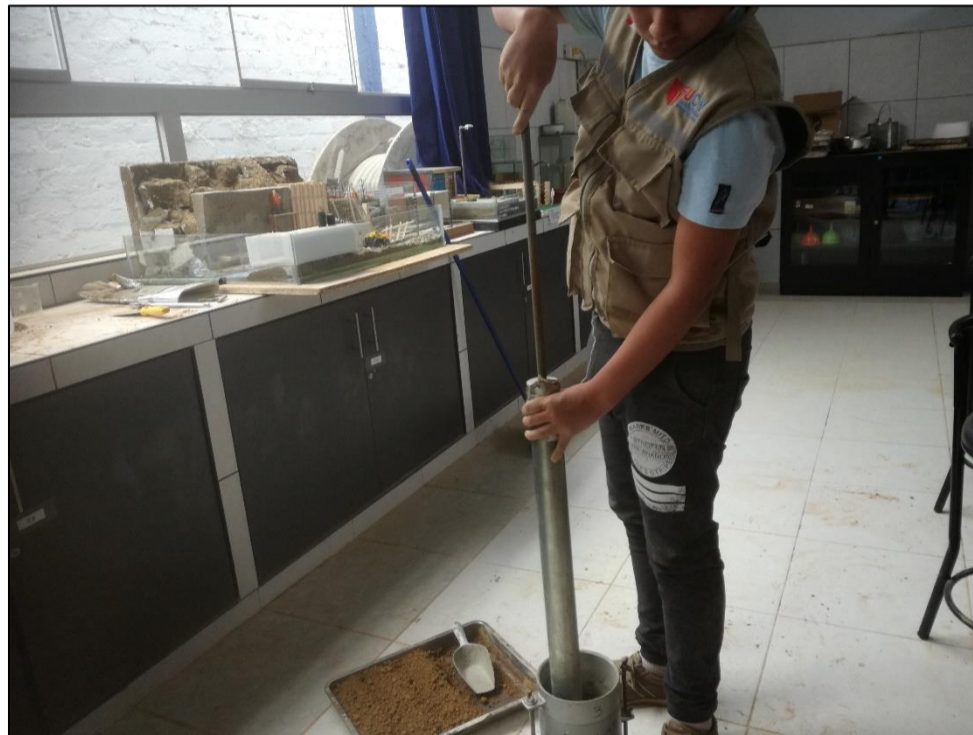
Ilustración N°35: Se compactó la muestra húmeda en el molde del CBR con la ayuda del pistón de 4.5 kg con diferentes golpes de 10,25 y 56 respectivamente por muestra
