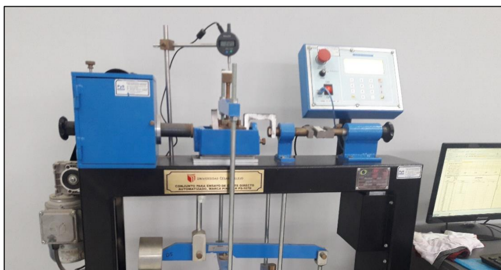
Ilustración N°46: Se colocará la carga normal (pesa de 4kilos), verificando que el contrapeso esté bien colocados y cúmplala función correctamente.
