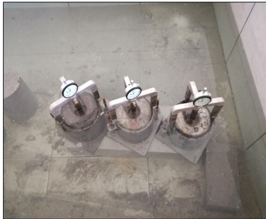
Ilustración N°37: Se colocó los moldes de CBR con muestra compactada en agua durante 4 días, previo a esa colocando el día de medición de expansión sobre el molde del CBR.
