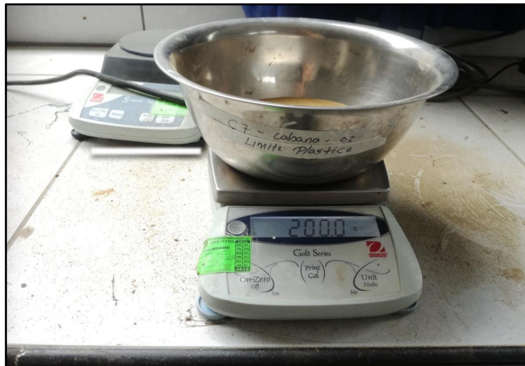
Ilustración N°21: Se prosiguió a pesar 200 gramos para el límite líquido.
