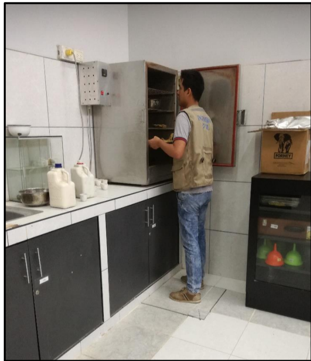
Ilustración N°17: Se prosiguió a secar en el horno durante 24 horas para luego pesar el material seco.
