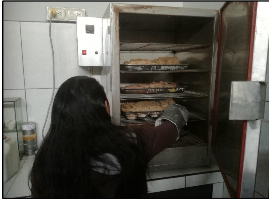
Ilustración N° 15: Se prosiguió a sacar las muestras del horno luego de haber pasado las 24 horas.
