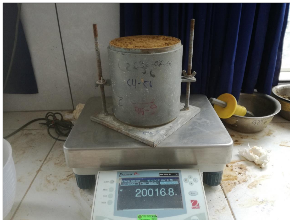
Ilustración N°35: Se compactó la muestra húmeda en el molde del CBR con la ayuda del pistón de 4.5 kg con diferentes golpes de 10,25 y 56 respectivamente por muestra
