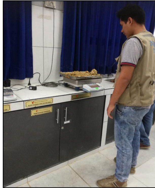
Ilustración N°17: Se prosiguió a secar en el horno durante 24 horas para luego pesar el material seco.
