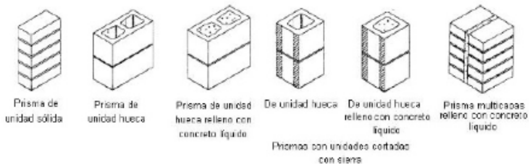
FIGURA 1 - Construcción de prismas de albañilería
