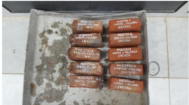
FIGURA N°67, N°68, N°69: Muestras sacadas de los recipientes después de 24 horas de remojo.
