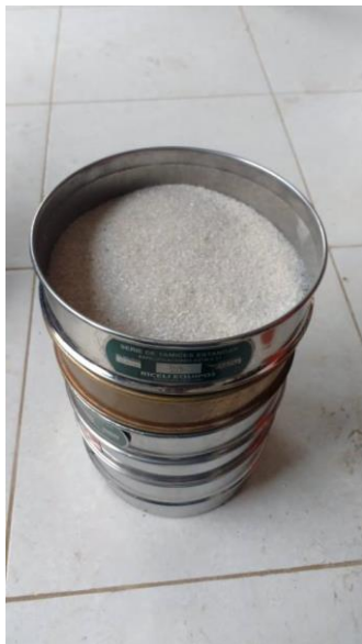
FIGURA N°11, N°12, N°13, N°14: Se seleccionó una muestra de 592 gr. de vidrio triturado reciclado para luego realizar el tamizado del vidrio triturado reciclado por las mallas N°16, N°20, N°40, N°50, N°100, N°200, finalmente se pesó el material retenido en cada tamiz.
