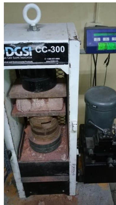
FIGURA N°128, N°129: Muestra de ladrillo con 12% de adición de vidrio triturado reciclado antes y después de haber sido sometido a la resistencia a la compresión.
