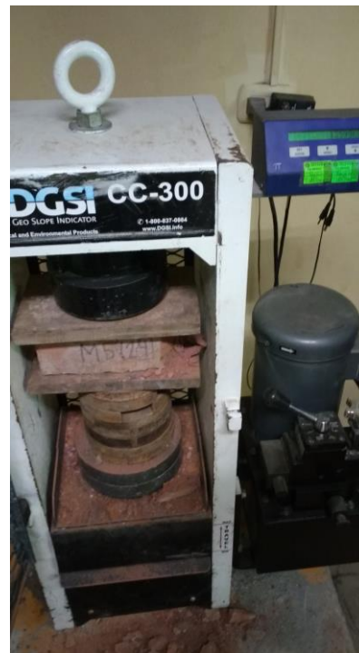
FIGURA N°132, N°133: Muestra de ladrillo con 24% de adición de vidrio triturado reciclado antes y después de haber sido sometido a la resistencia a la compresión.
