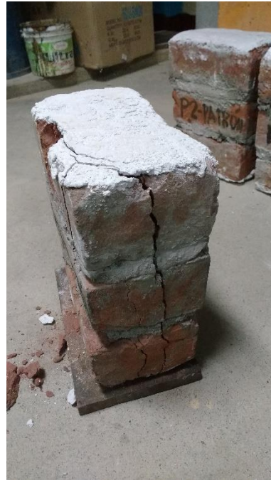
FIGURA N°147, N°148: Prisma de ladrillo patrón (P2) antes y después de haber sido sometido a fuerza de compresión a los 28 días, falla a tracción lateral.
