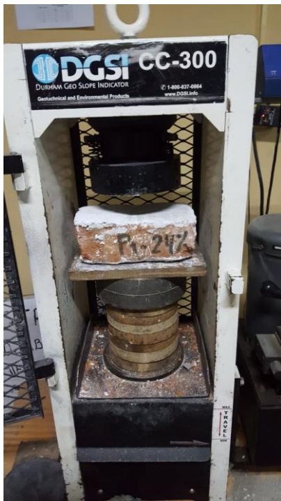
FIGURA N°132, N°133: Muestra de ladrillo con 24% de adición de vidrio triturado reciclado antes y después de haber sido sometido a la resistencia a la compresión.
