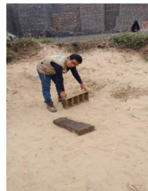
FIGURA N°26, N°27: Al día siguiente se limpia la gavera con arena fina para evitar que se pegue la mezcla.
