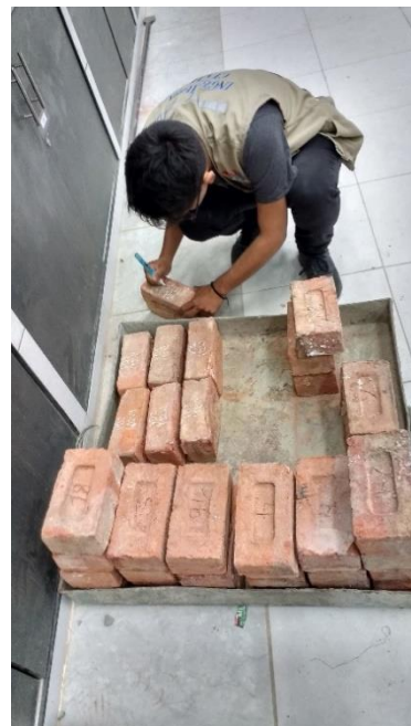
FIGURA N°81, N°82: Se limpió con una brocha la superficie de cada ladrillo para su correcta medición y se marcaron cada muestra para su identificación.
