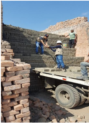
FIGURA N°50, N°51, N°52, N°53: Carga al horno de los ladrillos secados después de cinco días y colocación de carbón para su proceso de cocción.
