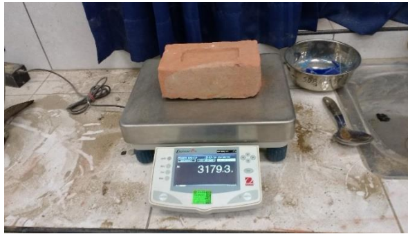
FIGURA N°64, N°65, N°66: Ladrillos remojados en tinas con agua durante 24 horas para luego obtener su peso saturado.
