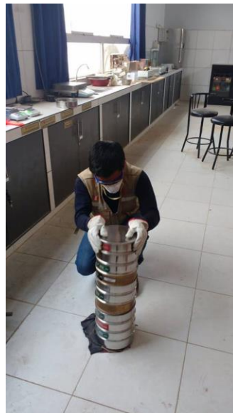
FIGURA N°11, N°12, N°13, N°14: Se seleccionó una muestra de 592 gr. de vidrio triturado reciclado para luego realizar el tamizado del vidrio triturado reciclado por las mallas N°16, N°20, N°40, N°50, N°100, N°200, finalmente se pesó el material retenido en cada tamiz.
