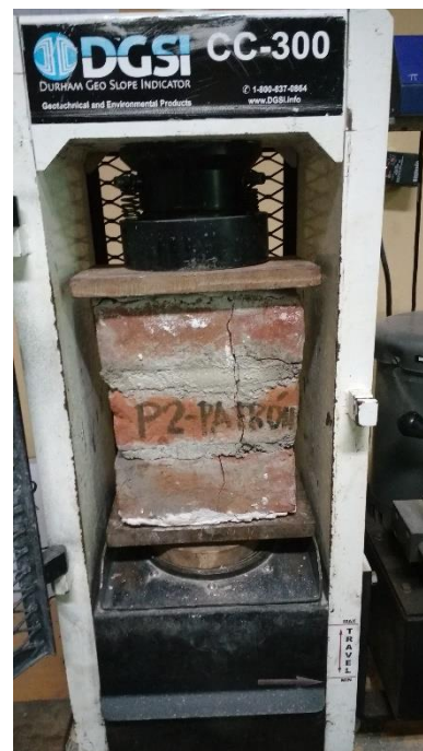
FIGURA N°147, N°148: Prisma de ladrillo patrón (P2) antes y después de haber sido sometido a fuerza de compresión a los 28 días, falla a tracción lateral.
