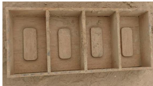
FIGURA N° 25: Gavera utilizada para la elaboración de los ladrillos de arcilla artesanal con vidrio triturado reciclado. (22cm x 12cm x 8.5cm)
