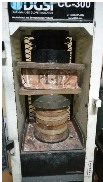
FIGURA N°128, N°129: Muestra de ladrillo con 12% de adición de vidrio triturado reciclado antes y después de haber sido sometido a la resistencia a la compresión.
