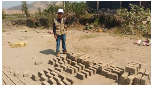
FIGURA N°49: Volteo de los ladrillos de arcilla artesanal y con adición de 6%,12%, 18%,24% de vidrio triturado reciclado después de tres días para su secado uniforme en todas sus caras.
