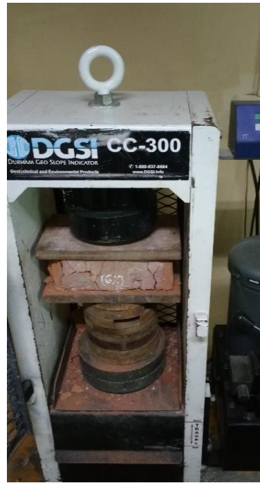
FIGURA N°128, N°129: Muestra de ladrillo con 12% de adición de vidrio triturado reciclado antes y después de haber sido sometido a la resistencia a la compresión.
