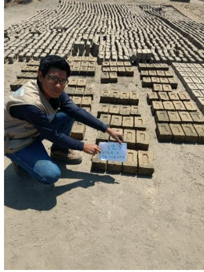
FIGURA N°45, N°46, N°47, N°48: Secado de los ladrillos de arcilla artesanal con adición de 6%,12%, 18%,24% de vidrio triturado reciclado.
