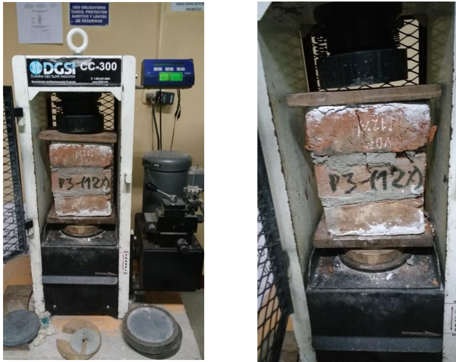
FIGURA N°151, N°152: Prisma de ladrillo con el 12% de adición de vidrio triturado reciclado (P4) antes y después de haber sido sometido a fuerza de compresión a los 28 días, falla a tracción lateral.
