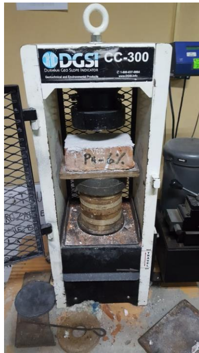
FIGURA N°128, N°129: Muestra de ladrillo con 12% de adición de vidrio triturado reciclado antes y después de haber sido sometido a la resistencia a la compresión.
