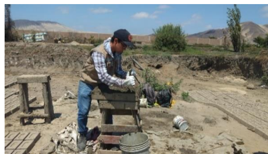
FIGURA N°41, N°42, N°43, N°44: Con ayuda de una cortadora retirando lo excedente en la gavera y desmolde de los ladrillos con vidrio triturado reciclado en un terreno firme(tendales) para su respectivo secado.
