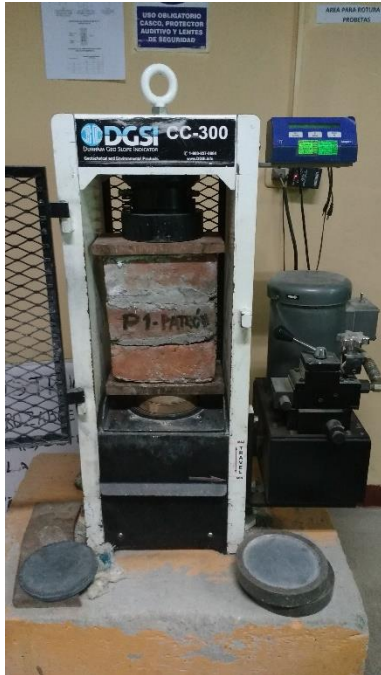
FIGURA N°147, N°148: Prisma de ladrillo patrón (P2) antes y después de haber sido sometido a fuerza de compresión a los 28 días, falla a tracción lateral.
