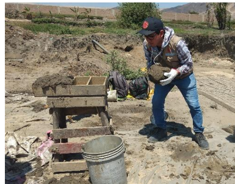
FIGURA N° 37, N°38, N°39, N°40: Colocación de un solo golpe la mezcla en la gavera y retiro de material excedente.
