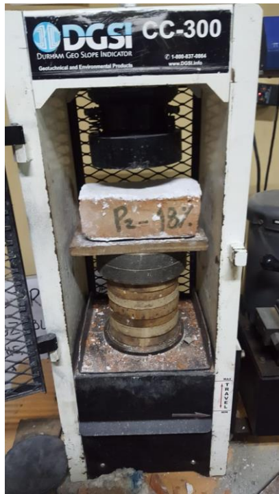
FIGURA N°132, N°133: Muestra de ladrillo con 24% de adición de vidrio triturado reciclado antes y después de haber sido sometido a la resistencia a la compresión.
