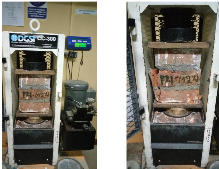
FIGURA N°151, N°152: Prisma de ladrillo con el 12% de adición de vidrio triturado reciclado (P4) antes y después de haber sido sometido a fuerza de compresión a los 28 días, falla a tracción lateral.
