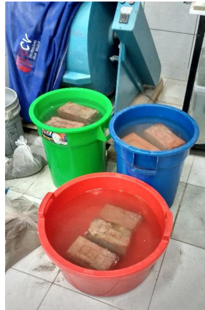
FIGURA N°64, N°65, N°66: Ladrillos remojados en tinas con agua durante 24 horas para luego obtener su peso saturado.
