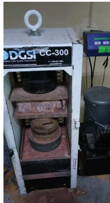
FIGURA N°132, N°133: Muestra de ladrillo con 24% de adición de vidrio triturado reciclado antes y después de haber sido sometido a la resistencia a la compresión.
