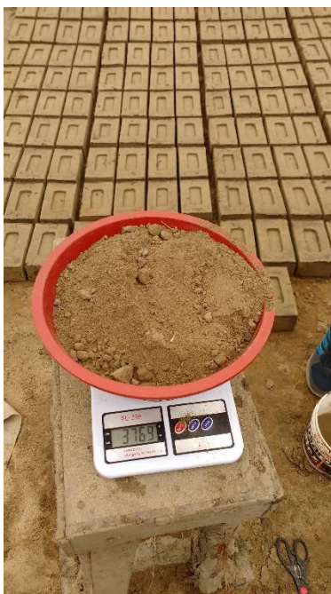
FIGURA N°17, N°18: Pesado de arcilla para la elaboración de ladrillos artesanales.
