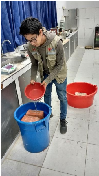
FIGURA N°64, N°65, N°66: Ladrillos remojados en tinas con agua durante 24 horas para luego obtener su peso saturado.
