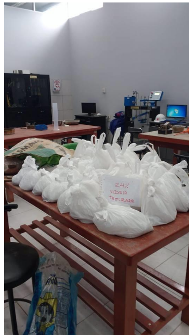
FIGURA N°15: Muestras de vidrio triturado reciclado pesadas al 6%, 12%,18%,24% del peso de arcilla de un ladrillo artesanal para luego ser llevados a la ladrillera.
