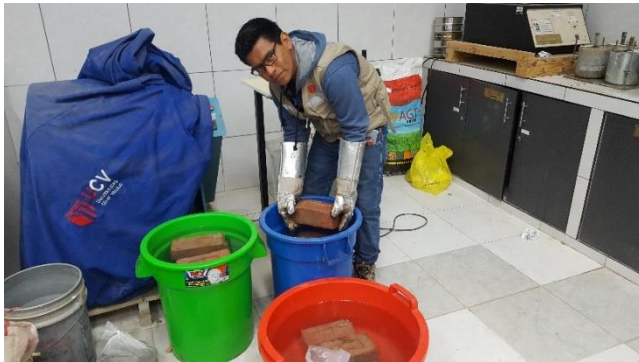
FIGURA N°67, N°68, N°69: Muestras sacadas de los recipientes después de 24 horas de remojo.
