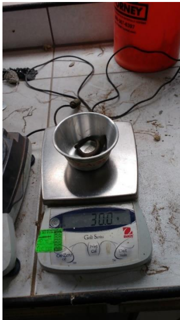
FIGURA N°100, N°101: Pesado de taras con muestras y llevados al horno durante 24 horas.
