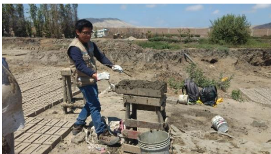
FIGURA N°41, N°42, N°43, N°44: Con ayuda de una cortadora retirando lo excedente en la gavera y desmolde de los ladrillos con vidrio triturado reciclado en un terreno firme(tendales) para su respectivo secado.
