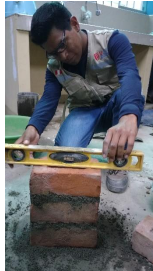
FIGURA N°142, N°143: Refrentado de prismas con yeso.
