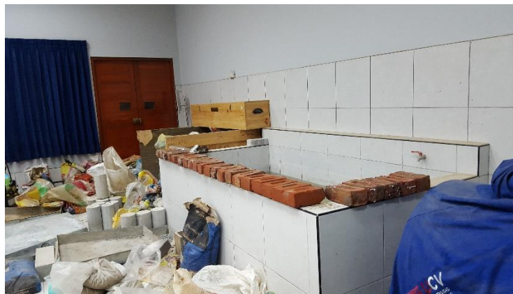
FIGURA N°70, N°71: Muestras siendo marcadas de acuerdo a los porcentajes adicionados (6%,12%,18%,24%) de vidrio triturado reciclado en los ladrillos, posteriormente se le realizó su pesado de cada una de ellas.
