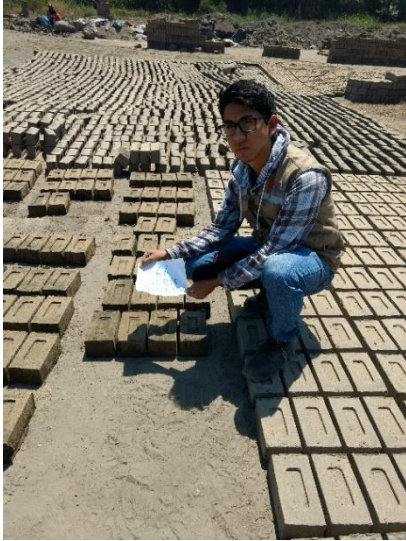
FIGURA N°45, N°46, N°47, N°48: Secado de los ladrillos de arcilla artesanal con adición de 6%,12%, 18%,24% de vidrio triturado reciclado.
