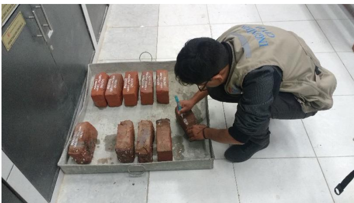
FIGURA N°70, N°71: Muestras siendo marcadas de acuerdo a los porcentajes adicionados (6%,12%,18%,24%) de vidrio triturado reciclado en los ladrillos, posteriormente se le realizó su pesado de cada una de ellas.
