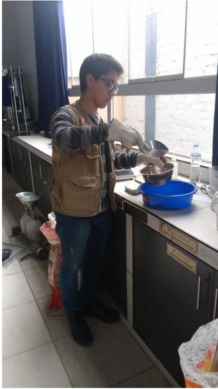
FIGURA N°15: Muestras de vidrio triturado reciclado pesadas al 6%, 12%,18%,24% del peso de arcilla de un ladrillo artesanal para luego ser llevados a la ladrillera.
