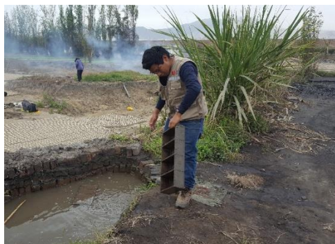
FIGURA N°26, N°27: Al día siguiente se limpia la gavera con arena fina para evitar que se pegue la mezcla.
