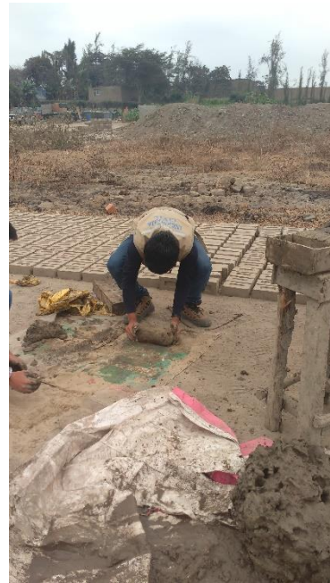
FIGURA N°28, N°29: Amasado y mezclado del material arcilloso para la elaboración de los ladrillos patrones.
