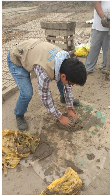
FIGURA N°28, N°29: Amasado y mezclado del material arcilloso para la elaboración de los ladrillos patrones.
