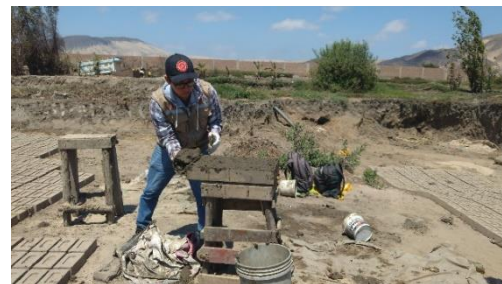
FIGURA N°41, N°42, N°43, N°44: Con ayuda de una cortadora retirando lo excedente en la gavera y desmolde de los ladrillos con vidrio triturado reciclado en un terreno firme(tendales) para su respectivo secado.
