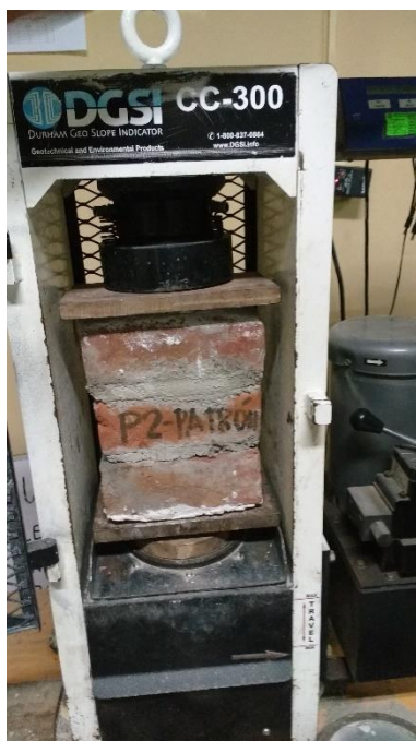
FIGURA N°147, N°148: Prisma de ladrillo patrón (P2) antes y después de haber sido sometido a fuerza de compresión a los 28 días, falla a tracción lateral.
