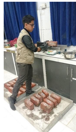
FIGURA N°70, N°71: Muestras siendo marcadas de acuerdo a los porcentajes adicionados (6%,12%,18%,24%) de vidrio triturado reciclado en los ladrillos, posteriormente se le realizó su pesado de cada una de ellas.
