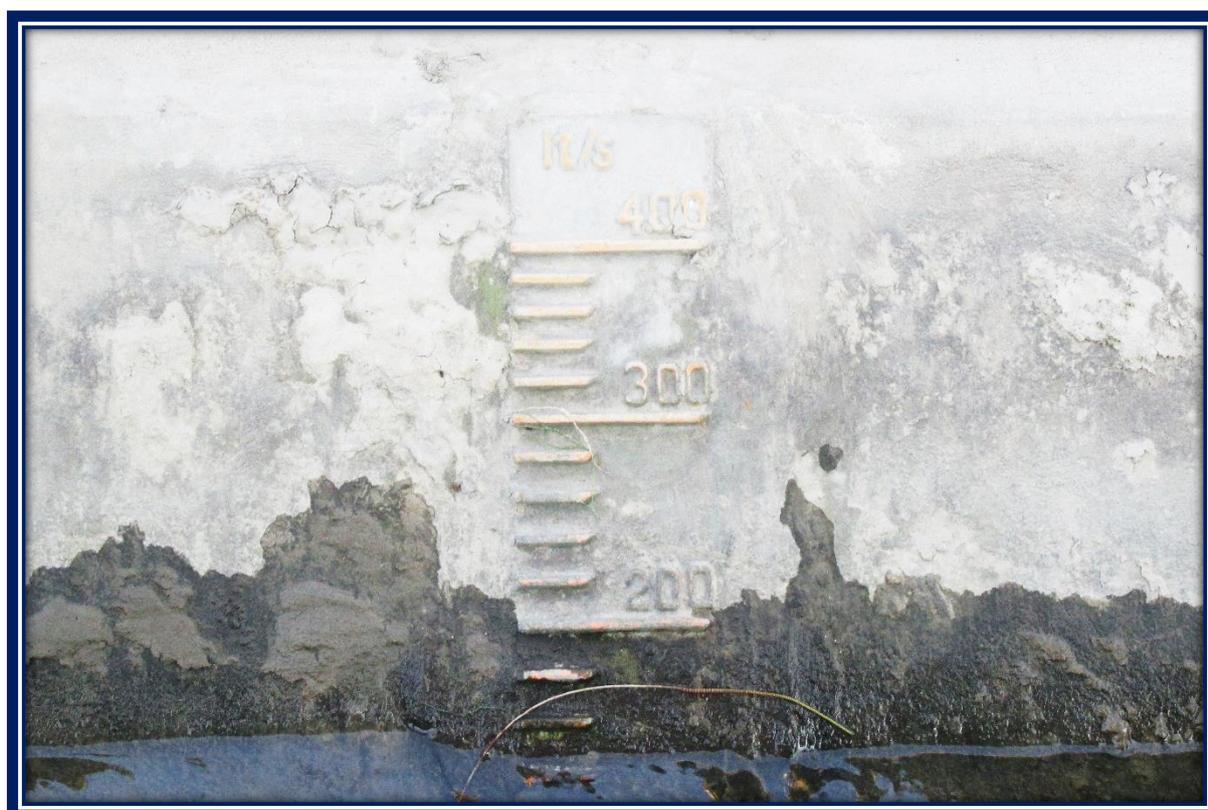
Fig. 17. Regla para medir la altura del agua en canal (Aquabook).
