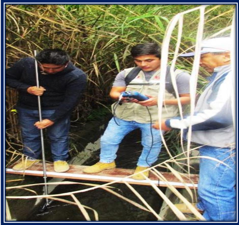
Fig. 28. Aforamiento en el Canal L1.
