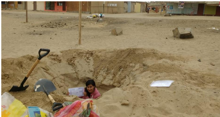
Figura N° 06 Exploración del Campo mediante las Calicatas
