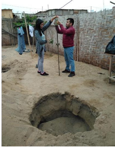
Figura N°05 Realizando el ensayo de DPL
