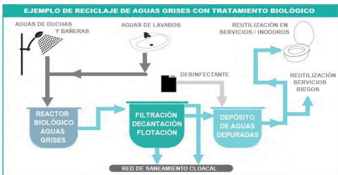
Figura 1. Sistema de tratamiento y reuso de aguas grises
