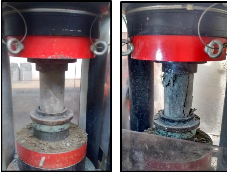
Figura 6 y 7. Ensayo a compresión de probeta con epóxico.
