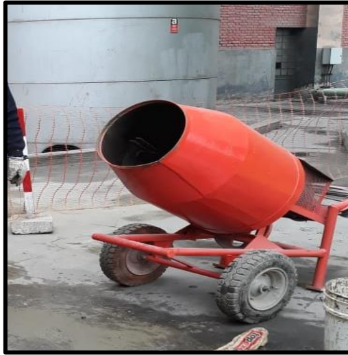
Figura 1. Mezcladora de Capacidad 130 litros, velocidad 27.7 RPM.
