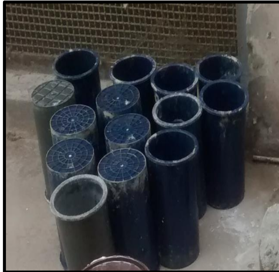
Figura 3. Moldes cilíndricos de acero de 10 cm. de diámetro y 20 cm. de altura.
