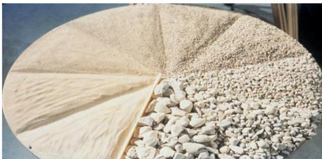
*Figura 4.* Distribución de diámetros de las partículas presentes en un agregado típico.
