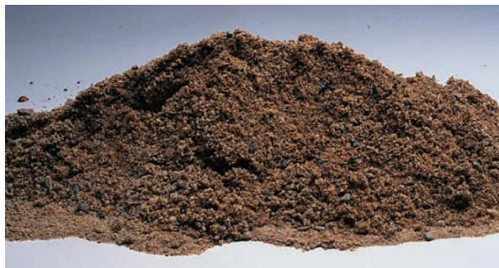
*Figura 3.* Ejemplo de agregado fino típico, usado en la preparación de mezclas.
