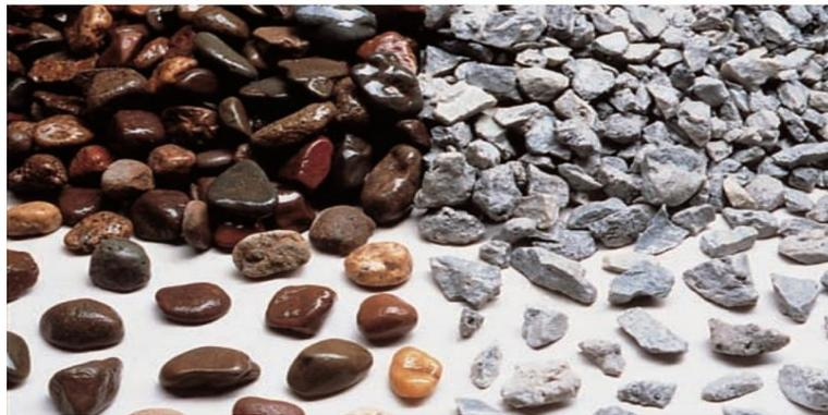
*Figura 1.* Tipos de agregado grueso, grava redondeada de río (izquierda) y grava angular.
