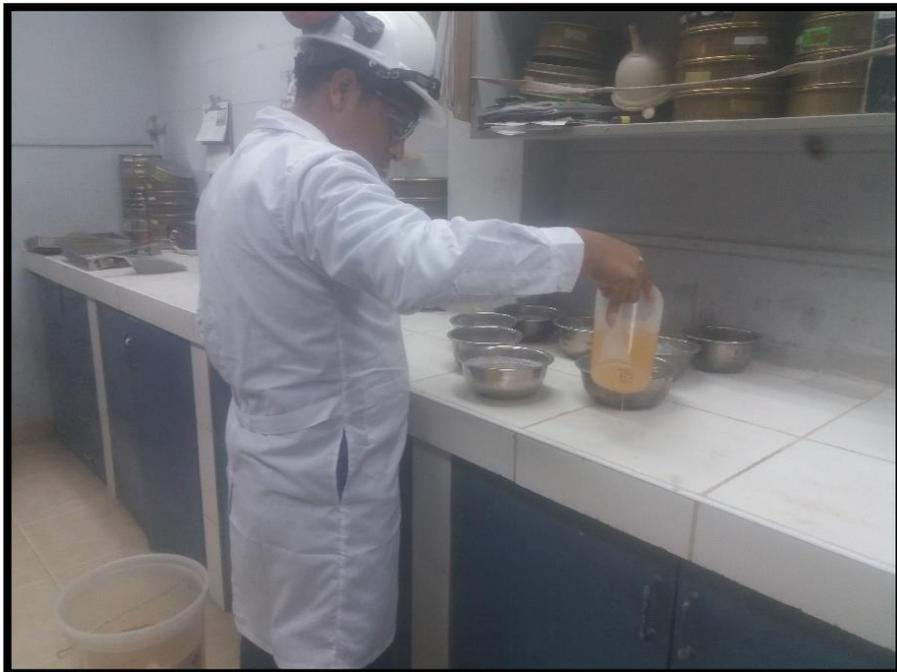
Ensayo de índice de espesor chatas y alargadas de los agregados
