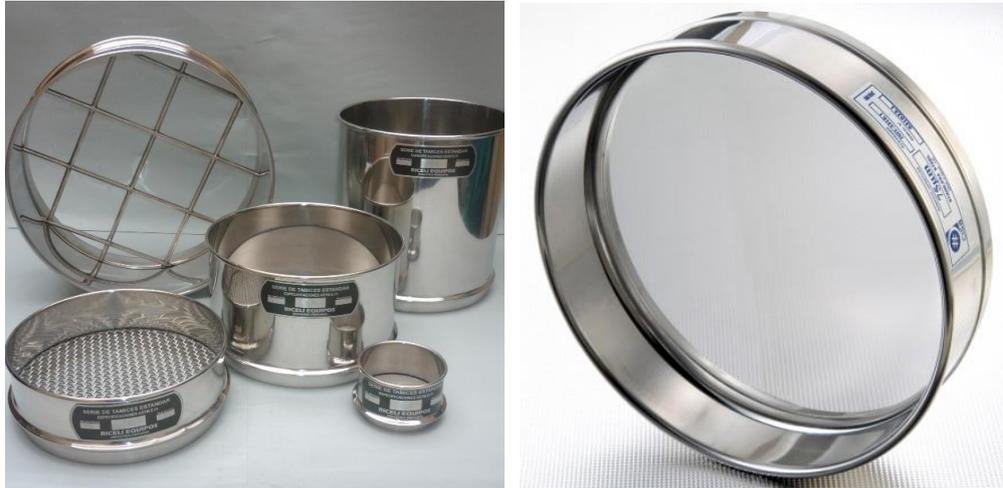
*Figura 2.* Tamices usados en la determinación del agregado grueso y fino.
