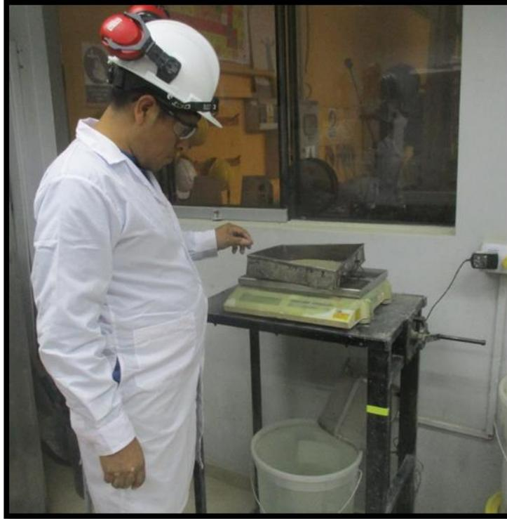
Lavado de agregado para ensayo de % pasante de malla 200
