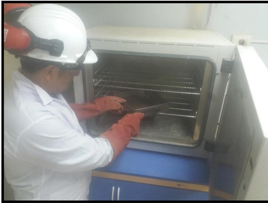
Ensayo de granulometría de los agregados
