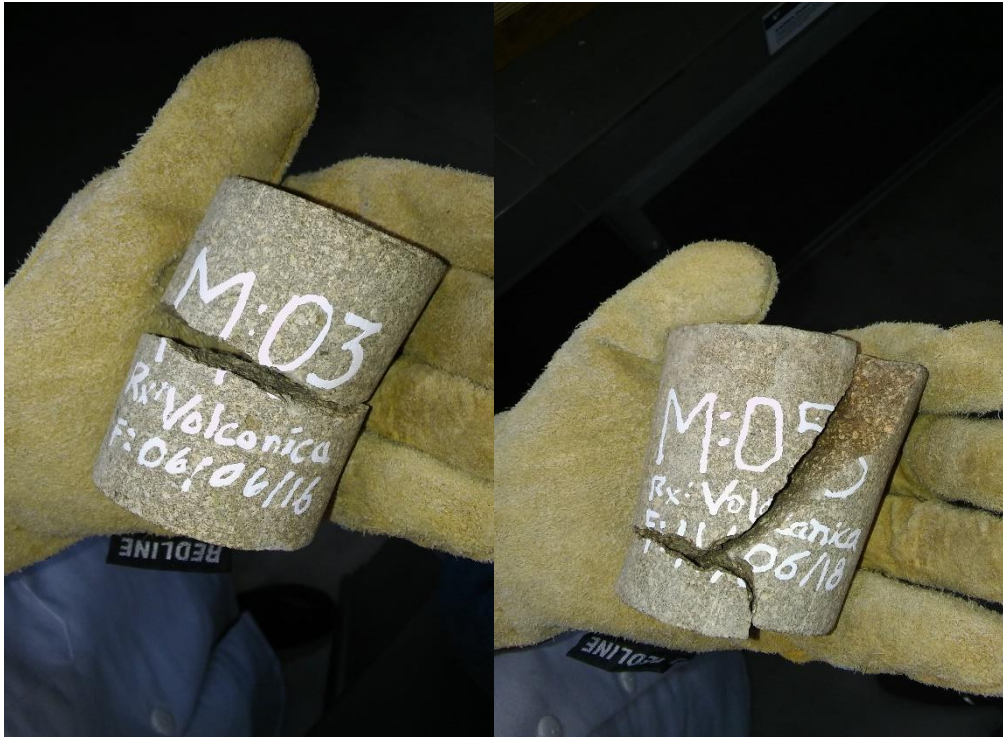
Anexo 231 Muestras ya sometidas a ensayos de carga puntual. Fuente: Propia.
