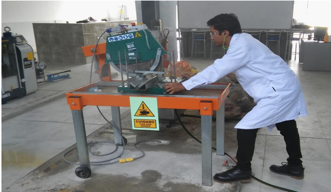
Anexo 229 Cortando los testigos al tamaño requerido para ensayo de carga puntual. Fuente: Propia.
