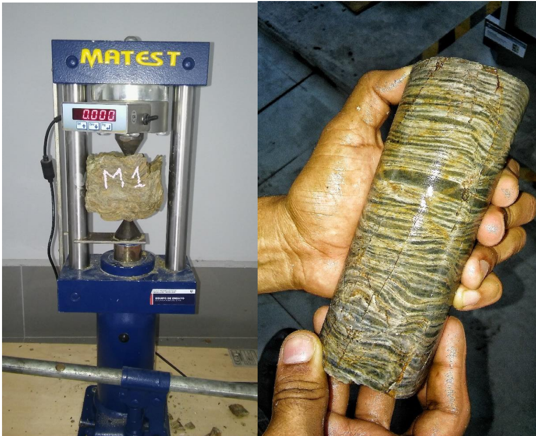
Anexo 226 aplicación del ensayo de carga puntual para muestras irregulares y testigo de roca. Fuente: Propia.
