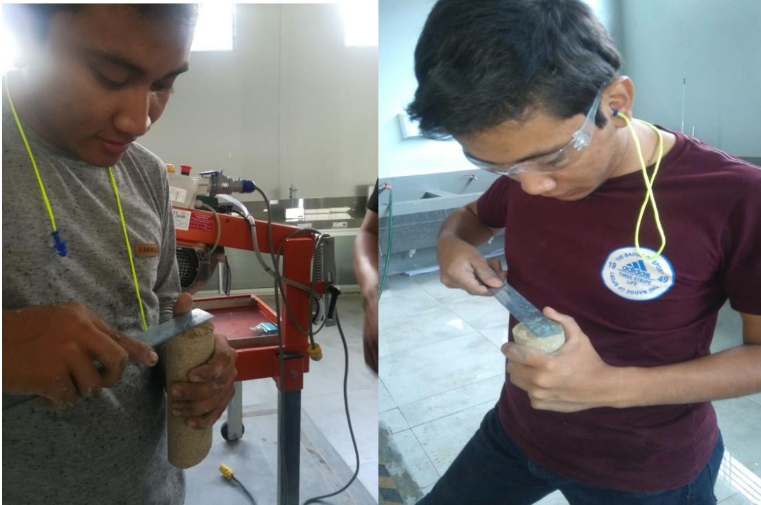
Anexo 233 Realizando la medicion del diametro de los testigos. Fuente: Propia.
