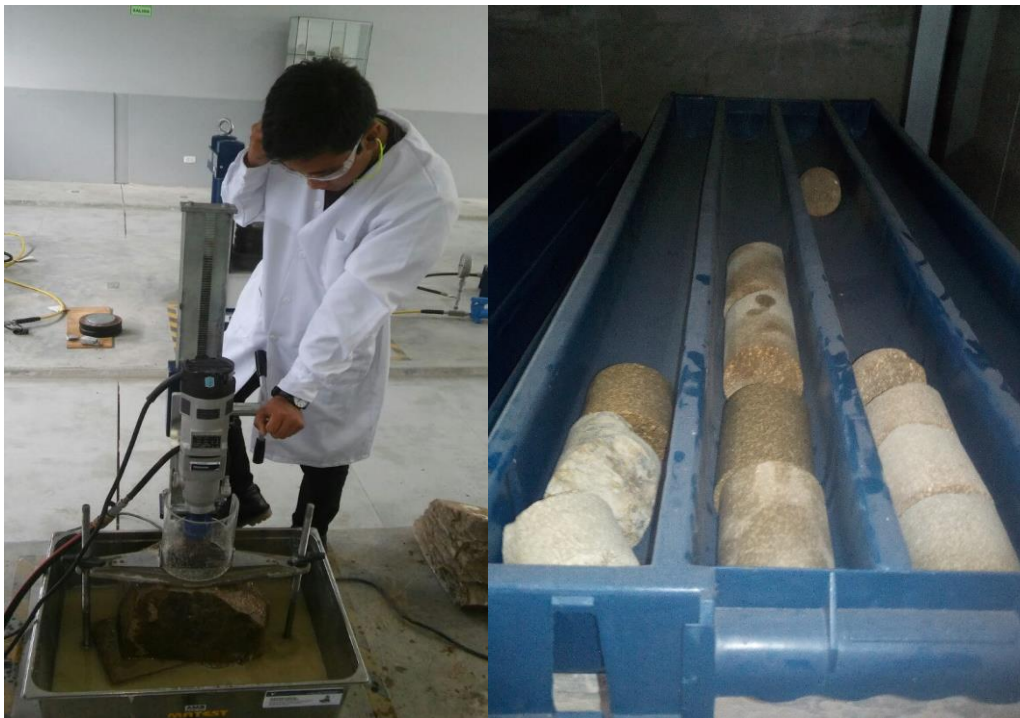
Anexo 232 Empleando la maquina extractora de testigos. Fuente: Propia.
