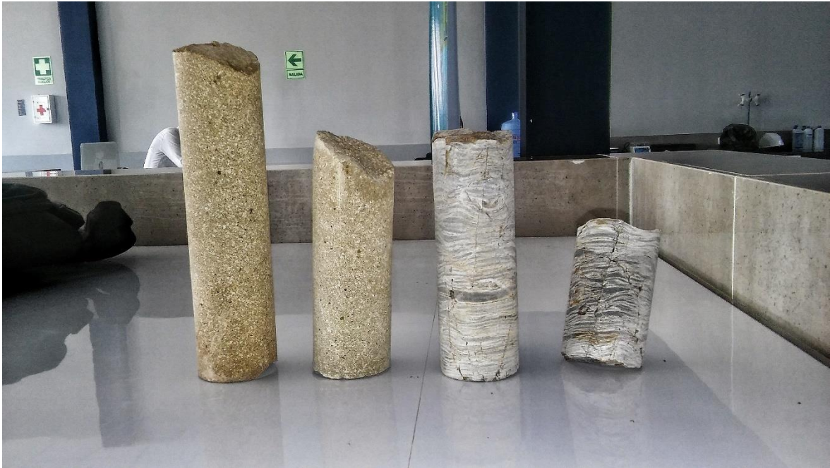
Anexo 225 Testigos obtenidos por medio de la perforación. Fuente: propia.
