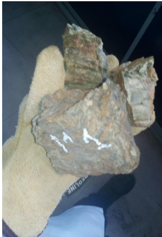
Anexo 228 Muestra ya sometida al ensayo de carga puntual. Fuente: propia.
