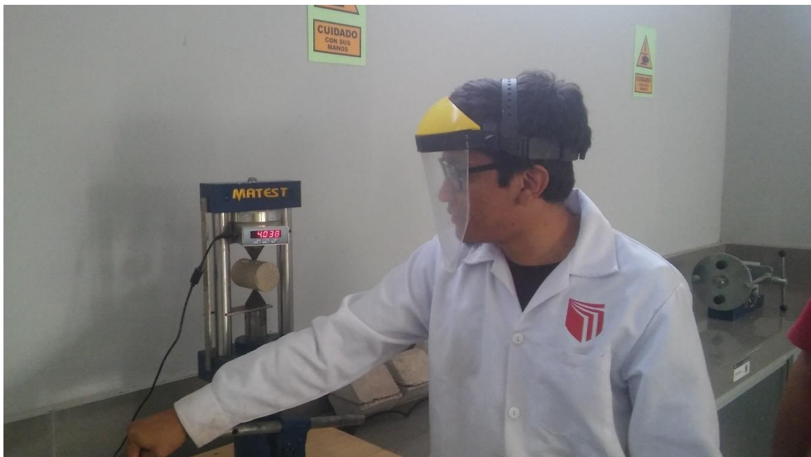
Anexo 230 Ejecutando un ensayo de carga puntual. Fuente: Propia.
