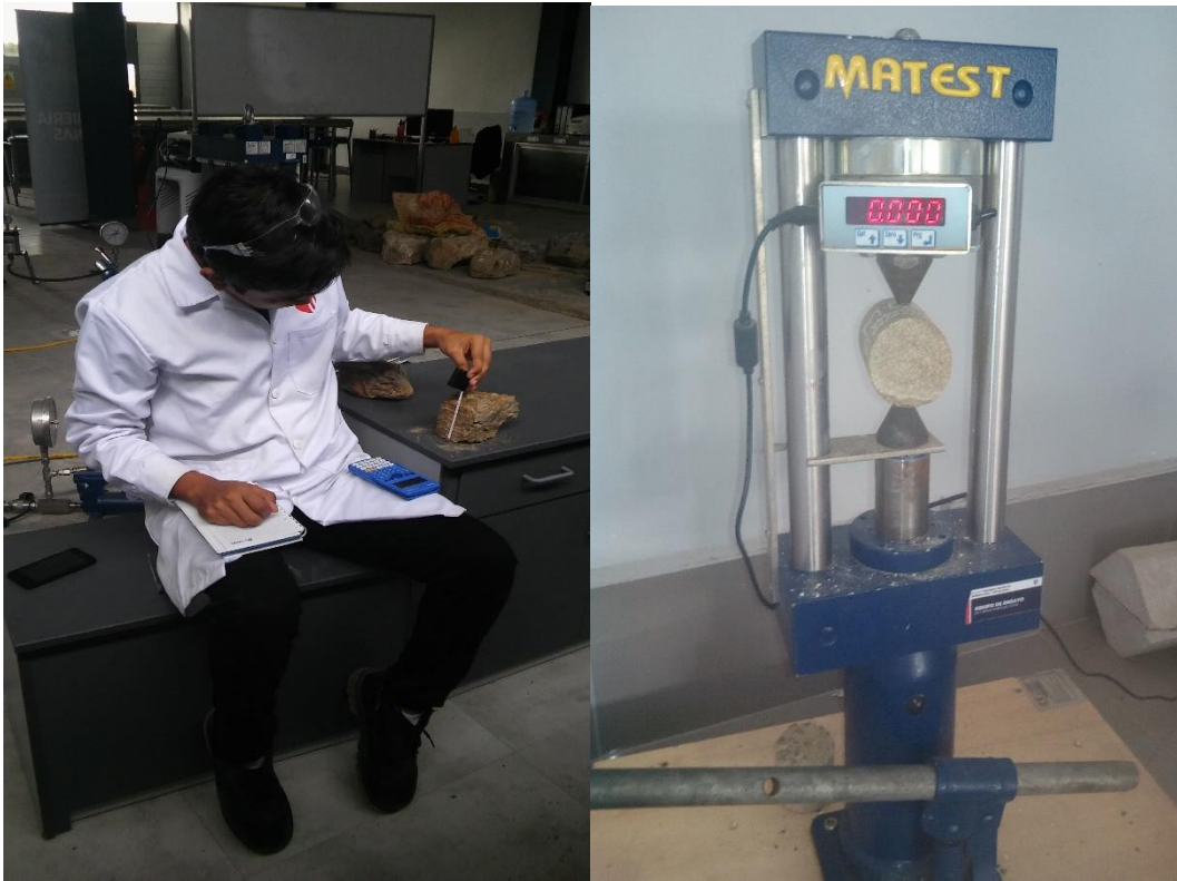
Anexo 227 Medición de las muestras y aplicación de carga, Fuente: propia.
