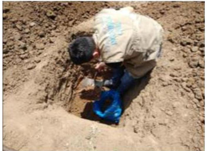
**Anexo 11:** fotografía de la calicata N° 06.extracción del material para su estudio de Mecánica de Suelo en el laboratorio.
