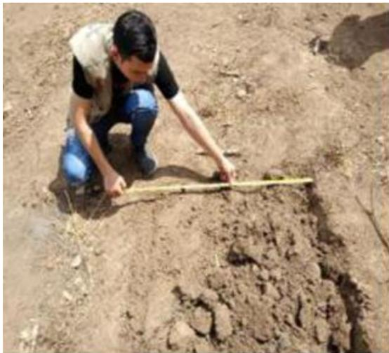
**Anexo 9:** calicata N° 02.excabacion de la calicata N° 02 para su posterior extracción del material para su estudio de Mecánica de Suelo en el laboratorio.
