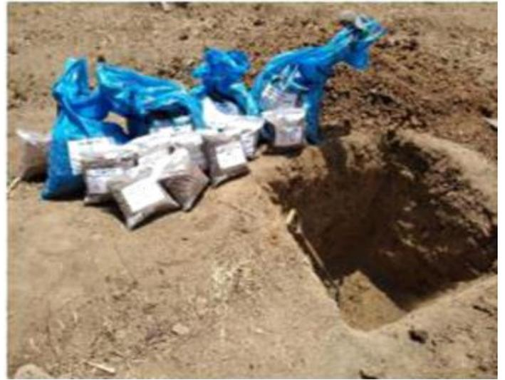
**Anexo 10:** fotografía de la calicata N° 04. Extracción del material para su estudio de Mecánica de Suelo en el laboratorio.
