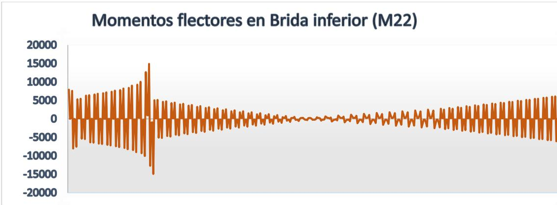
**Figura 37.** *Diagrama de momentos flectores – eje secundario en Vigas Longitudinales*
