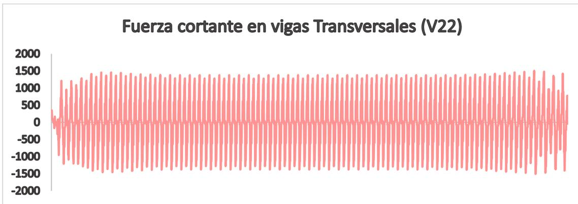
**Figura 29.** *Diagrama de fuerzas cortantes – eje secundario en vigas Transversales*
