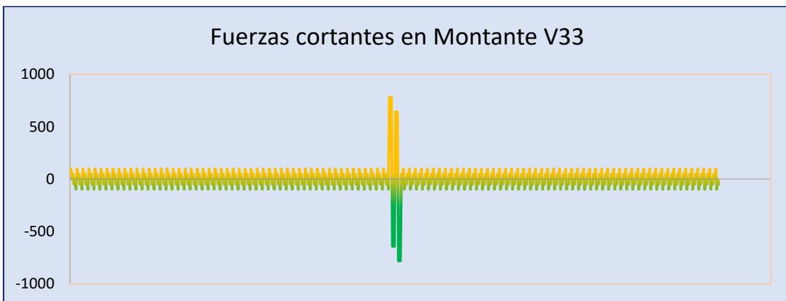
**Figura 47.** *Diagrama de fuerzas cortantes – eje principal en Montantes.*
