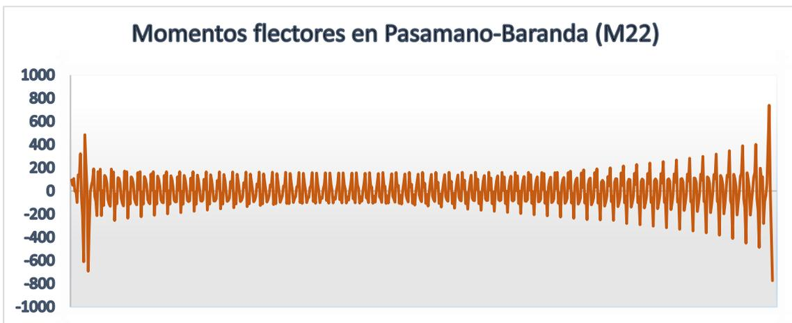
**Figura 32.** *Diagrama de momentos flectores – eje secundario en Baranda*
