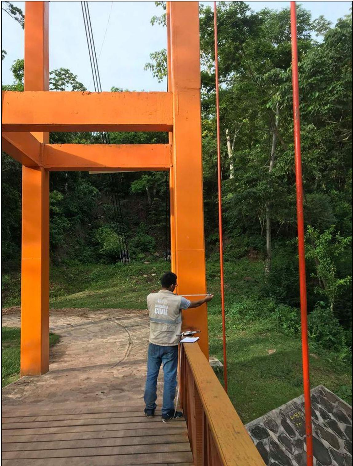
Foto 06: Verificación de ancho columna 40 cm
