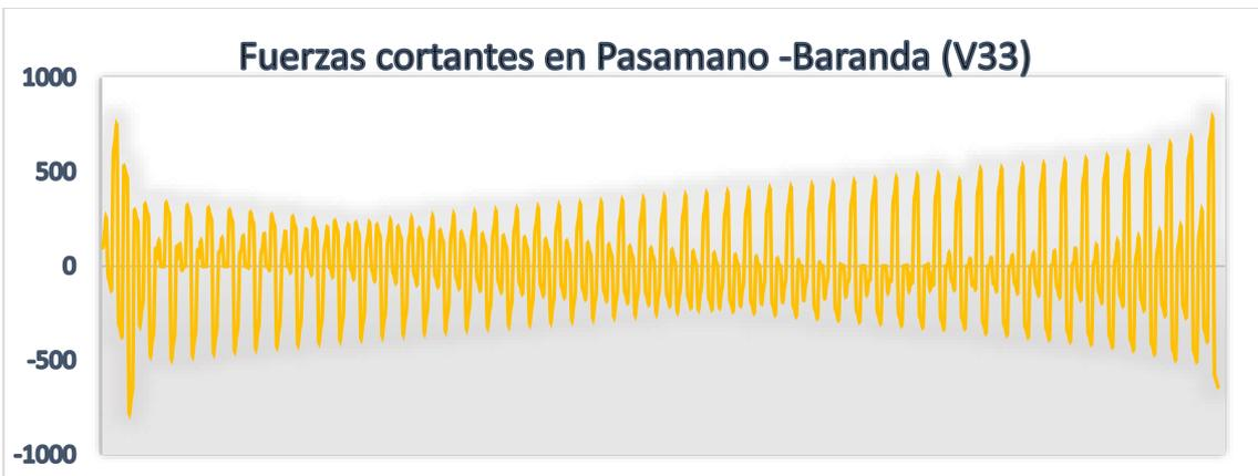
**Figura 35.** Diagrama de fuerzas cortantes – eje principal en Baranda
