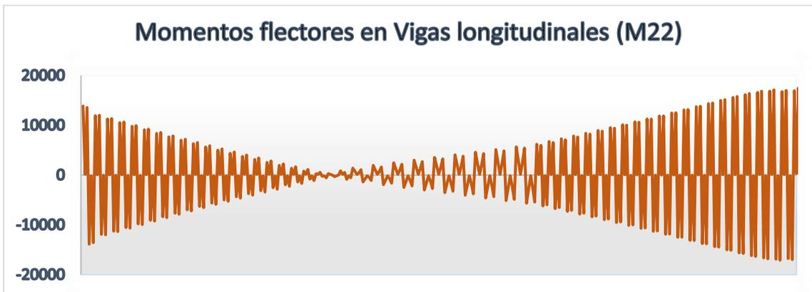
Figura 50. Diagrama de momentos flectores – eje secundario en Vigas L. centrales.
