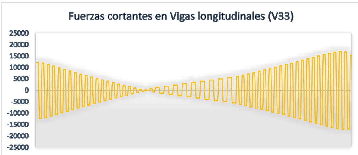
**Figura 53.** *Diagrama de fuerzas cortantes – eje principal en Vigas L. centrales*
