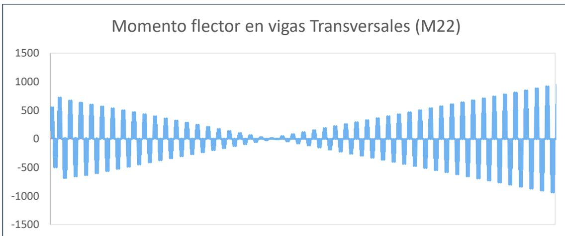
**Figura 27:** *Diagrama de momentos flectores – eje secundario en vigas Transversales*
