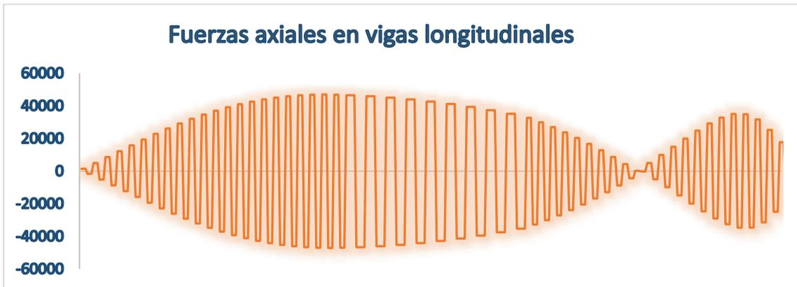
Figura 49. Distribución de Fuerzas Axiales en Vigas L. centrales.
