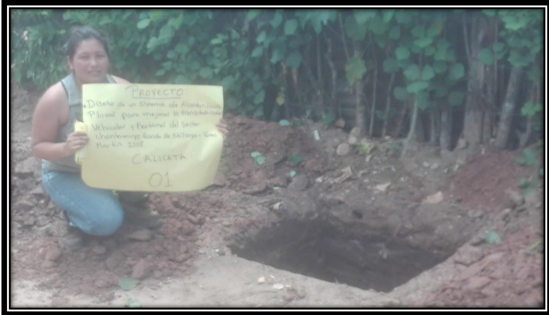
Se aprecia excavación de calicata N° 1 – Estratigrafía del suelo
