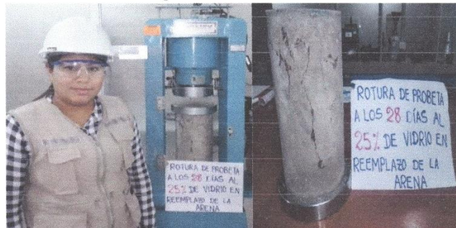
Rotura de probeta a los 28 días de edad.
