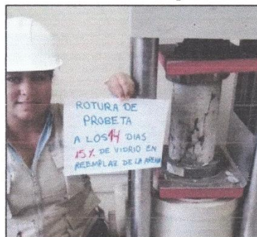
Rotura de probeta a los 14 días de edad.
