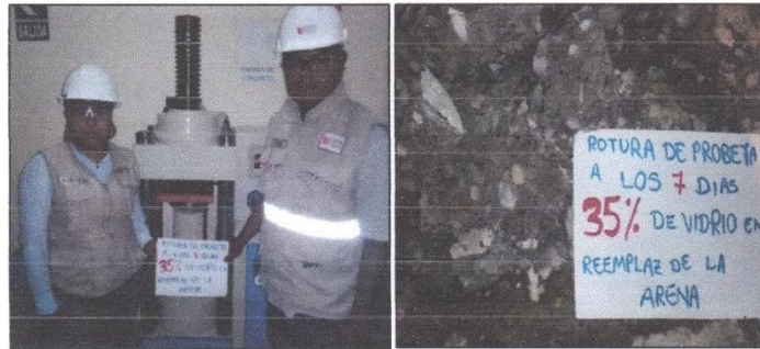
Rotura de probeta a los 7 días de edad.
