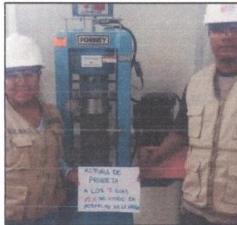
Rotura de probeta a los 7 días de edad.
