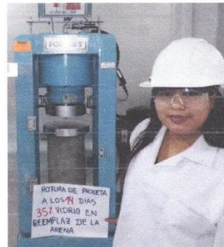
Rotura de probeta a los 14 días de edad.
