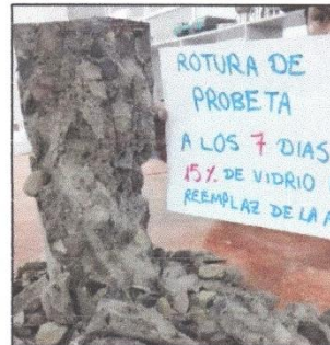
Rotura de probeta a los 7 días de edad.
