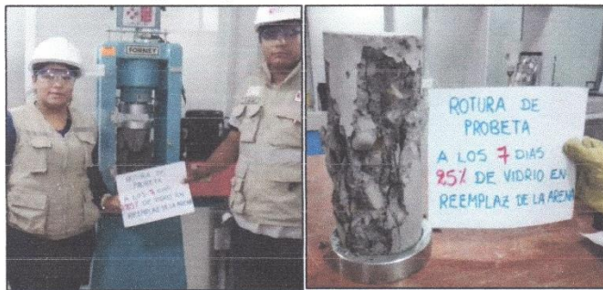
Rotura de probeta a los 7 días de edad.
