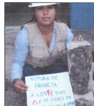
Rotura de probeta a los 14 días de edad.
