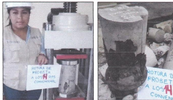
Rotura de probeta a los 14 días de edad.
