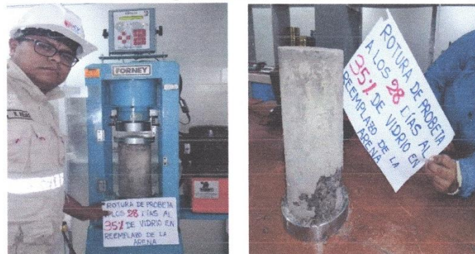
Rotura de probeta a los 28 días de edad
