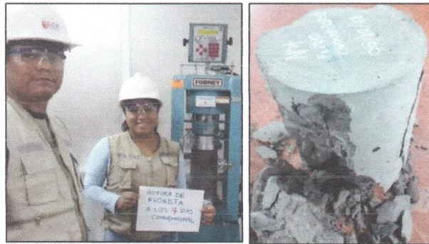
Rotura de probeta a los 7 días de edad.
