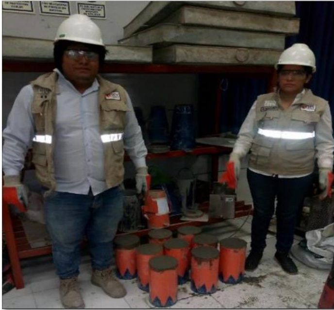
Ilustración 24: Preparación del probetas cilíndricas para ensayo de compresión.
