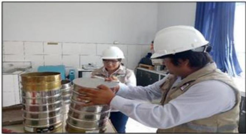
Ilustración 20: Tamizado de agregado de arena gruesa y piedra.
