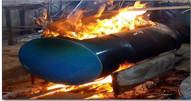
Ilustración 12. Calcinación del bagazo de caña de azúcar
