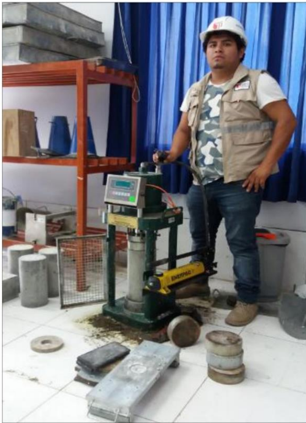
Ilustración 27: Ensayo de probetas cilíndricas por compresión.
