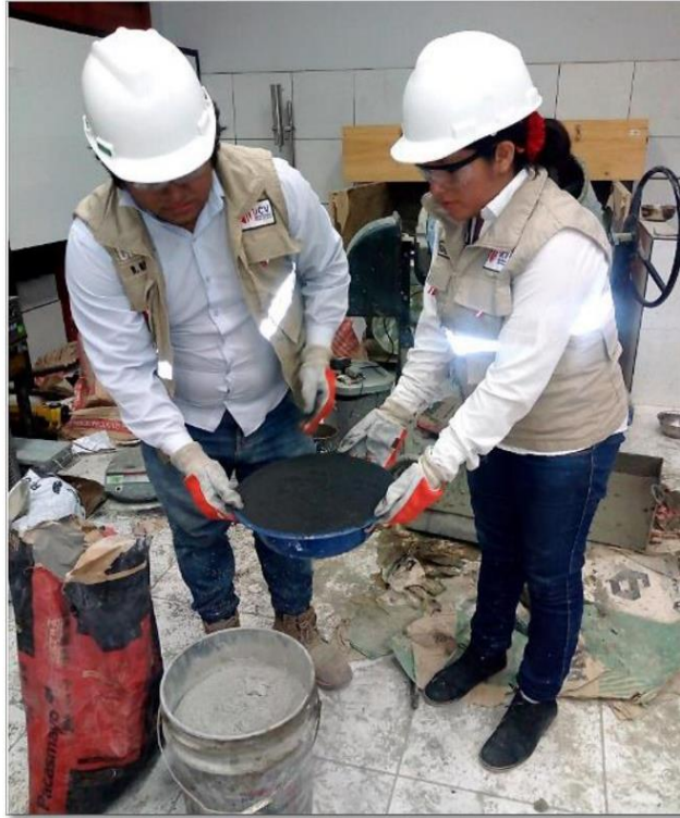
Ilustración 22: Mezcla de cemento y cenizas de bagazo de caña de azúcar.
