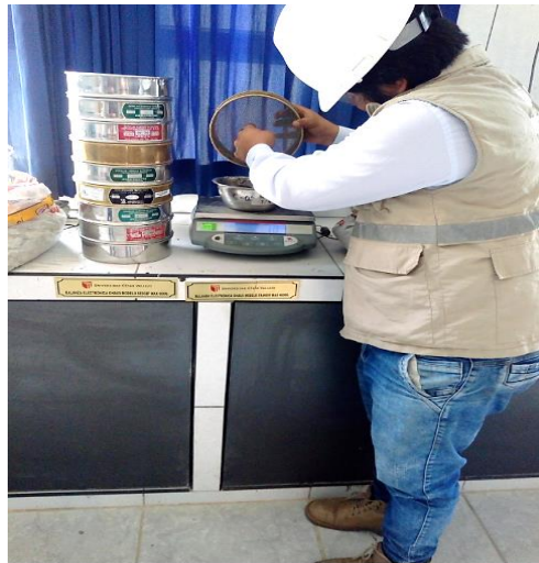
Ilustración 5. Pesaje de los agregados contenidos en las mallas
