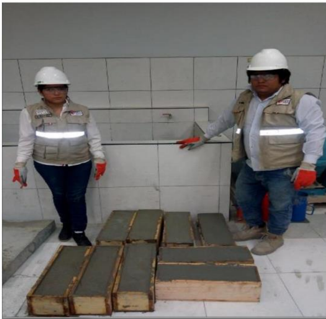
Ilustración 25: Preparación de vigas para ensayo de flexión.
