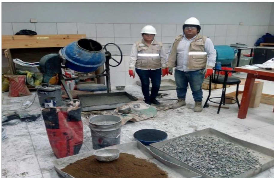
Ilustración 23: Preparación del concreto con adición de cenizas de caña de azúcar.
