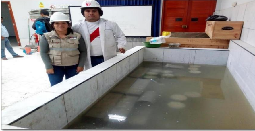
Ilustración 26: Curado de probetas cilíndricas y vigas.
