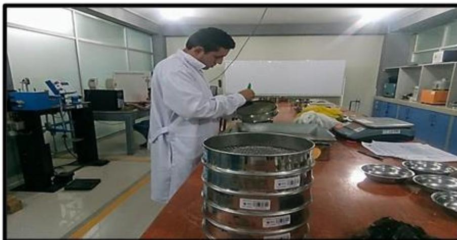
**Foto N°09.** Ensayo de análisis granulométrico.
