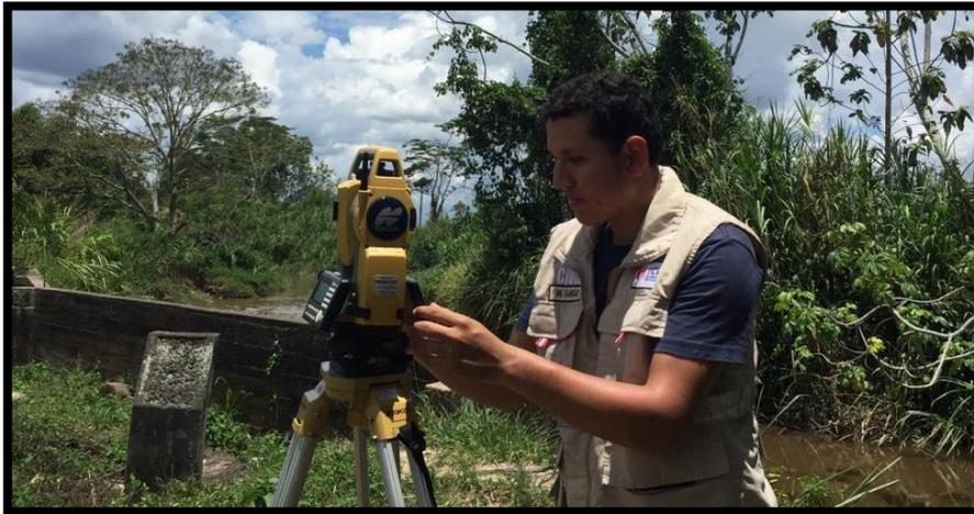
Foto N°07. Ubicación de la estación total en el punto E – 01 georreferenciado.
