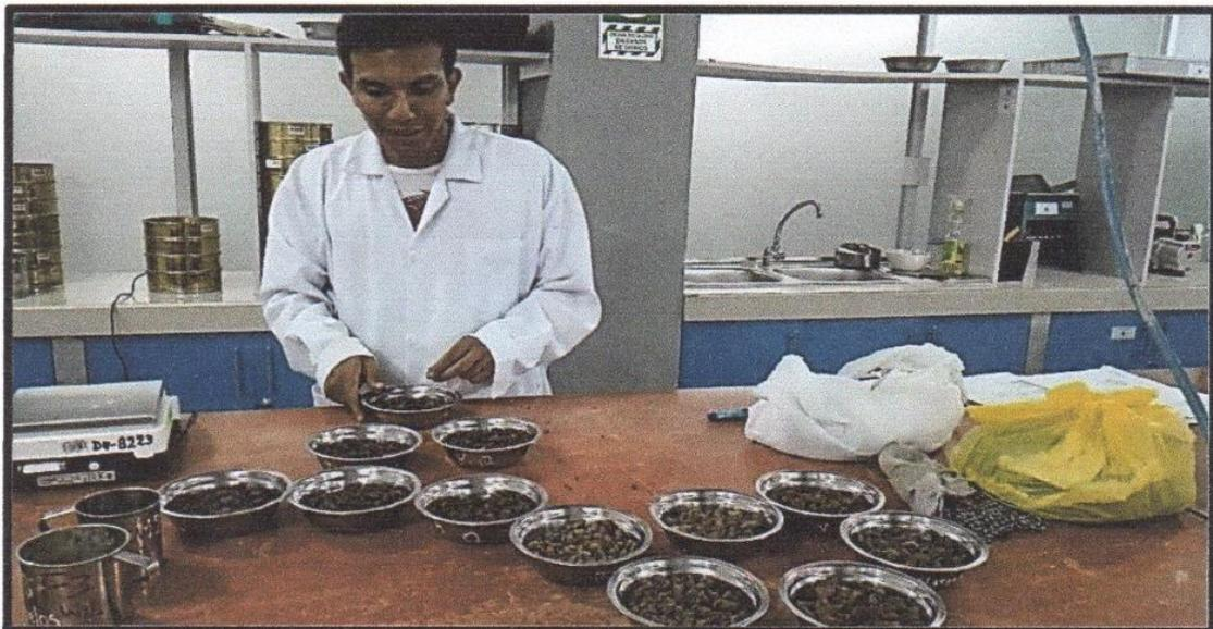
Foto N°02. Ensayo de humedad natural de las muestras.
