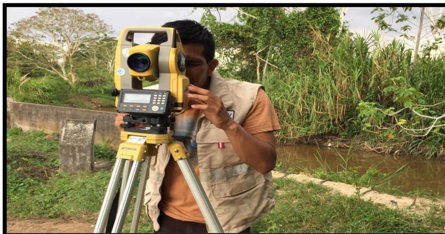
Foto N°09. Levantamiento de puntos topográficos con el uso de la estación total.
