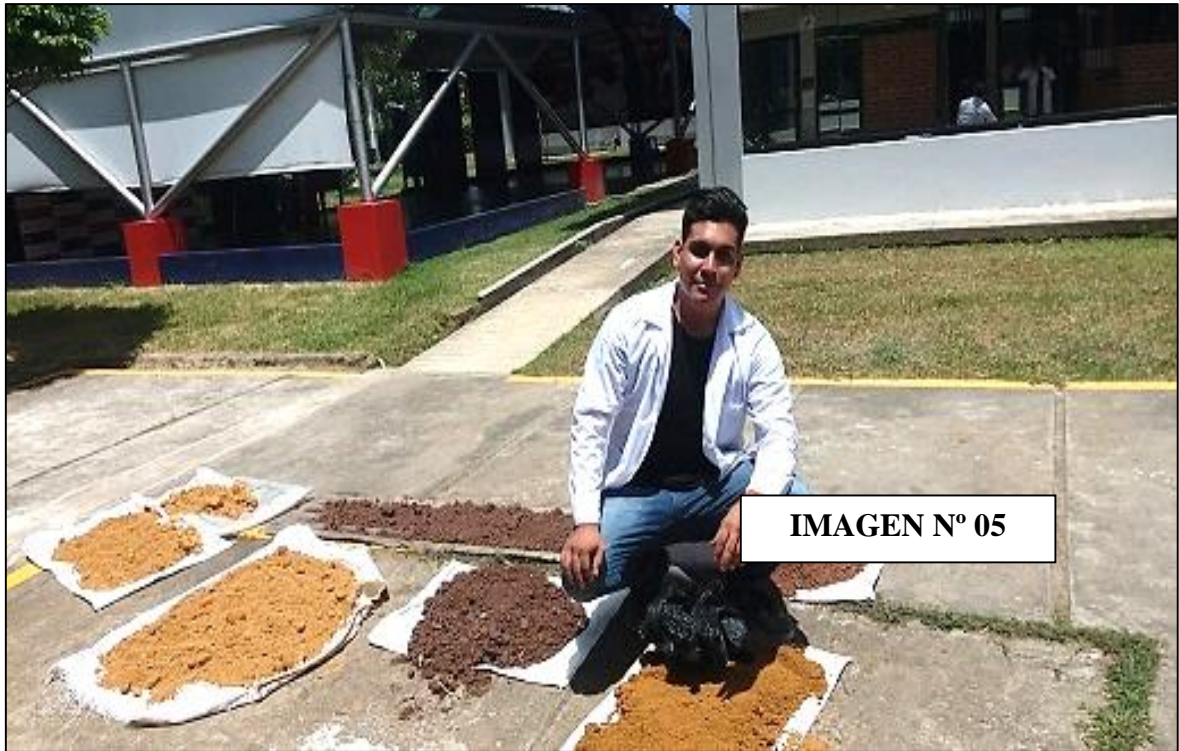
En la fotografía N° 05 se aprecia al tesista junto a la muestra extraída de las calicatas de las zonas de estudio pasando por el proceso de secado a natural durante 48 horas.
