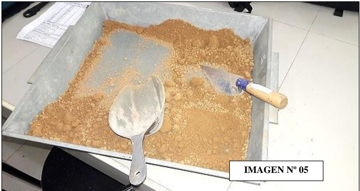
En la imagen N° 05 se aprecie la muestra que se usara para el ensayo de contenido de humedad natural.
