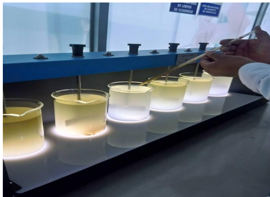
Imagen 4. Inyección de la solución de almidón de dale dale
