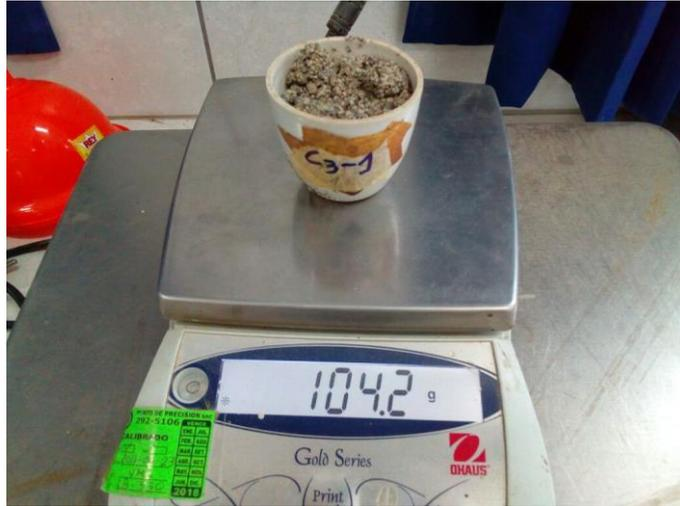
Muestra lista para el horno y obtener su contenido de humedad
