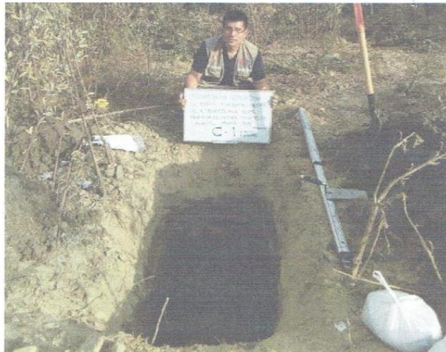
En la imagen se aprecia la realización de la calicata para la toma de muestra a una profundidad de 1.00 m
