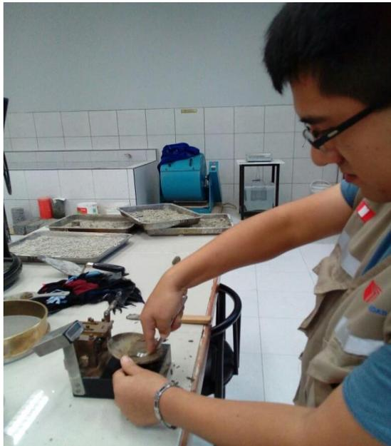
Realizando el ensayo de copa de casa grande para el contenido de humedad
