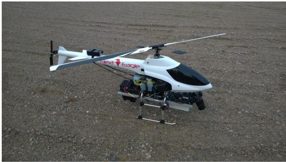
Imágen 2. Imágenes de un estudio de caso de aviones no tripulados para inspecciones de líneas eléctricas en las líneas de que distribuyen la energía en 20 kV. Finlandia
