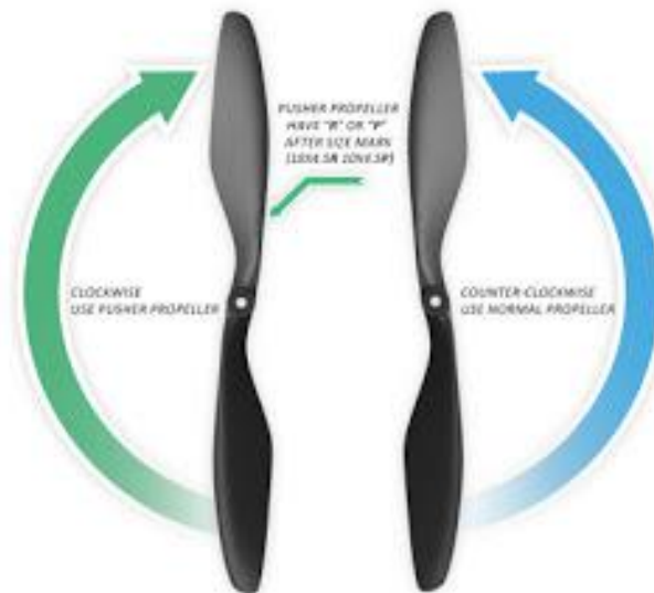
Imágen 25 helices horarias y antihorarias
