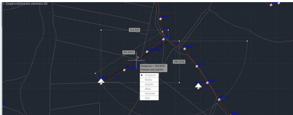
Imágen 10 Distancia entre la línea a la sub estación
