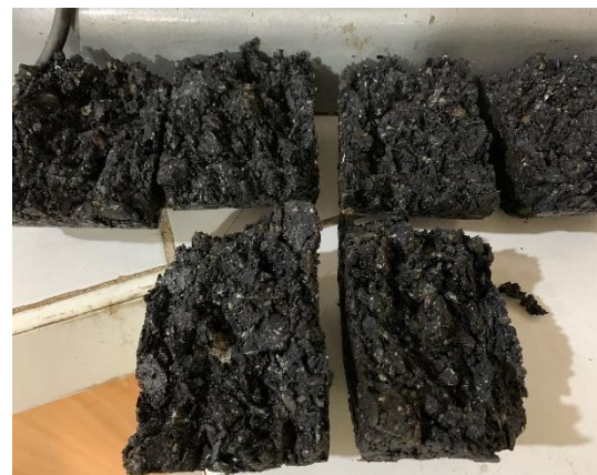
Rotura de briquetas
