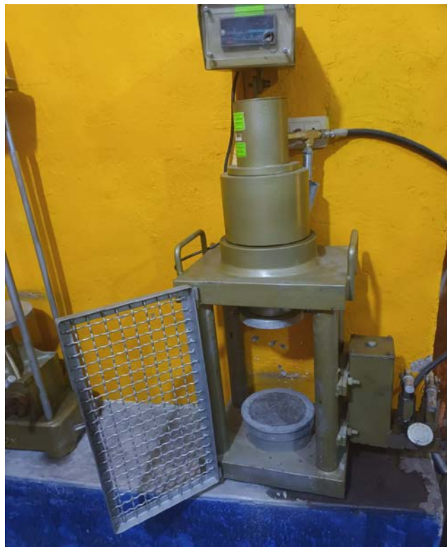
Figura 32. Prensa Hidráulica usada en ensayo a la compresión.
