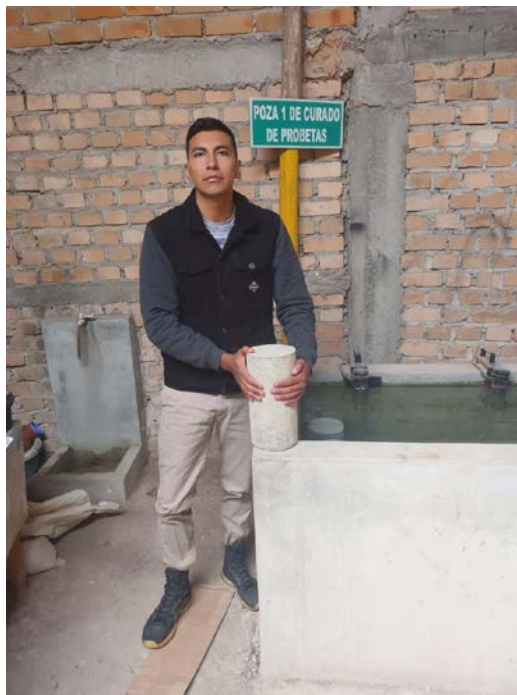
Figura 34. Espécimen de prueba siendo introducido al pozo de curado.
