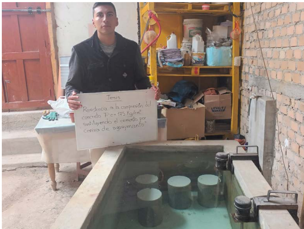
Figura 36. Tesista junto a especímenes de prueba en poza de curado.
