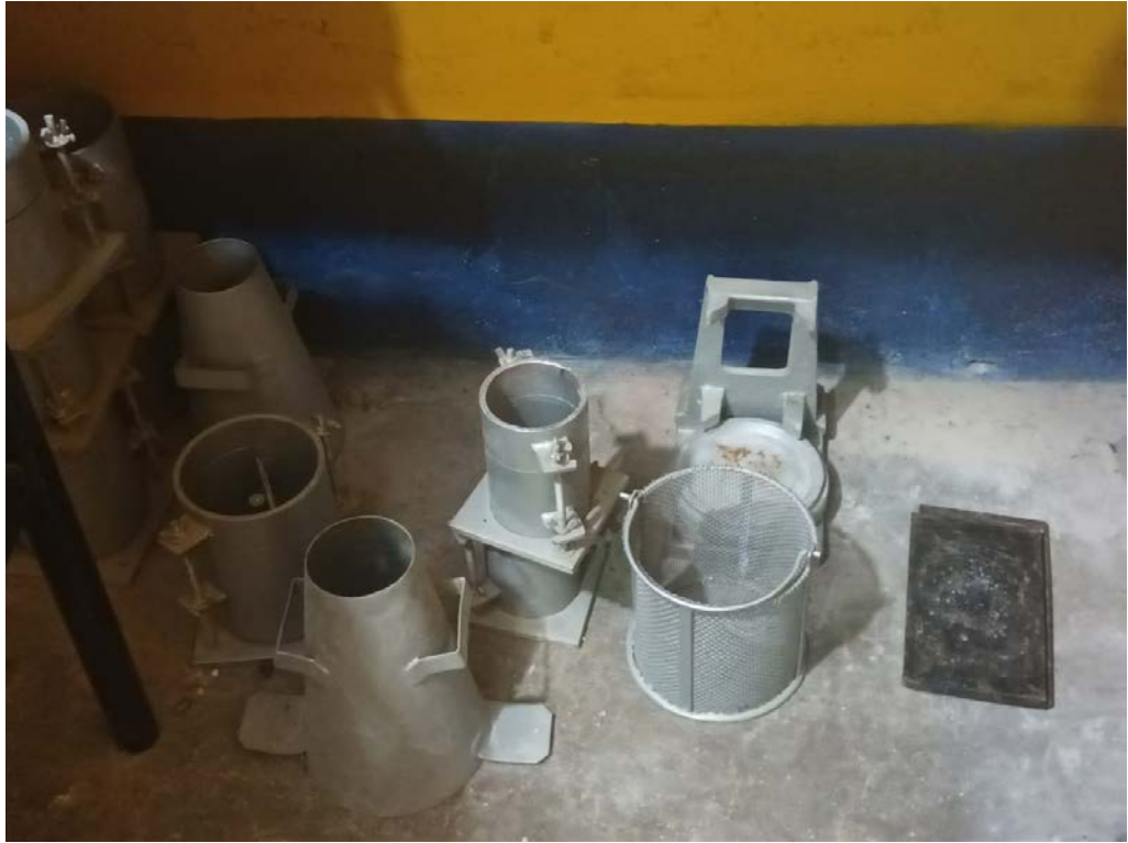
Figura 31. Moldes para pruebas de calidad del concreto.
