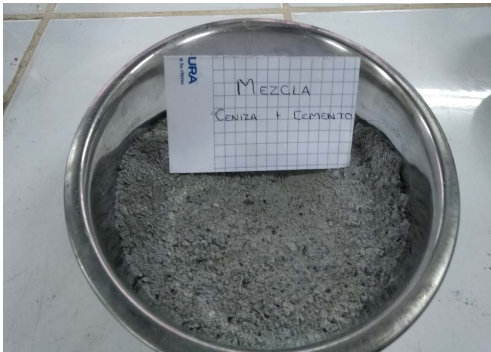
Figura 24. Mezcla de Ceniza de Aguaymanto y Cemento. Fuente: Elaboración propia.
