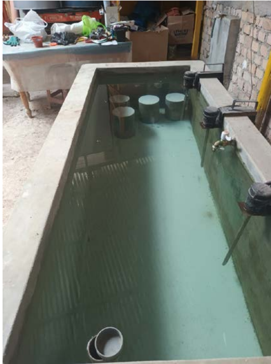
Figura 35. Especímenes de prueba en poza de curado.
