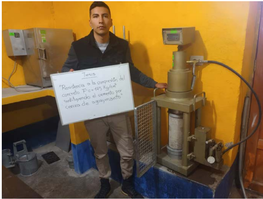
Figura 37. Ensayo de compresión a especímenes elaborados.
