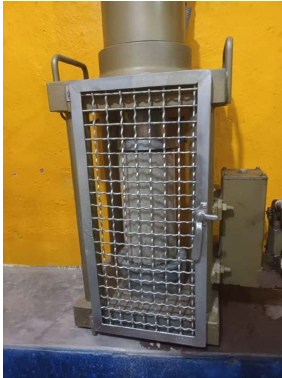
Figura 33. Prensa Hidráulica con espécimen de prueba.
