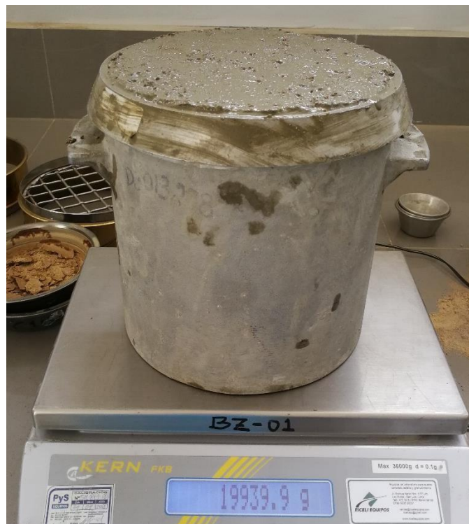
Figura 30: Peso del recipiente con el C.P para el cálculo del P.U.C.F
