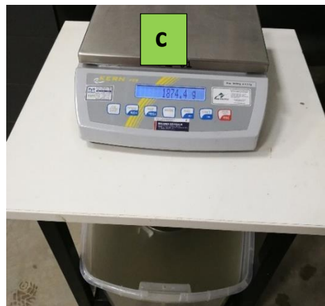
Figura 16: Procedimiento del ensayo de peso específico y absorción del agregado grueso.
