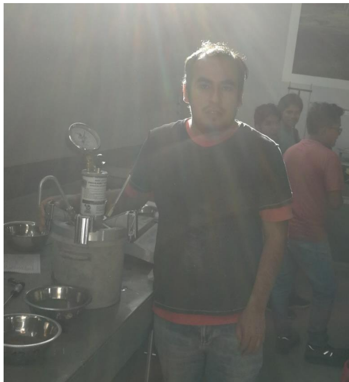
Figura 36: Olla de Washington para lectura del contenido de aire del concreto fresco.
