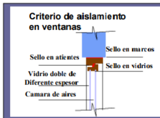
Figura 15. Aislamiento en ventanas
