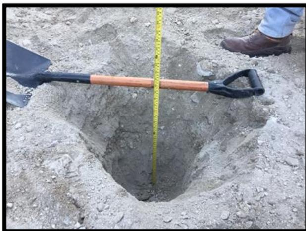
Figura 69. Calicata del suelo inadecuado (ceniza volcánica)
