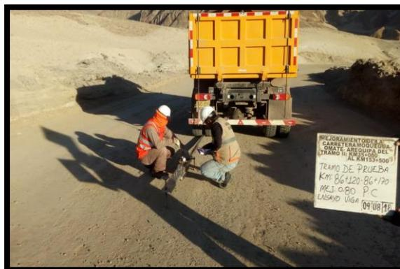
Figura 46. Ensayo de deflectometría Km. 86+120 - 86+170.
