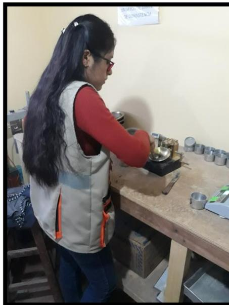
Figura 78. Ensayo de Límites.
