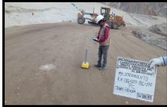
Figura 41. Ensayo de compactación, mediante el densímetro nuclear.
