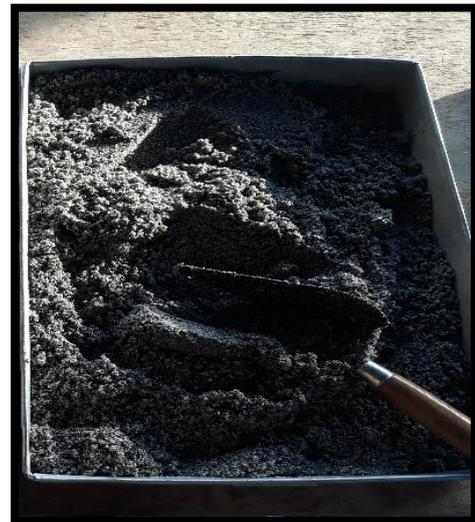
**Figura 83. Ceniza volcánica, adicionando agua.**
