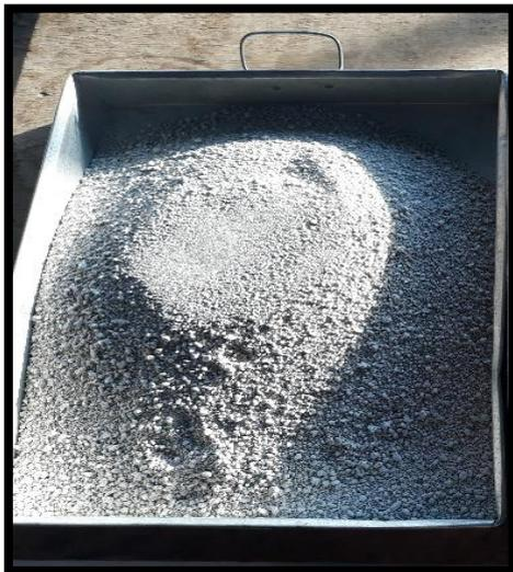
**Figura 84. Suelo inadecuado (ceniza volcánica).**
