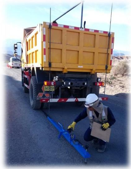
**Figura 7: Ensayo de deflectometría con la viga Benkelman**
