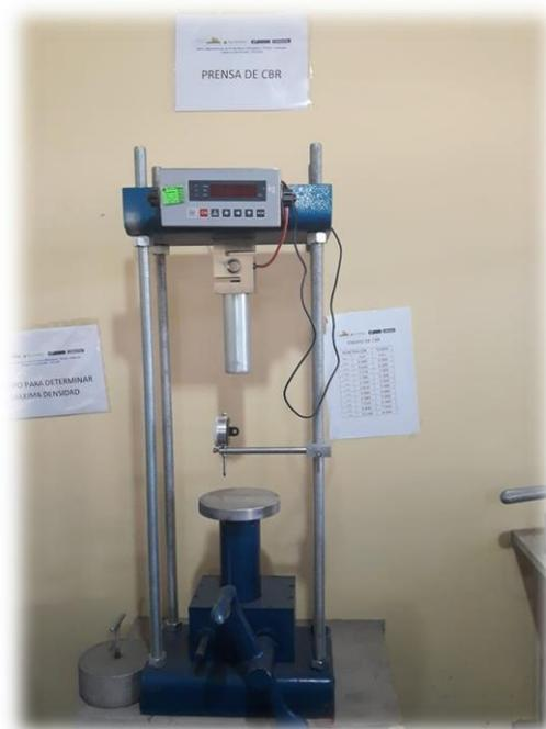
Figura 8: Ensayo de la prensa de C.B.R
