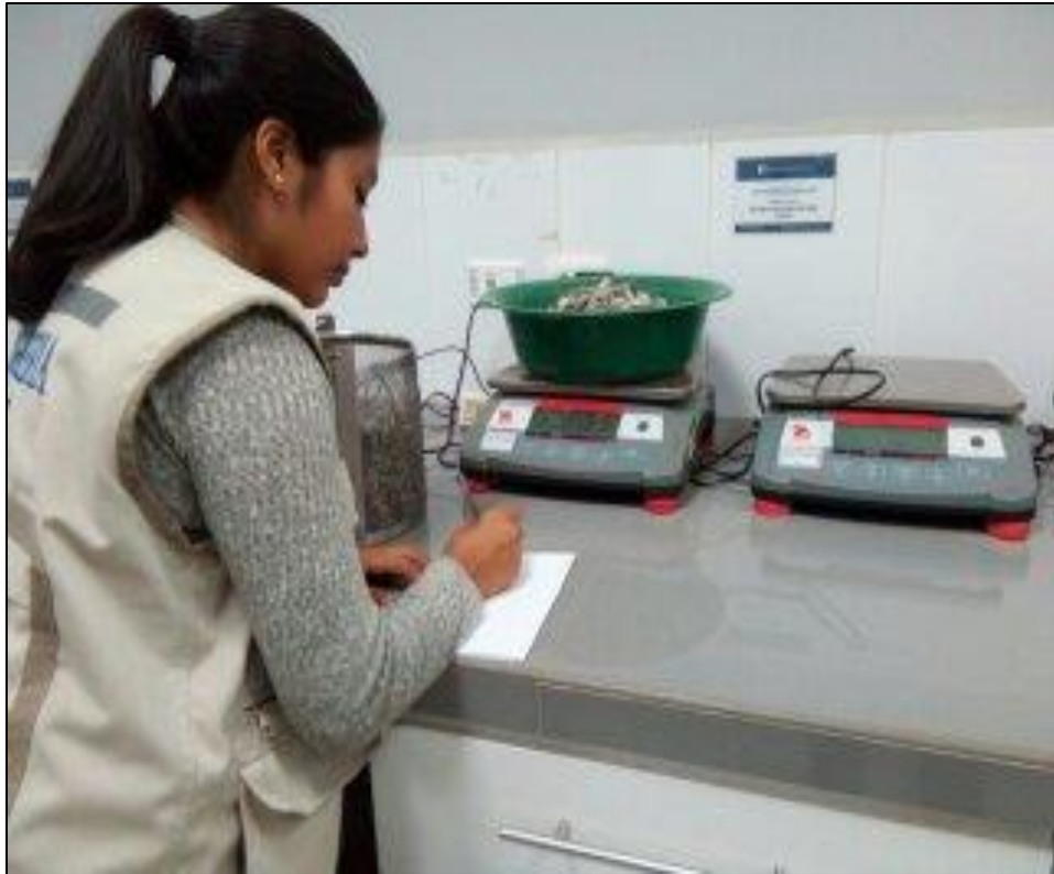
FOTO 5: Peso de materiales (ensayo de peso específico)
