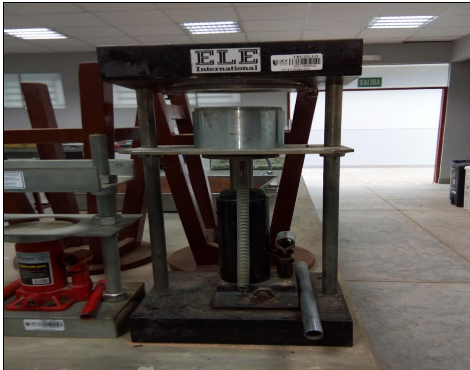
FOTO 15: Maquina de extracción de probetas
