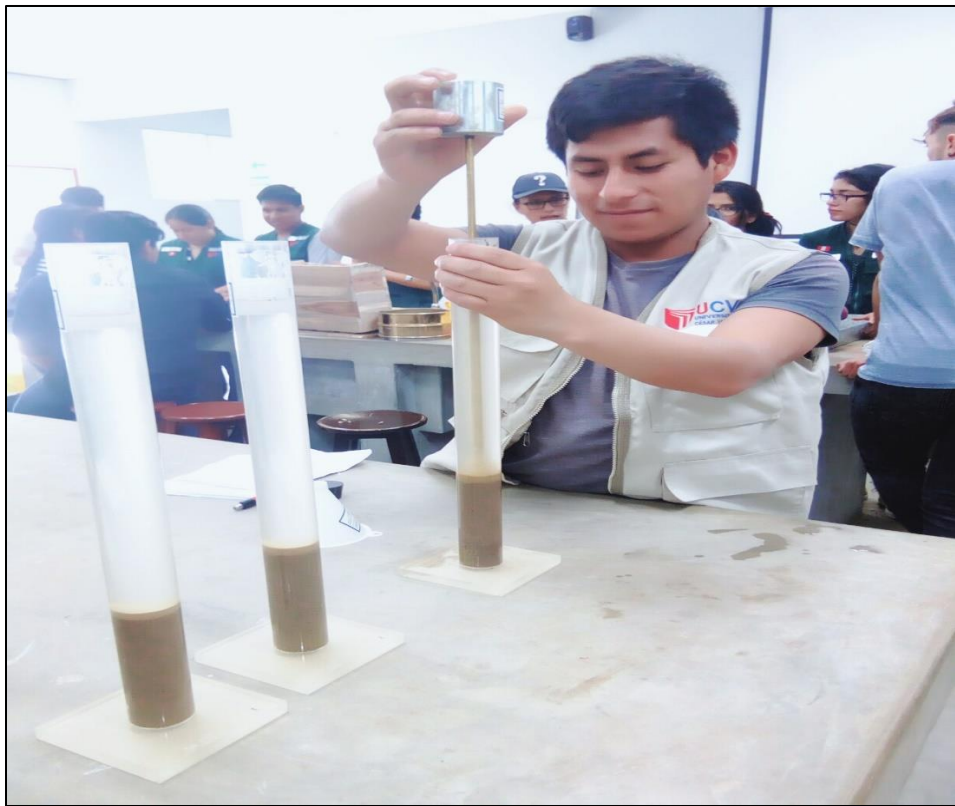
FOTO 8: Ensayo equivalente de arena
