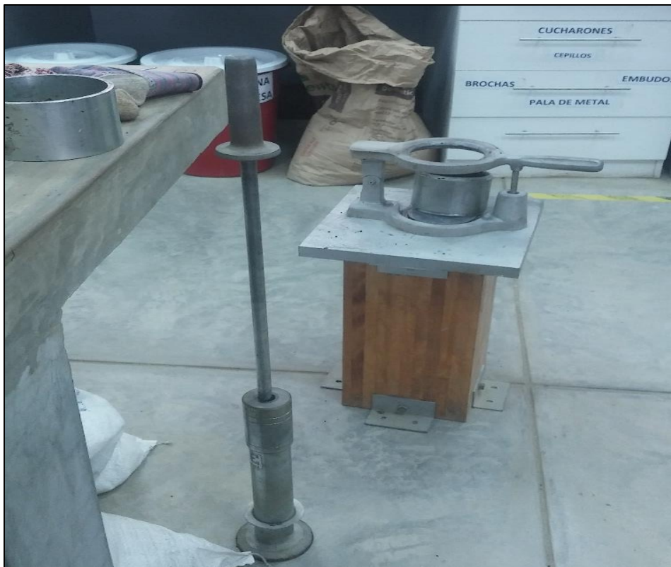
FOTO 12: Equipo de compactación de briquetas
