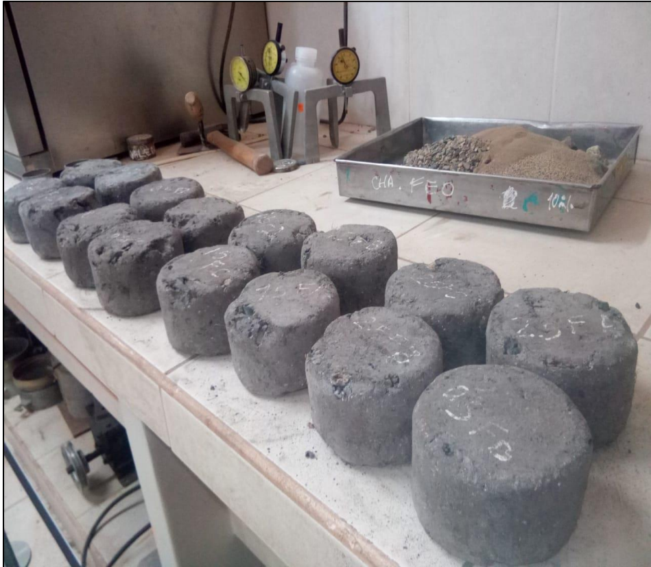
FOTO 18: Briquetas ensayadas a 300 rv en la máquina de los Ángeles
