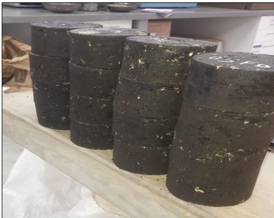
FOTO 14: Briquetas con (0.5, 1.5, 2.5 % de fibra de polipropileno)
