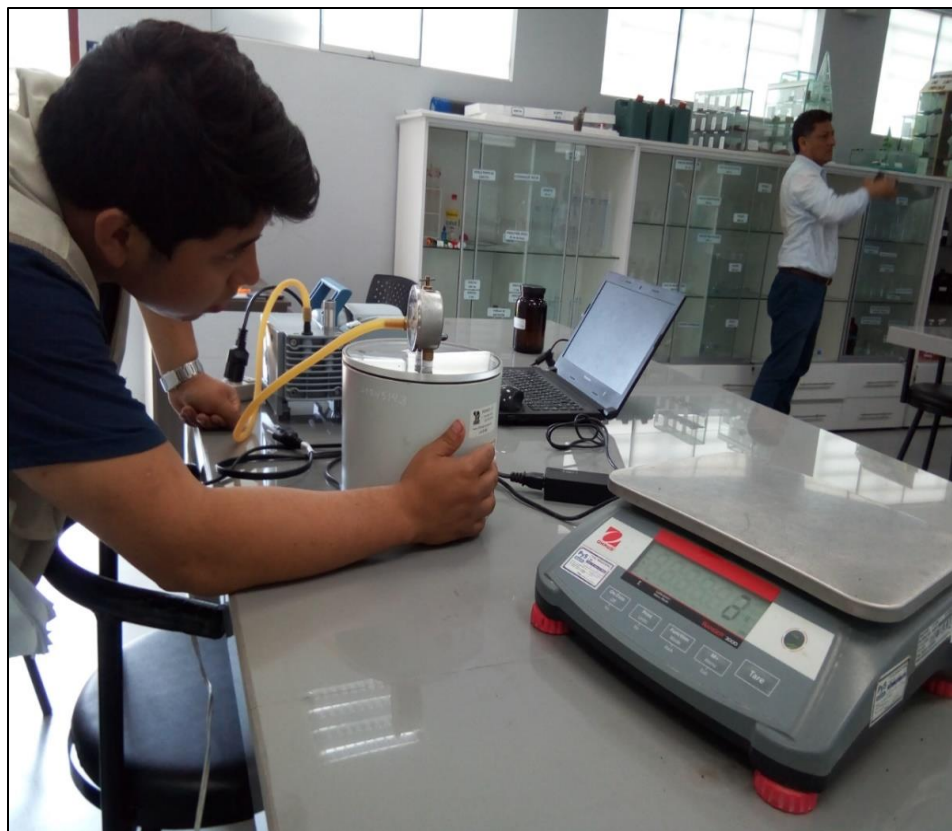
FOTO 10: Ensayo densidad máxima aparente (Rice)
