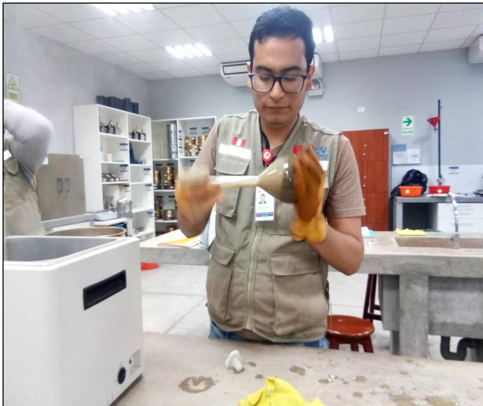
FOTO 6: Ensayo de gravedad específica
