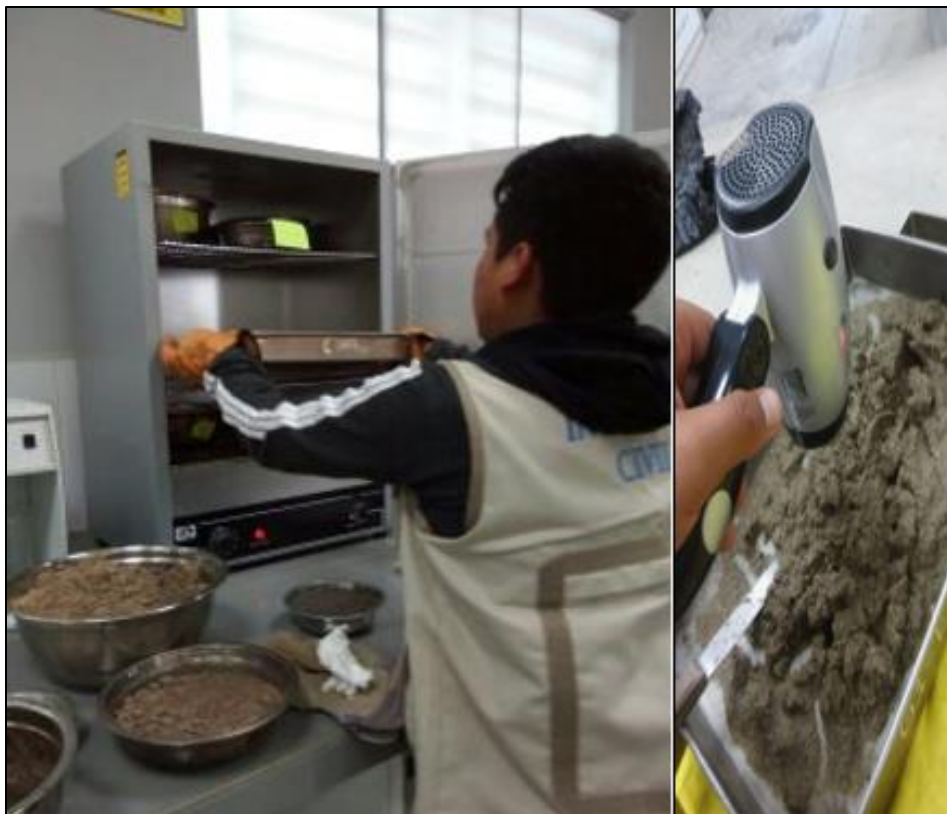
FOTO 4: Secado de materiales (ensayo de % de absorción)
