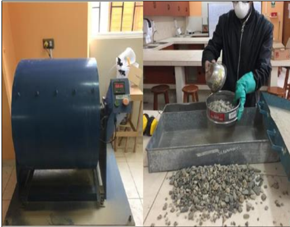
FOTO 9: Ensayo de abrasión de Ángeles agregado grueso
