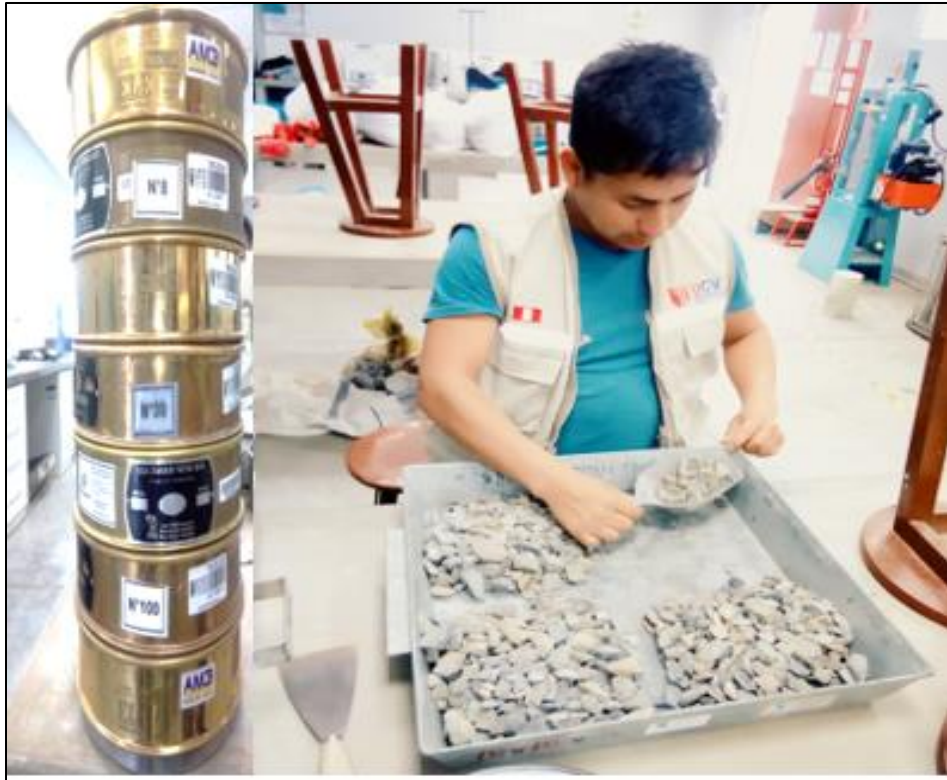
FOTO 3: Cuarteo de material (análisis granulométrico)
