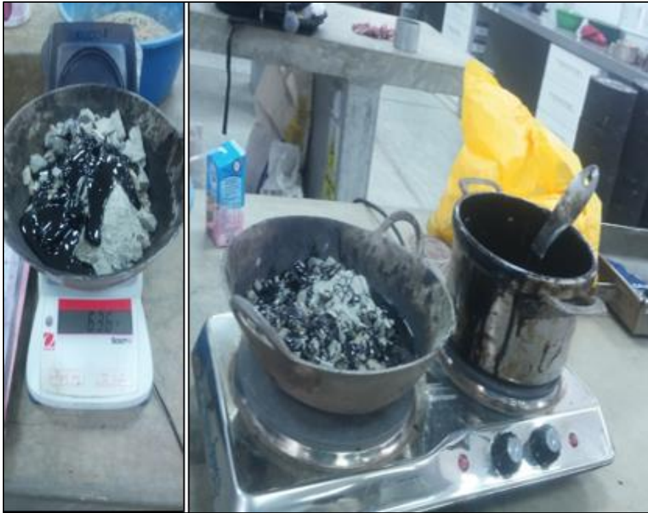
FOTO 11: Preparación de la mezcla asfáltica
