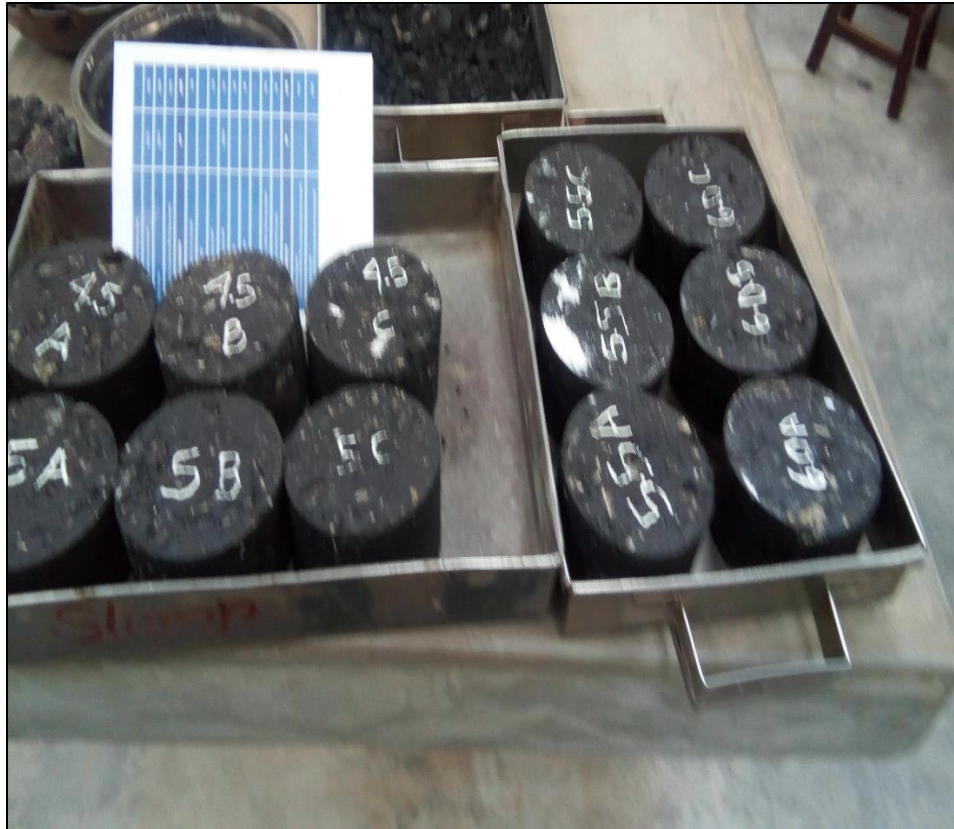
FOTO 13: Briquetas con 4.5, 5.0, 5.5, 6.0 % de cemento asfaltico
