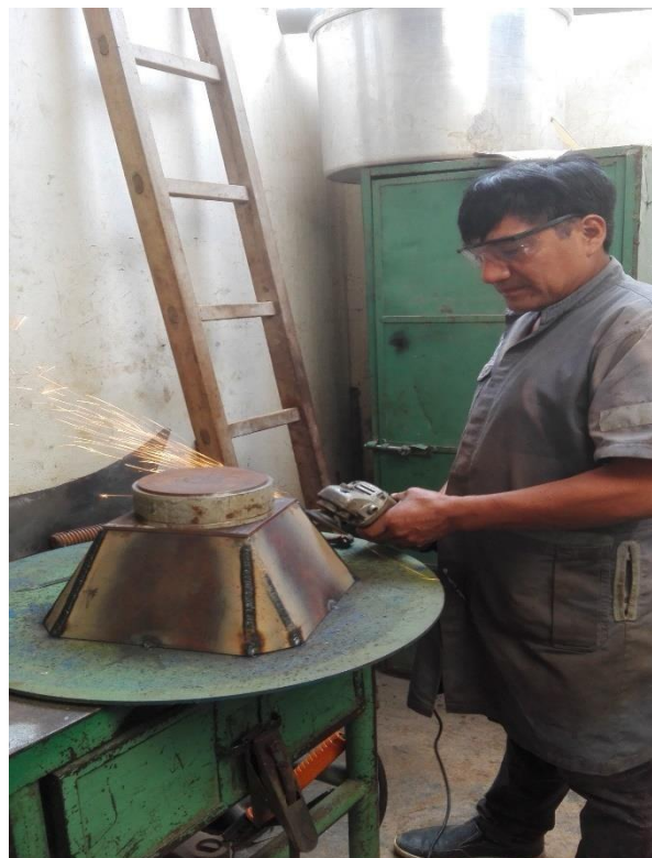
Realizando acabado con amoladora eléctrica de mano
