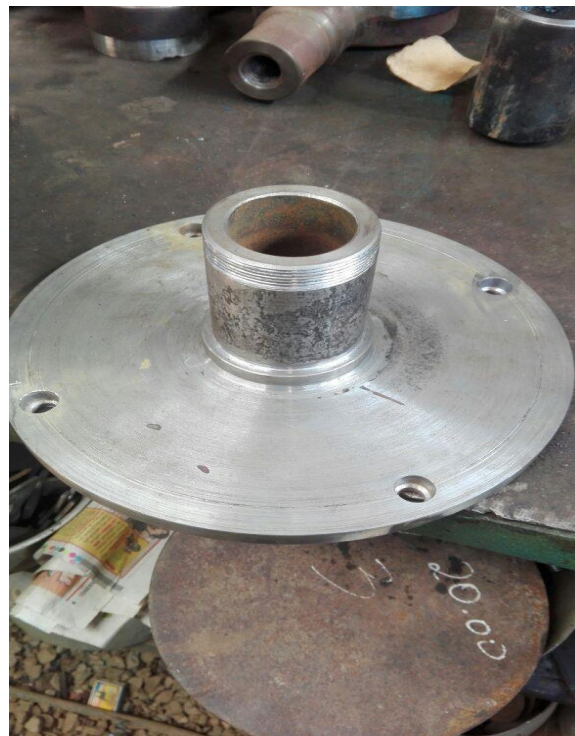
Pieza unida con soldadura de arco y mecanizada en torno paralelo
