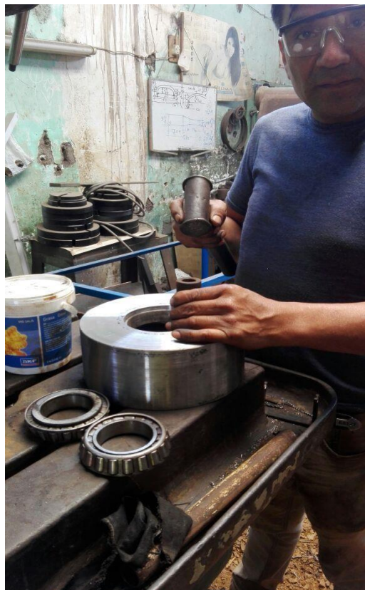
Ensamblaje de los rodamientos.
