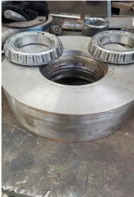
Pieza mecanizada y los rodamientos de rodillos cónicos
