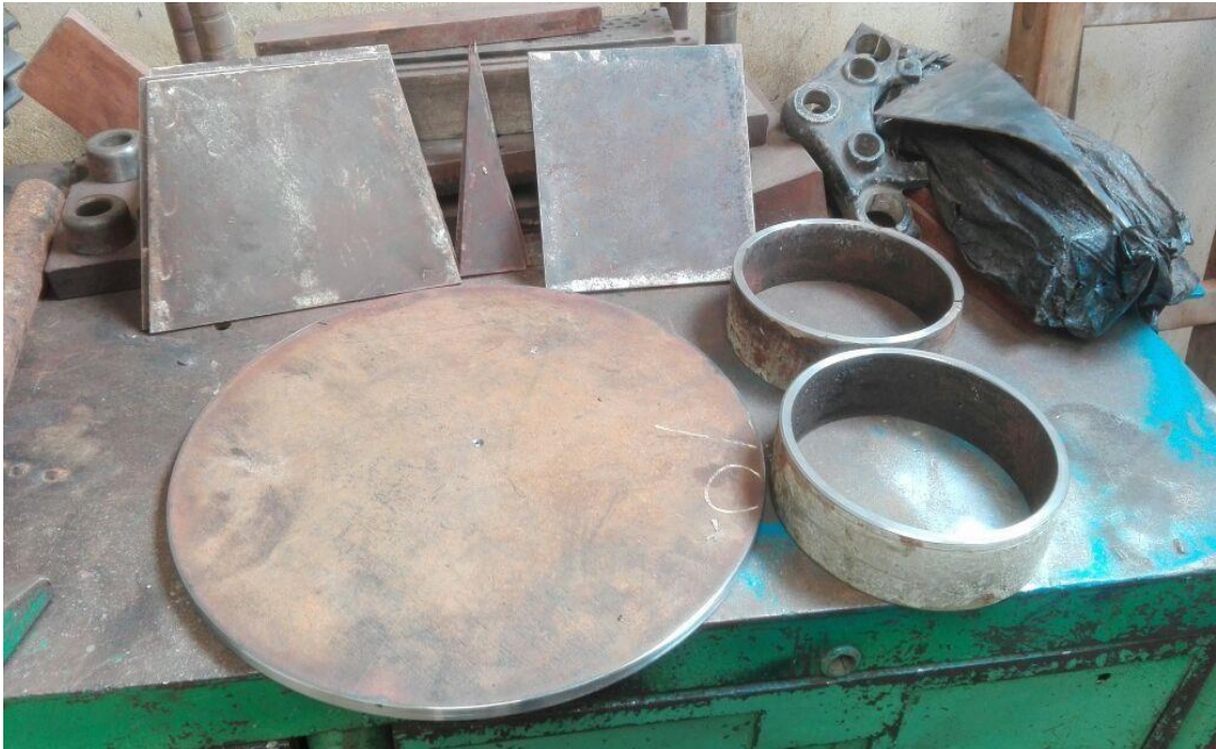
Placas de acero A36 para la estructura de la base.
