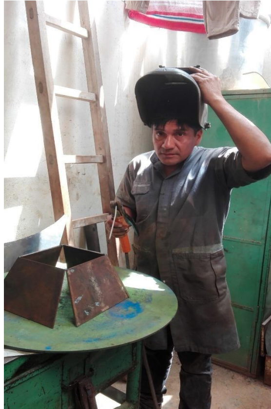
Aplicando soldadura de arco con electrodo aws 7018 (supercito).
