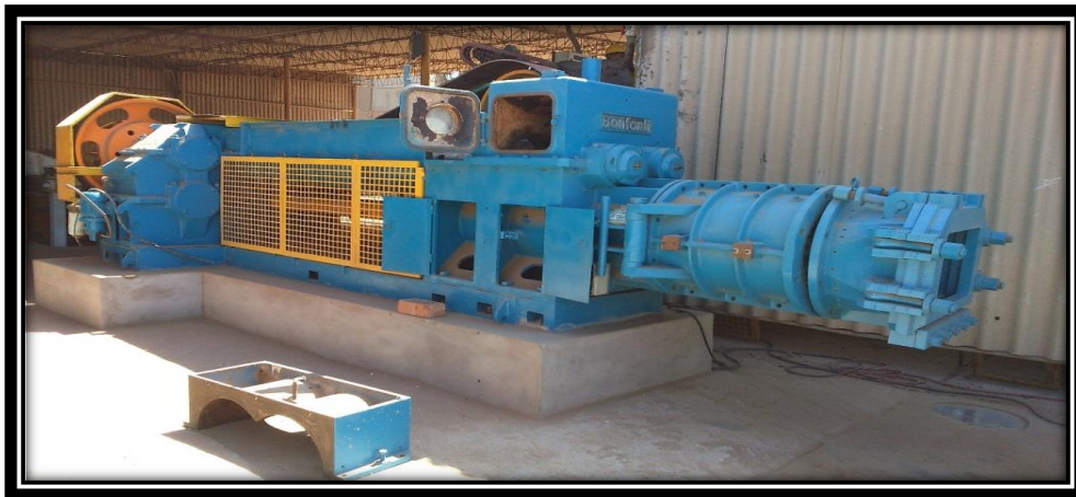
Maquina extrusora donde se realiza el moldeado del ladrillo
