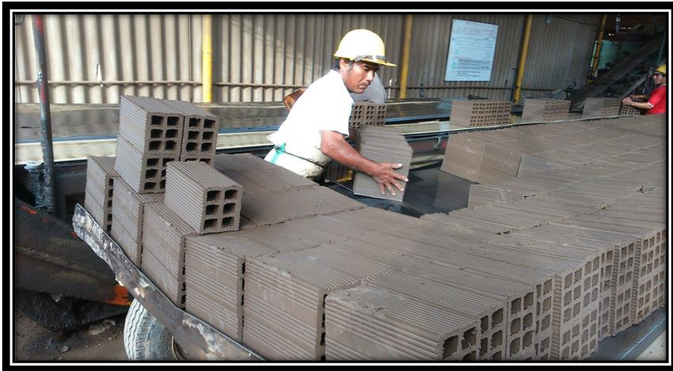
Operario apilando en carretas el ladrillo recién moldeado.
