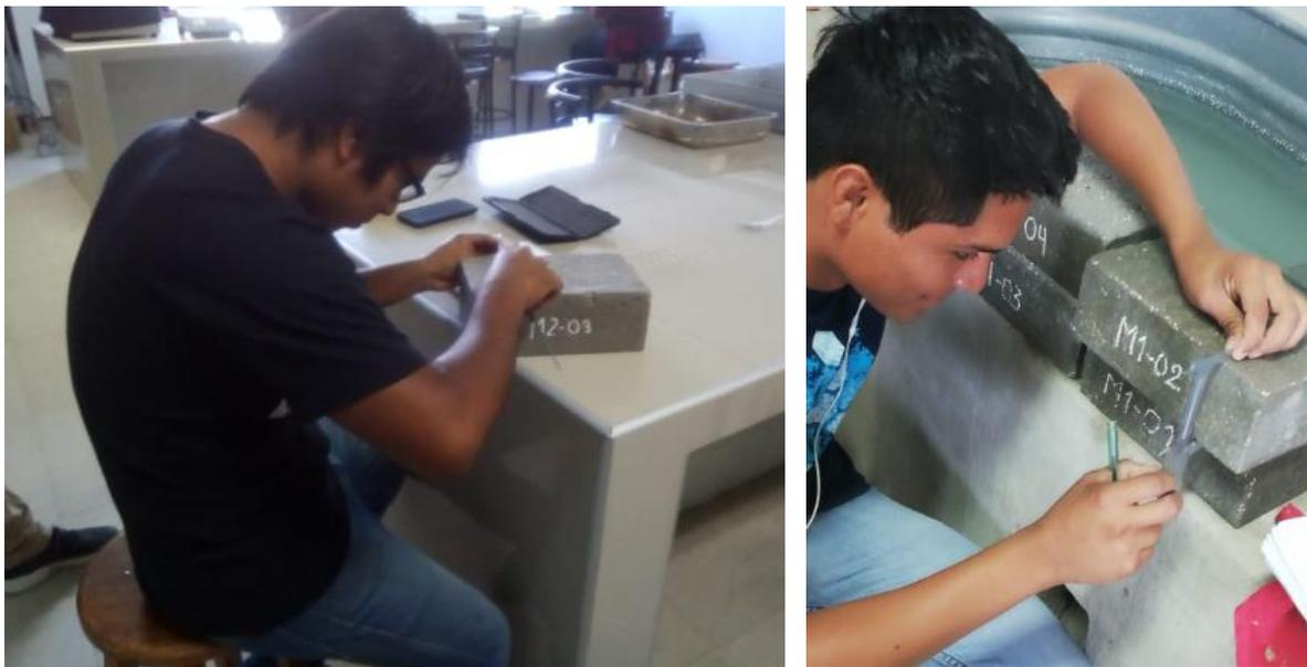
Se realizó el ensayo de variación dimensional con la ayuda de una regla milimetrada.
