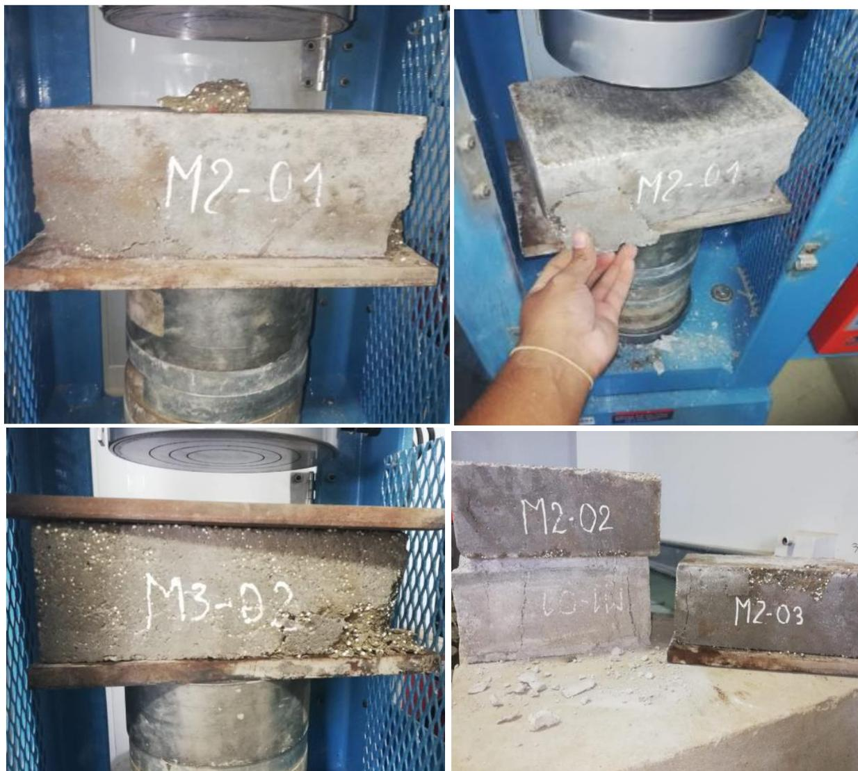
Se ensayaron 4 unidades a los 7, 14 y 28 días respectivamente, siendo un total de 12 unidades las que fueron sometidas a este ensayo, como se observa en la figura los especímenes fueron colócalos sobre unas planchas de fierro de ½” de espesor, para que la carga a la que la somete la prensa de distribuya equitativamente.
