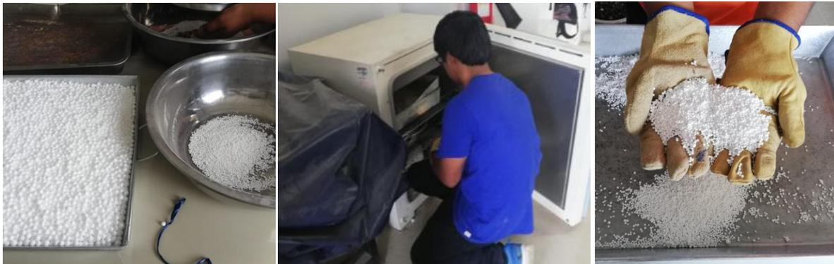
se logró el cambio de densidad del Poliestireno expandido mediante la colocación de bandejas metálicas con Poliestireno a un horno eléctrico a una temperatura de 130 °C durante 30 min.
