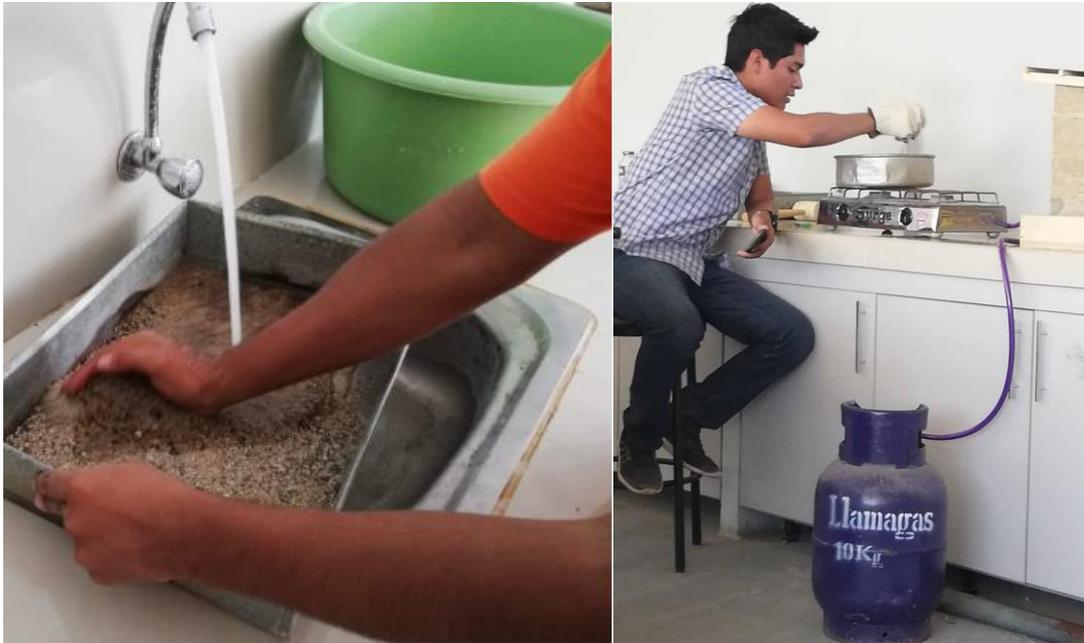
Se llevó a cabo el lavado del agregado fino que consiste en eliminar todas las impurezas que el agregado pueda tener y posteriormente secar el mismo en una estufa a gas.
