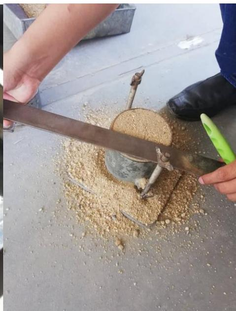
**Fotografía 07:** *Calculo de Densidad del Poliestireno Expandido.*
