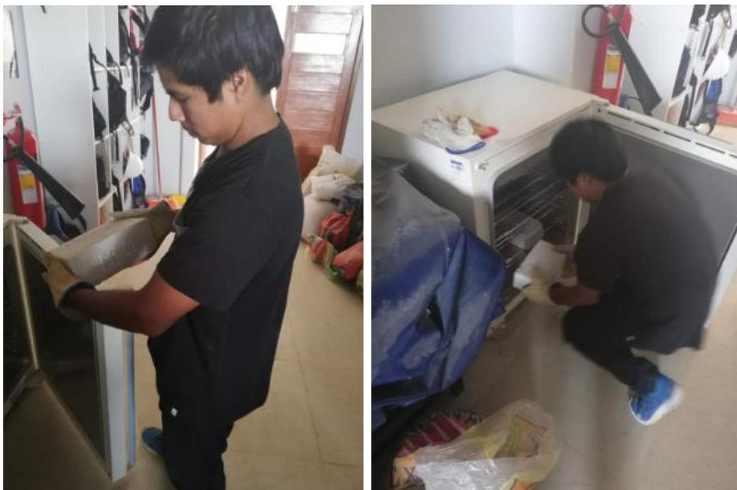
Para este ensayo se saturó con agua la unidad, posteriormente se colocó en el horno a una temperatura de 110 °C durante 24 horas, después de esto tomo el peso de la unidad secada al horno para poder determinar el % de absorción.
