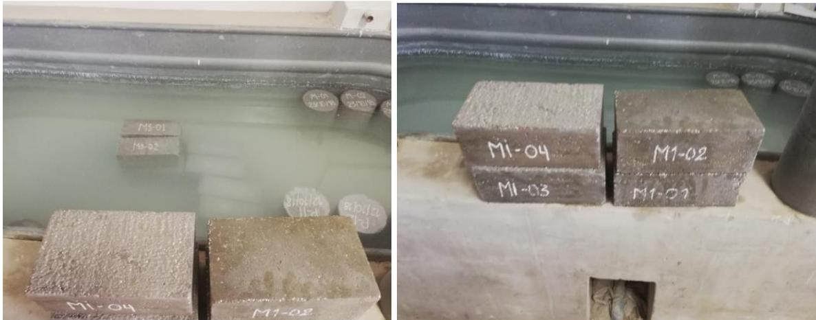
Después de desencofrar las unidades, se procedió con el curado, sumergiendo las unidades en agua durante 7 – 14 – 28 días de sumergidos para proceder con el ensayo de esfuerzo a la compresión.
