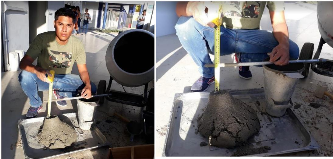
Este ensayo se realizó con la ayuda del instrumento del cono de Abrams, el cual nos arrojó un slump de 4.5”.
