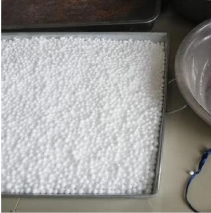
Se corrobora la densidad del Poliestireno expandido adquirido, mediante la relación de peso sobre volumen con la ayuda de una bandeja metálica y una balanza.
