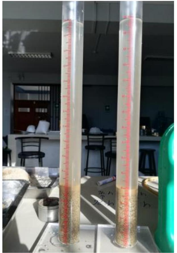
**Fotografía 06:** *Ensayo de Peso Unitario del Agregado Grueso*
