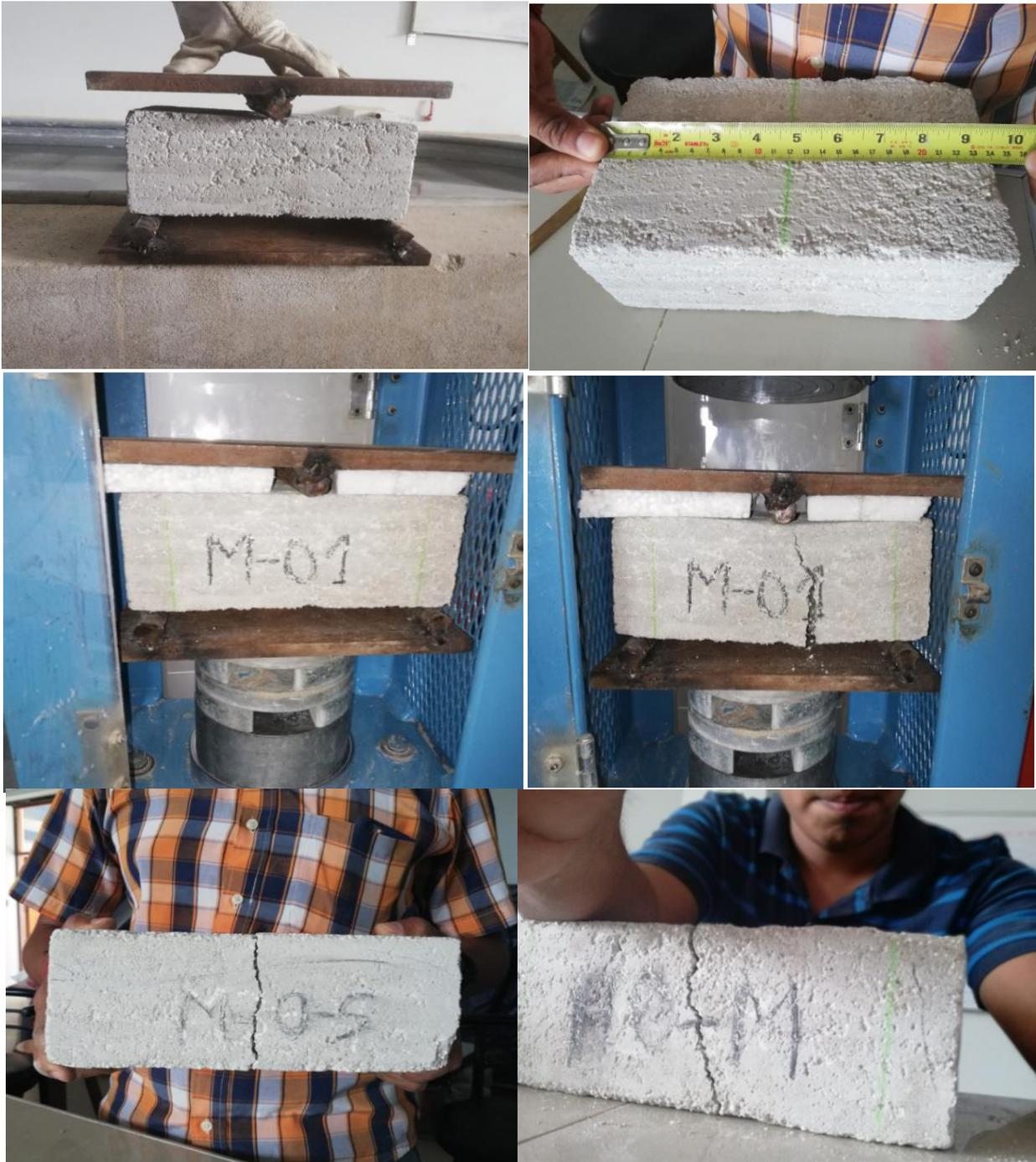
Para este ensayo se modificaron las placas de tal manera que funcionen como dos apoyos en la base de la unidad y una carga puntual en la parte superior que actúa en el eje de la misma.
