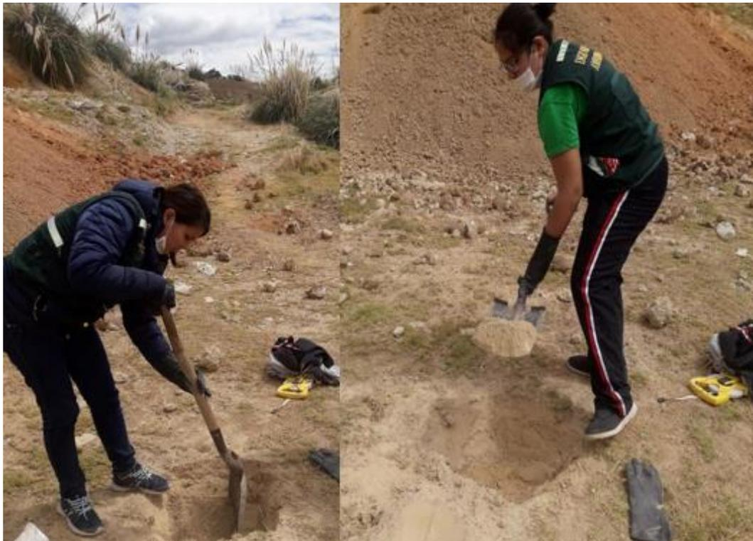
**Foto 11: Extracción de la muestra de suelo**
