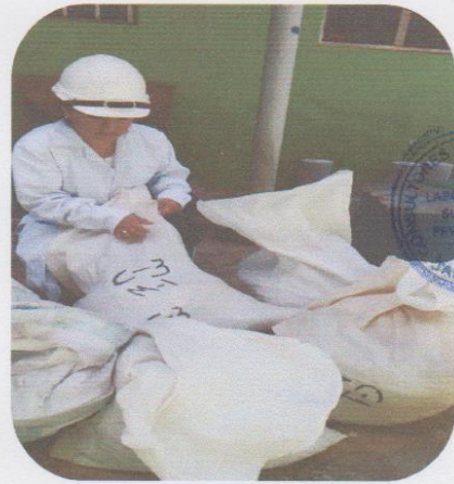
Se observa a la tesista realizando la verificación de todas las muestras extraídas de las calicatas en campo
