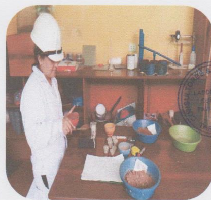
Se observa a la tesista realizando el ensayo de Limite Liquido
