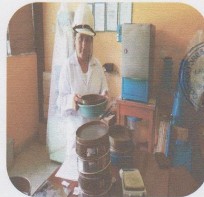
Se observa a la tesista realizando el ensayo del Análisis Granulométrico
