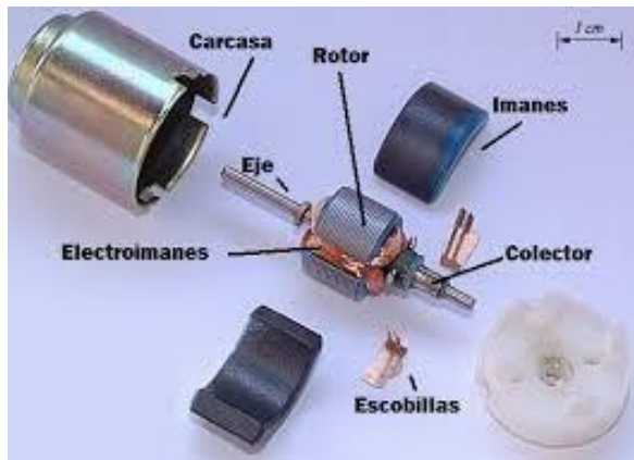
Figura 1: Partes de un motor de corriente directa Fuente: geekbotelectronics.com
