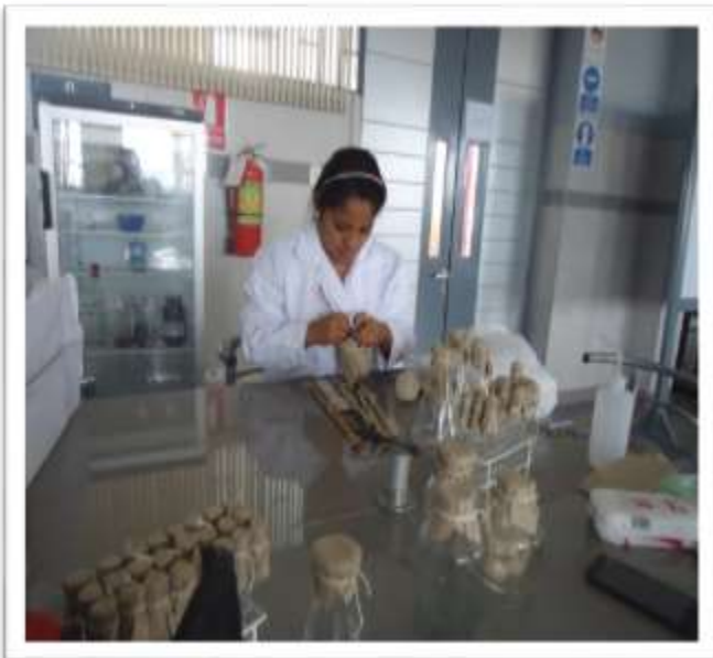
Figura 10: Envolvimiento de materiales con papel Graff para los respectivos análisis y puestos en el autoclave para ser esterilizados.
