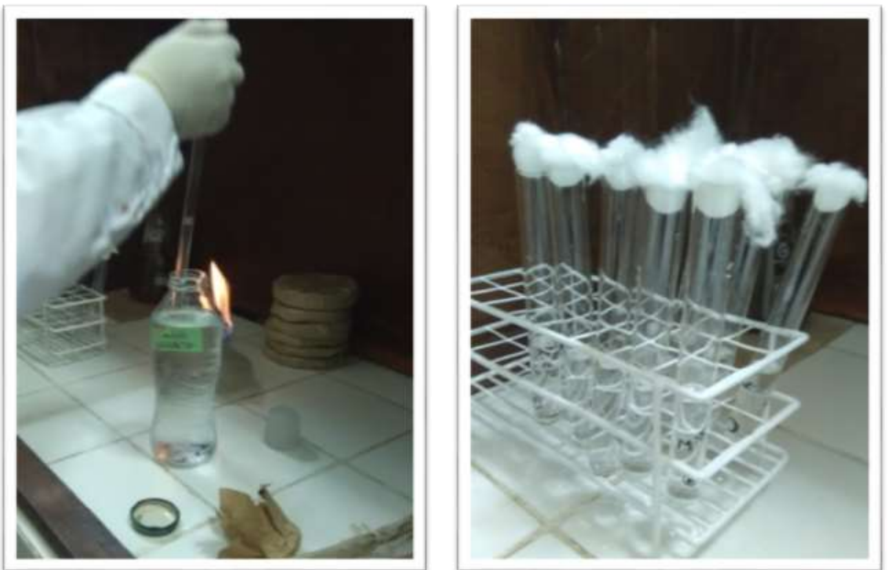
Figura 14: Diluciones en tubos de ensayo 9 ml. de agua de mar estéril y 1 ml. de la muestra (de 10^{-1} a 10^{-5} )
