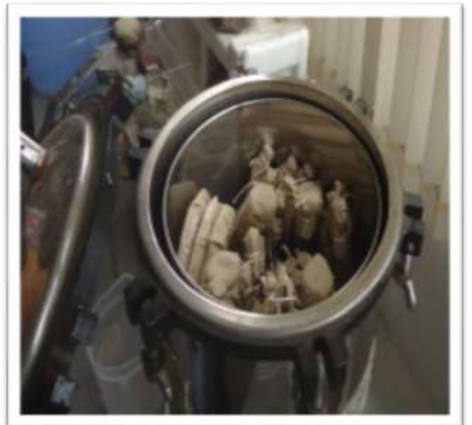
Figura 10: Envolvimiento de materiales con papel Graff para los respectivos análisis y puestos en el autoclave para ser esterilizados.
