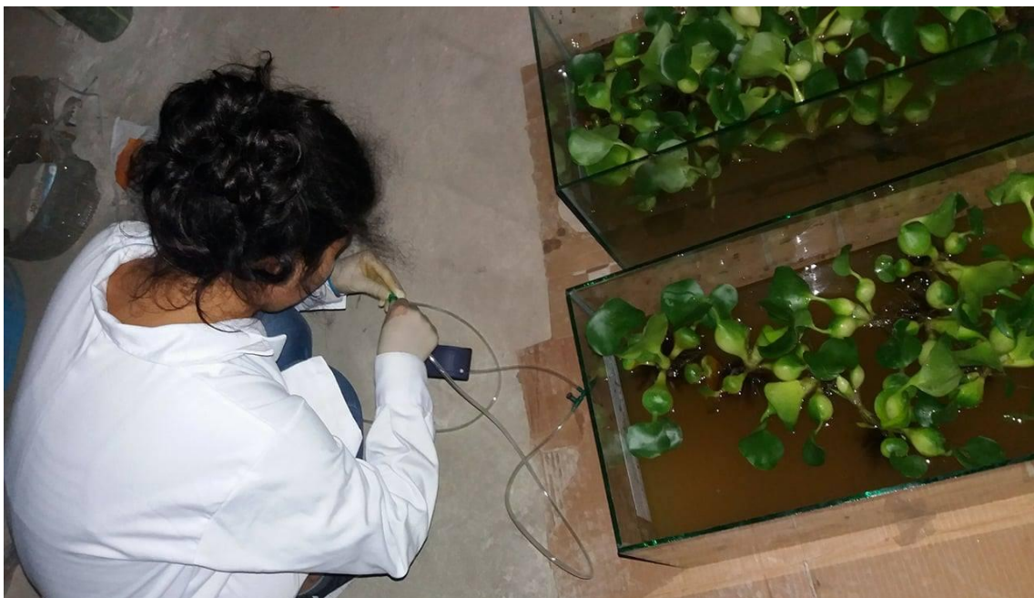
Figura 17: Instalación del sistema de aireación e iluminación para la Macrofitas Flotante Eichhornia crassipes .
